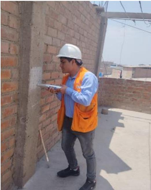
Ensayo del esclerometria
