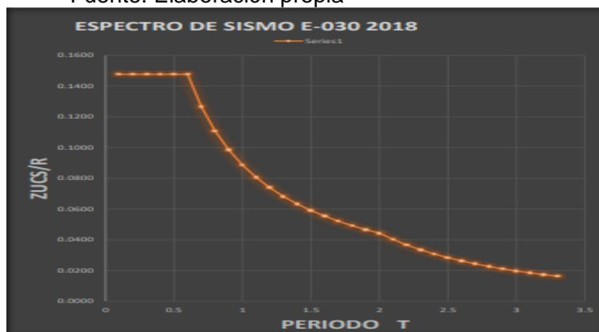
Figura N°44 :espectros de la estructura X
