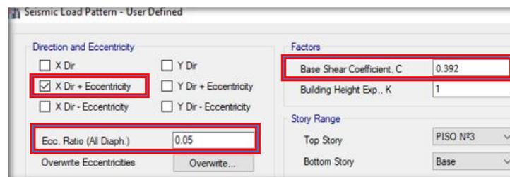
Figura N°42: Ingresando nuevos datos corregidos al programas etabs en eje x
