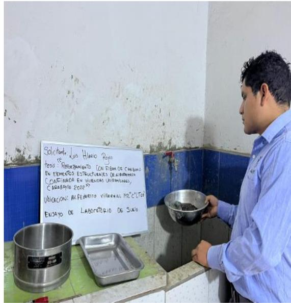
*Figura N°16: lavado de material*
