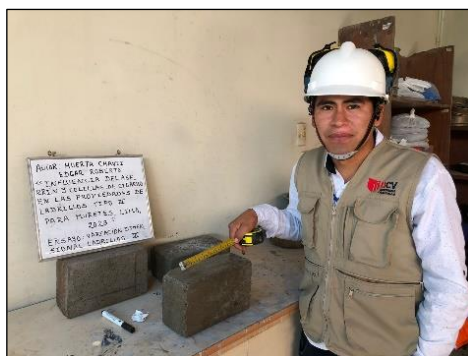
Variación dimensional de los ladrillos Fuente: Elaboración propia (2023)
