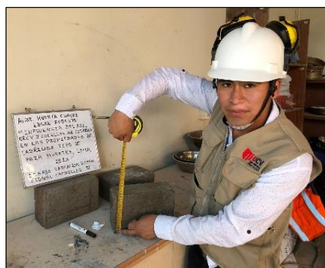
Figura 21. Realización de la variación dimensional
