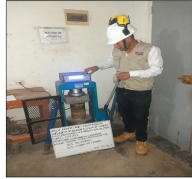
Ensayo de resistencia a la compresión axial, unidades de albañilería (14 días) Fuente: Elaboración propia (2023)
