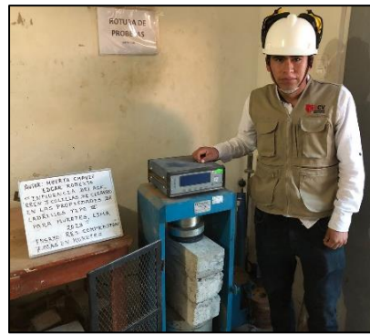
Ensayo de resistencia a la compresión axial en muretes (7 días) Fuente: Elaboración propia (2023)
