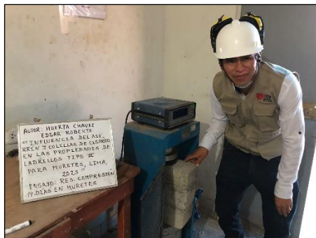
Ensayo de resistencia a la compresión axial en muretes (14 días) Fuente: Elaboración propia (2023)
