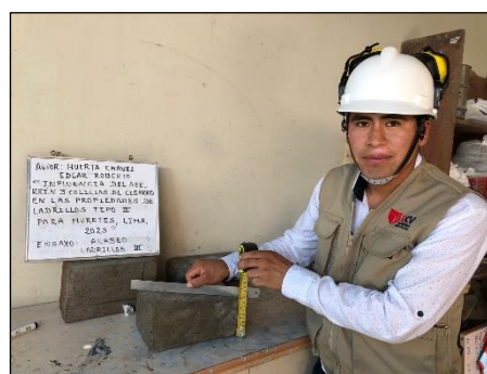
Figura 24. Prueba de alabeo respecto a convexidad
