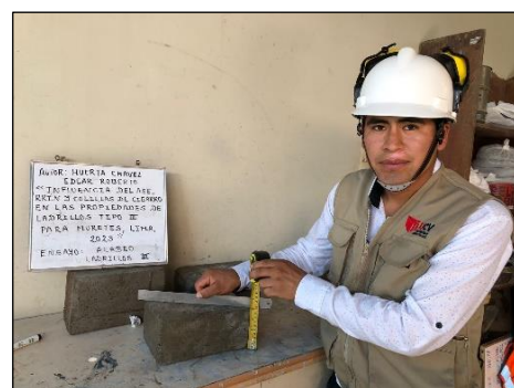
Alabeo de los ladrillos Fuente: Elaboración propia (2023)
