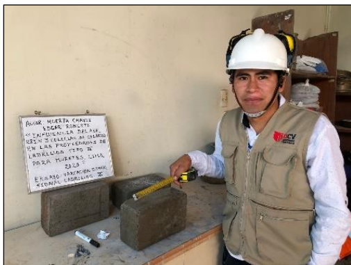
Figura 20. Medición de las dimensiones de los ladrillos
