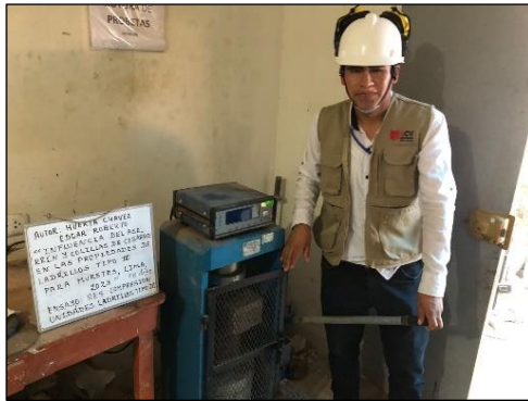
Ensayo de resistencia a la compresión axial en unidades de albañilería (28 días) Fuente: Elaboración propia (2023)
