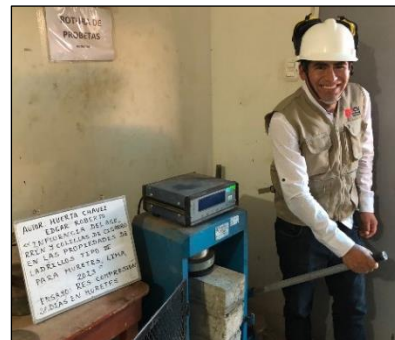
Ensayo de resistencia a la compresión axial en muretes (28 días) Fuente: Elaboración propia (2023)
