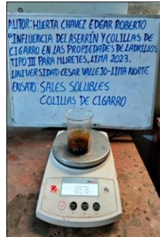
Ensayo de sales solubles (colillas) Fuente: Elaboración propia (2023)
