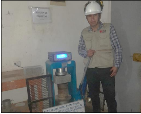
Ensayo de resistencia a la compresión axial en unidades de albañilería (7 días) Fuente: Elaboración propia (2023)
