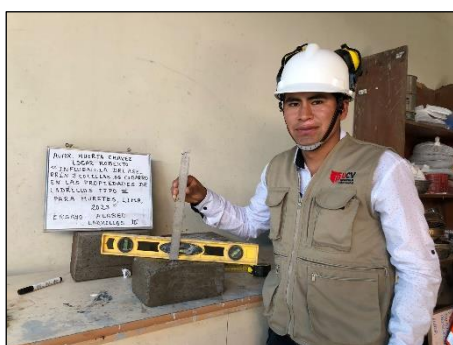
Figura 23. Prueba de alabeo respecto a concavidad
