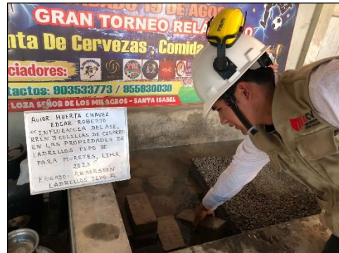
Figura 27. Ensayo de absorción de los ladrillos tipo III
