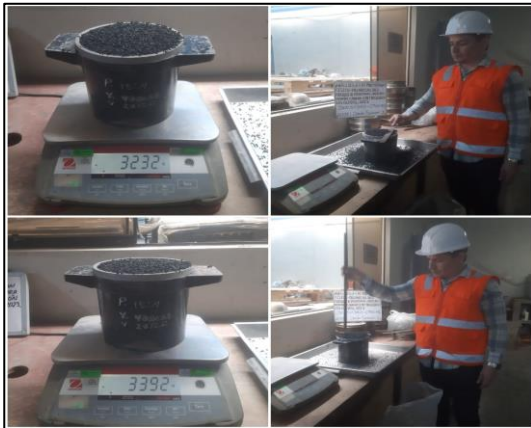
Figura 17. Densidad del caucho suelto y compactado más molde Fuente: Elaboración propia (2023)
