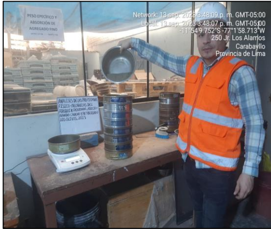
Figura 11. Granulometría del agregado fino (Tamiz) Fuente: Elaboración propia (2023)
