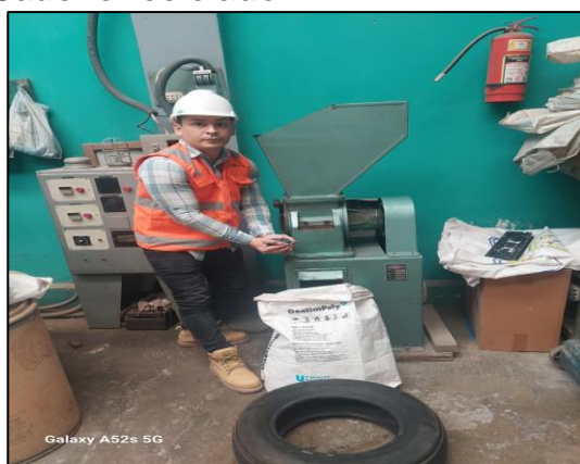
Figura 7. Trituración del caucho Fuente: Elaboración propia (2023)
