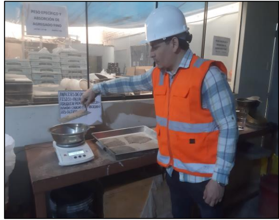
Figura 12. Granulometría del agregado fino cuarteo Fuente: Elaboración propia (2023)
