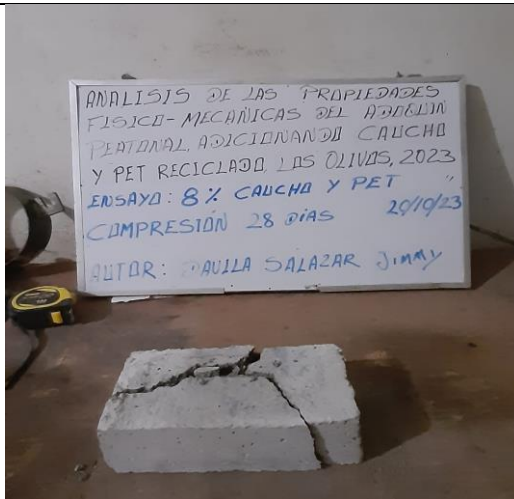
Muestra del adoquín compactado
