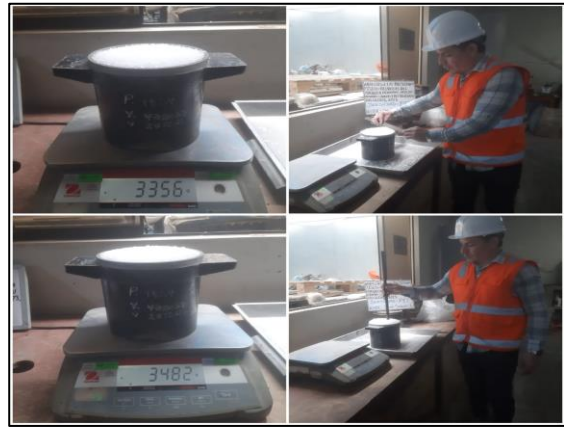
Figura 18. Densidad del PET suelto y compactado más molde Fuente: Elaboración propia (2023)
