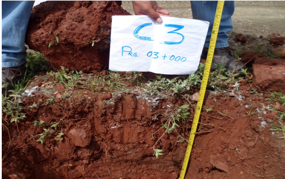
FOTOGRAFÍA N° 26: Calicatas para el estudio de mecánica de suelos.
