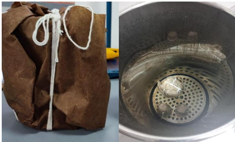
*Figura 15. Esterilización en autoclave.*
