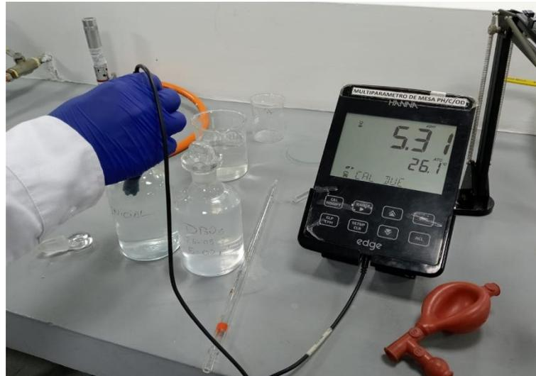
*Figura 5. Medición de Oxígeno Disuelto.*
