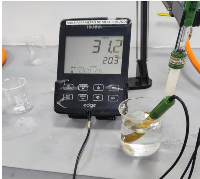
*Figura 6. Medición de conductividad eléctrica.*
