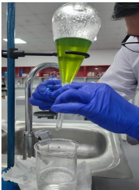
*Figura 10. Drenado de la fase líquida.*
