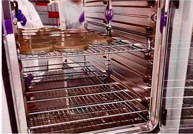
*Figura 16. Incubación de las placas Petri.*
