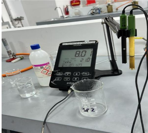
*Figura 4. Medición de Ph.*
