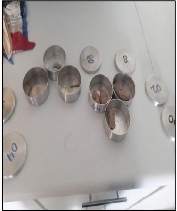
**Foto 35,36,37,38:** Realización del ensayo de limite plástico.
