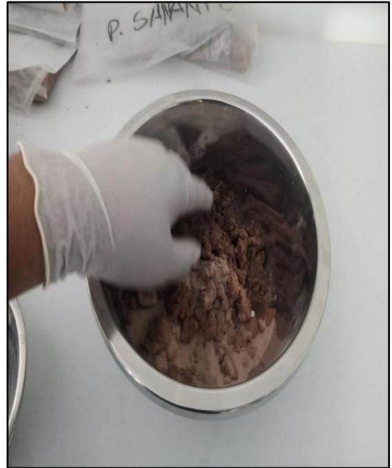
**Foto 23,24,25,26:** Preparación de la muestra para el ensayo de limite líquido y limite plástico.
