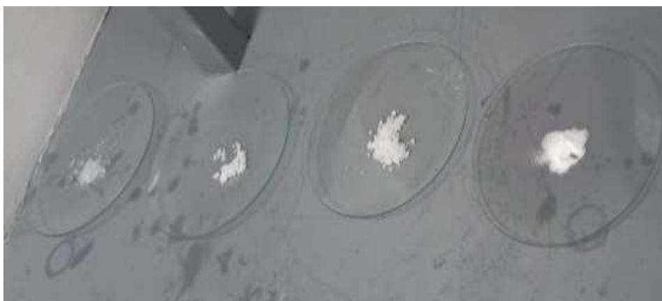
Los reactivos se pesaron utilizando una balanza analítica (OHAUS): fosfato de mono potásico (0.43 g), fosfato dipotásico (1.08 g), fosfato disódico di hidratado (3.61 g), cloruro de amonio (0.85 g), mostrado en **Figura 8**. Luego se mezclaron en una fiola diluyéndose con agua destilada hasta los 50 mL.
