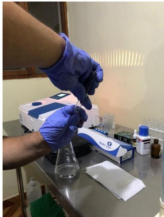
Espectrofotómetro Kynetel kv -1200 para las lecturas de absorbancias a 517 nm
