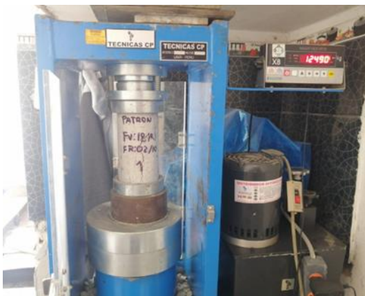
Figura 25: Rotura (14 días) Fuente: Dato propia
