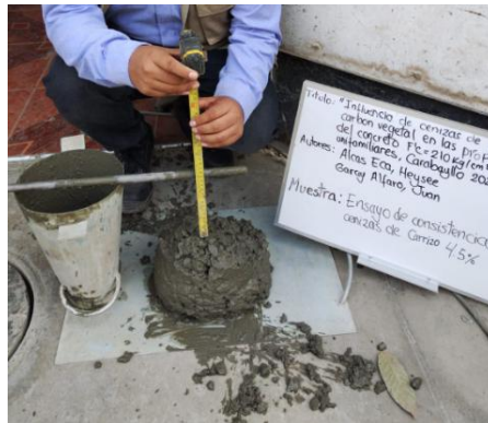
Ensayo de Slump
