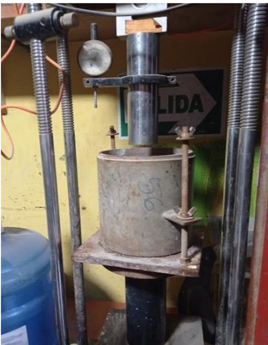
Foto 11: Penetración mediante prensa CBR
