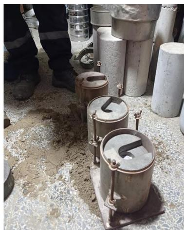
Figura 28. Moldes de ensayo CBR
