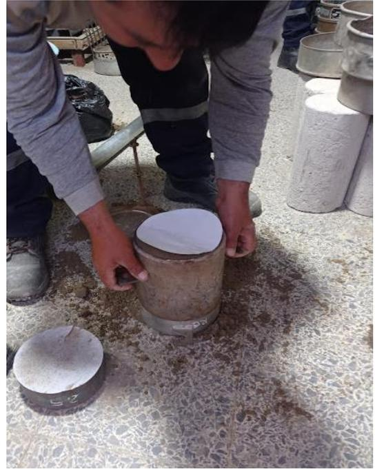
Foto 10: Terreno compactado en molde de CBR
