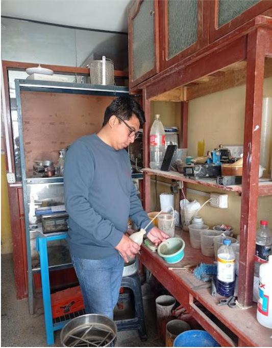
Foto 5: Mezcla de terreno y agua para ensayo Copa de Casagrande
