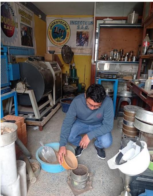
Foto 7: Colocación de terreno para Compactación
