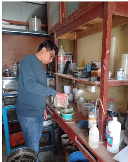
Foto 4: Muestra de calicata para ensayo Copa de Casagrande
