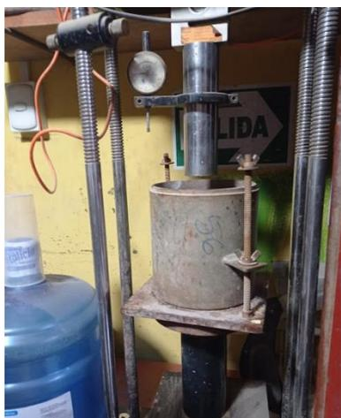
Figura 27. Penetración mediante prensa CBR
