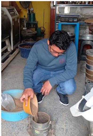
*Figura 23.* Colocación de muestra en el molde cilíndrico
