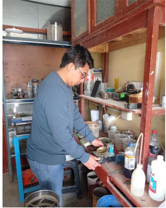
Foto 6: Ensayo Copa de Casagrande
