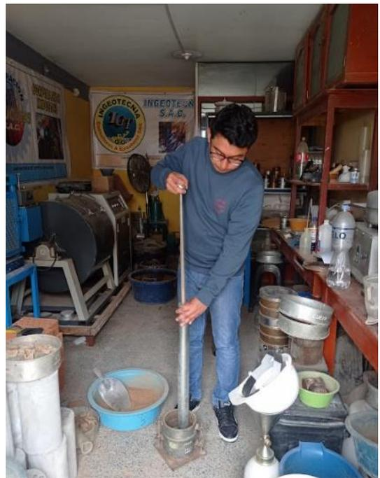
Foto 8: Golpes de Ensayo Proctor Modificado
