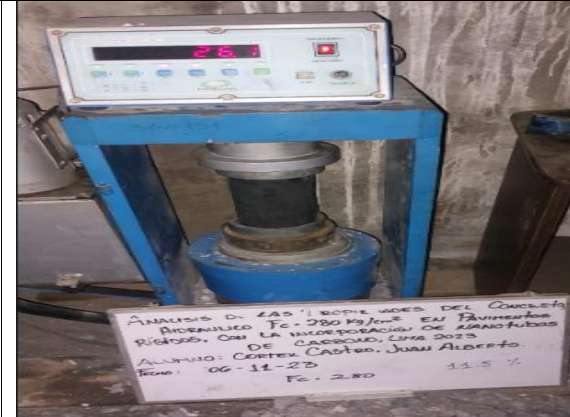
Ensayo Resistencia concreto
