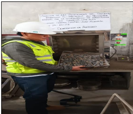
Figura 30. Colocando en la bandeja el agregado.
