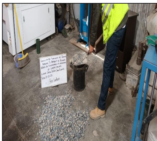
Figura 22. Peso Unitario, agregado grueso (Piedra Chancada)
