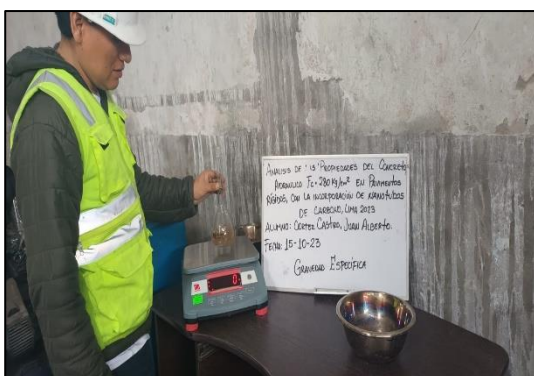
Figura 14. Peso específico, agregado fino (arena gruesa)
