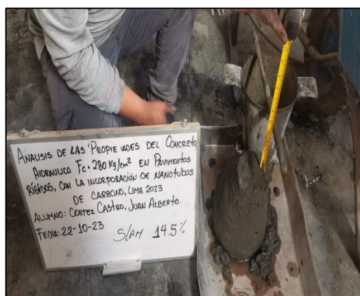
Figura 35. Slump según dosificación de nanotubo de carbono 14.5%
