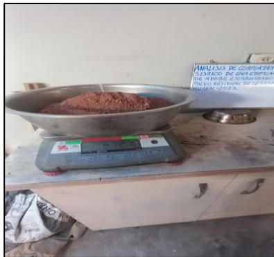
Pesaje del polvo residual de cerámica para estabilizar el adobe al 8%
