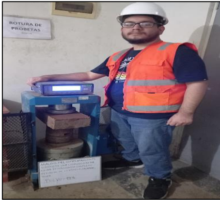
Ensayo a compresión de los adobes a 14 días de secado
