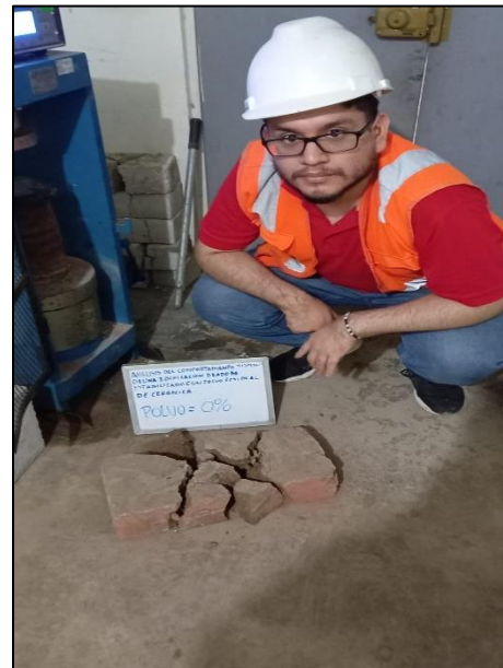
Figura 30. Culminación del ensayo de resistencia a la compresión en unidades de adobe
