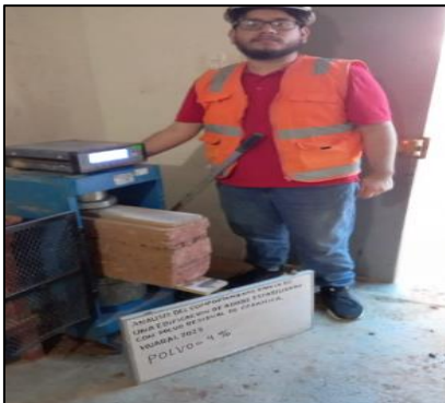
Ensayo de muretes con adobes estabilizados al 4%
