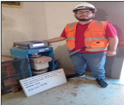
Ensayo a compresión de los adobes a 28 días de secado
