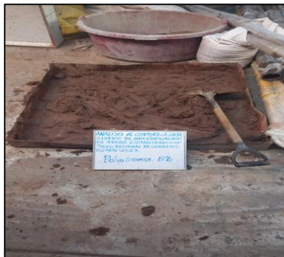
Mezcla de adobe ya incorporada con el 8% de polvo residual de cerámica
