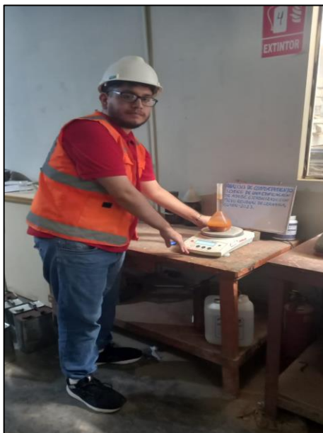
Figura 27. Preparación del polvo residual de cerámica para el ensayo de peso específico Fuente: Elaboración propia (2023)
