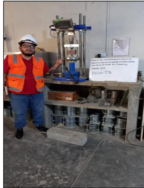
Figura 33. Culminación del ensayo de resistencia a carga puntual axial de adobe
