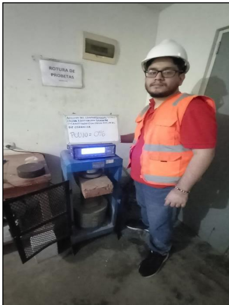
Figura 29. Preparación para el ensayo de resistencia a la compresión en unidades de adobe
