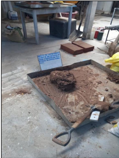
Figura 19. Proceso de mezclado del adobe patrón
