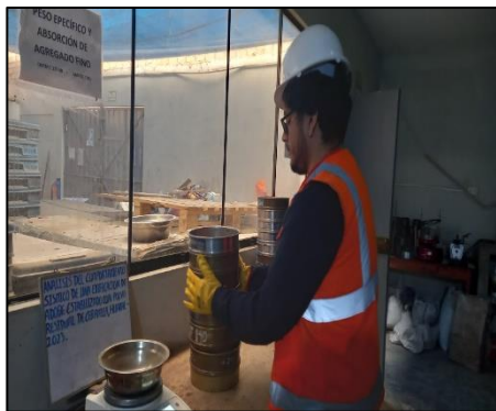
Análisis granulométrico del agregado fino del adobe
