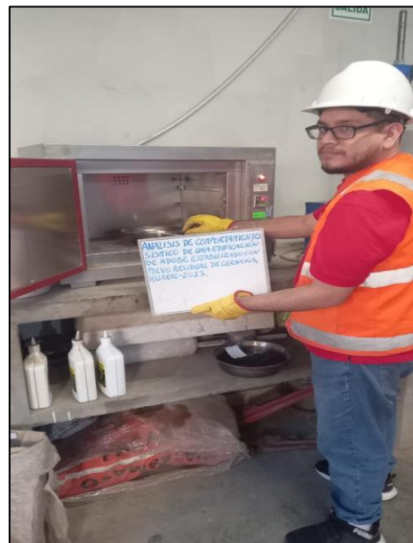
Figura 28. Ensayo de peso específico del polvo residual de cerámica Fuente: Elaboración propia (2023)
