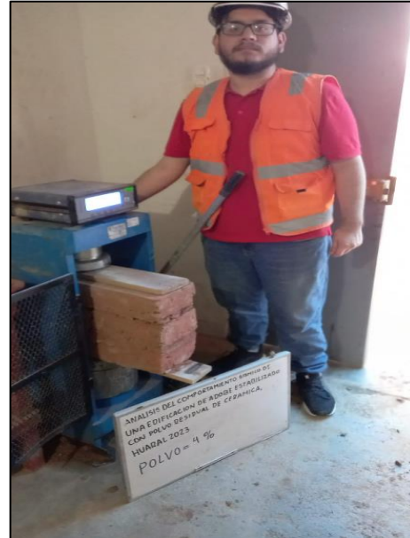
Figura 39. Culminación del ensayo de resistencia a la compresión axial en pilas de adobe
