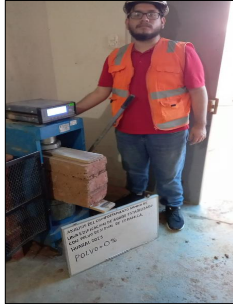
Figura 36. Culminación del ensayo de resistencia a la compresión en muretes de adobe
