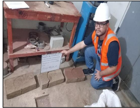
Adobes estabilizados al 4%,8% y 12% finalizados los ensayos a compresion
