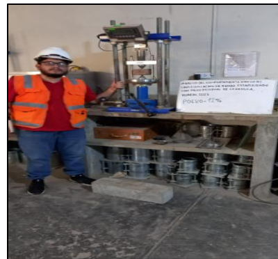
Ensayo de carga puntual axial con los ladrillos de adobe
