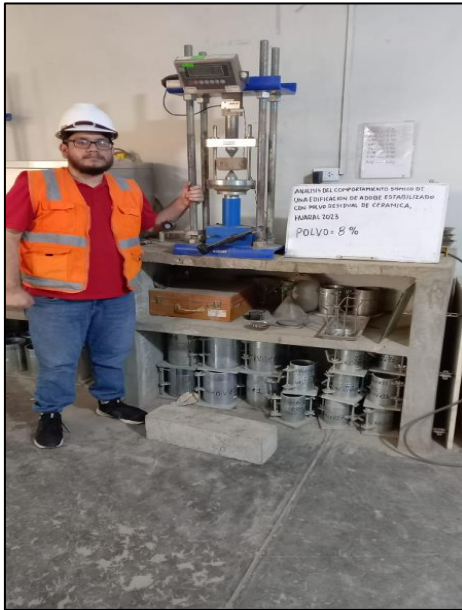
Figura 32. Preparación para el ensayo de resistencia a carga puntual axial de adobe
