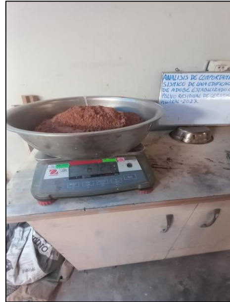
Figura 26. Obtención del polvo residual de cerámica Fuente: Elaboración propia (2023)
