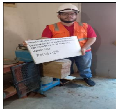
Ensayo de muretes con adobes estabilizados al 12%
