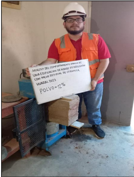
Figura 38. Preparación para el ensayo de resistencia a la compresión axial en pilas de adobe
