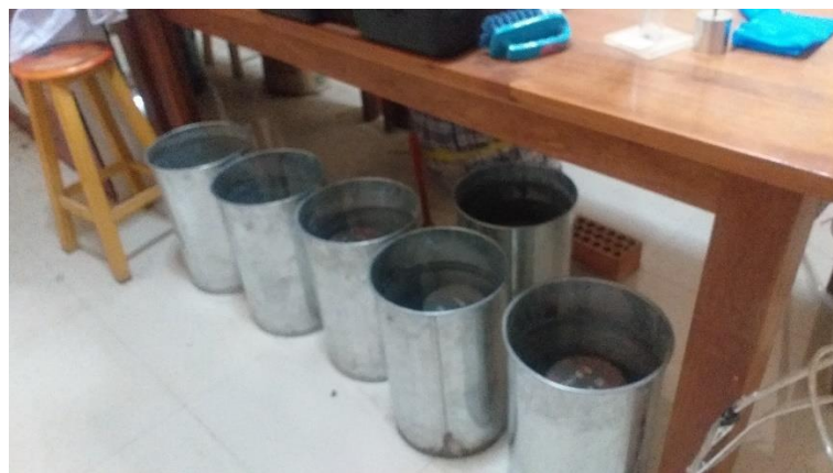
Foto 21. Curado de probeta.
