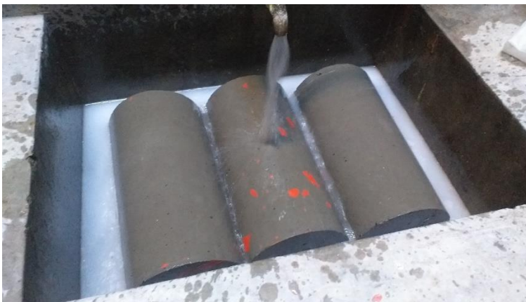
Foto 18. Curado de probeta.
