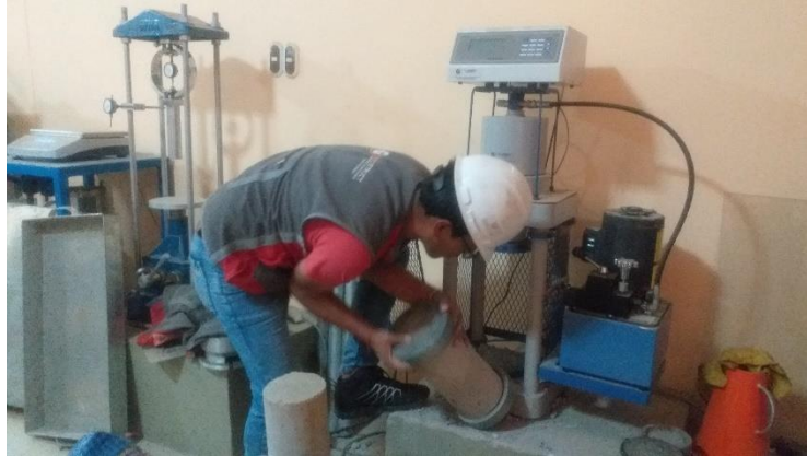
Foto 22. Colocación de probetas para ensayo a compresión.
