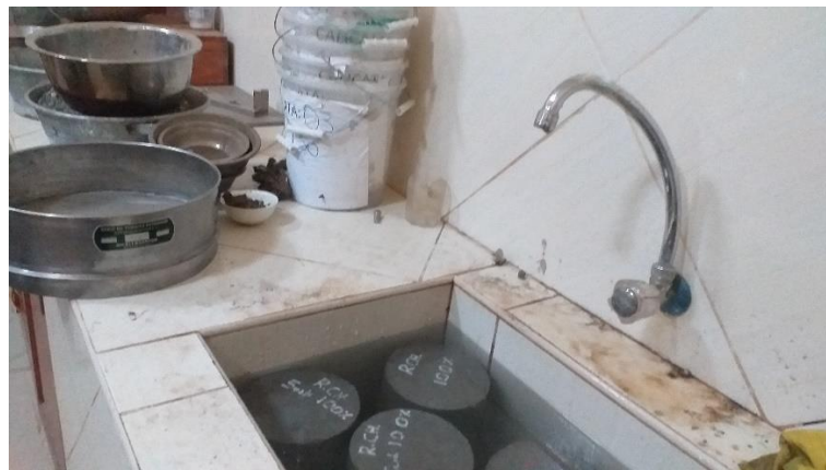
Foto 20. Curado de probeta.
