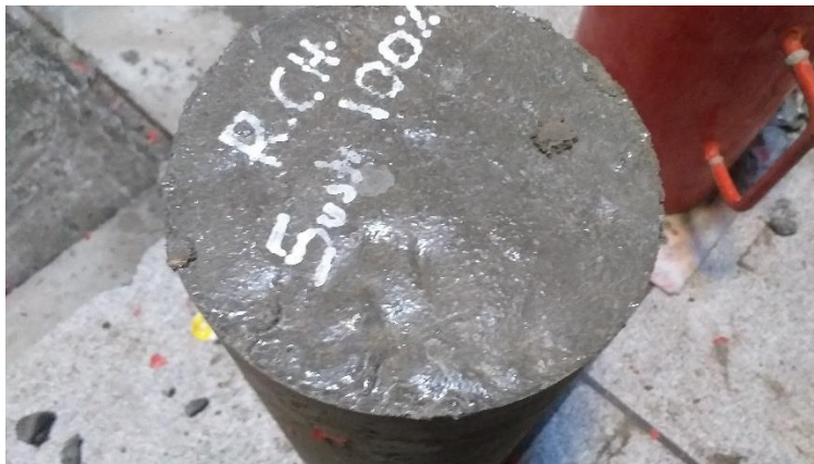
Foto 17. Probeta nombrada 100% de sustitución.
