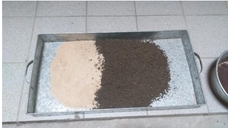
Foto 13. Combinación de arena blanca con arena gruesa.
