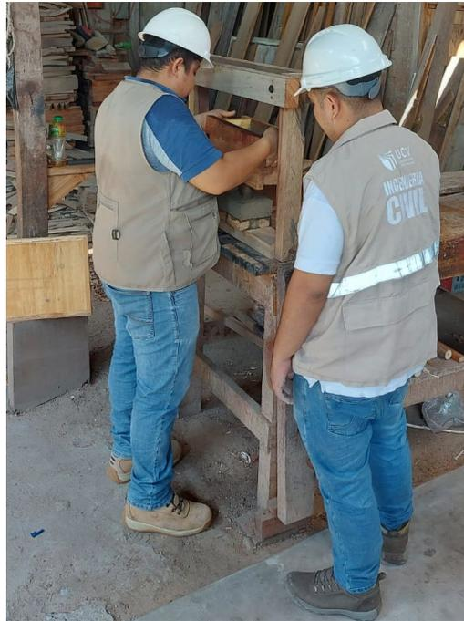
Foto 16. Proceso de desmolde de los ladrillos ecológicos.
