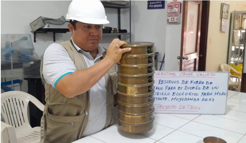
Foto 3. Muestra de arcilla para el pocos de análisis granulométrico.
