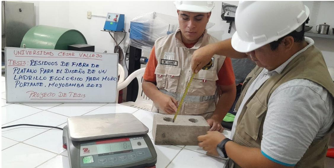
Foto 20. Pesado de los ladrillos ecológicos para el ensayo a la compresión.
