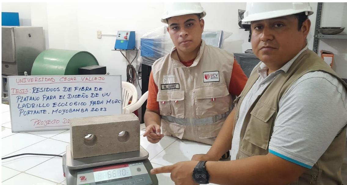
Foto 21. Pesado de los ladrillos ecológicos para el ensayo a la compresión.
