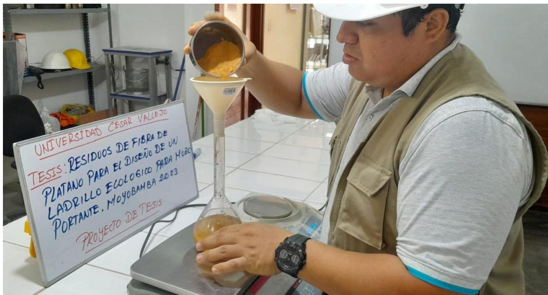
Foto 7. Proceso de la determinación del peso específico de la arcilla.
