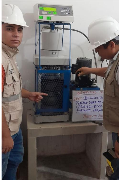
Foto 24. Término de la rotura de los ladrillo mediante prensa hidráulica.
