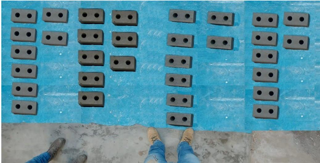
Foto 18. Medición de los ladrillos ecológicos para el ensayo a la compresión.
