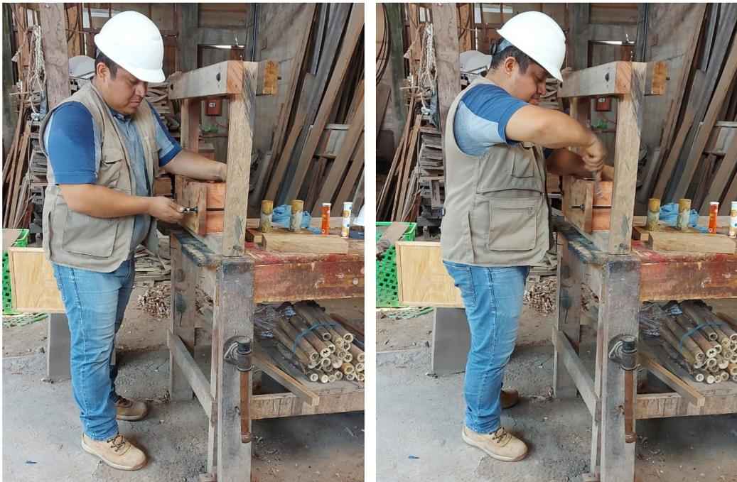
Foto 15. Proceso de prensado de los ladrillos.
