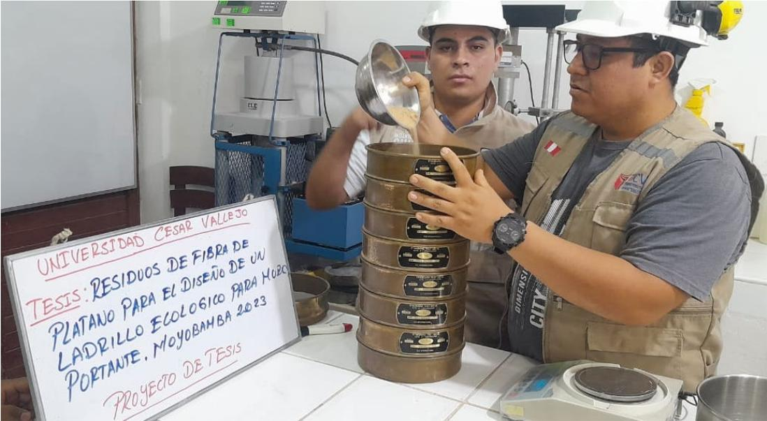
Foto 2. Proceso de tamizado en juego de mallas para análisis granulométrico
