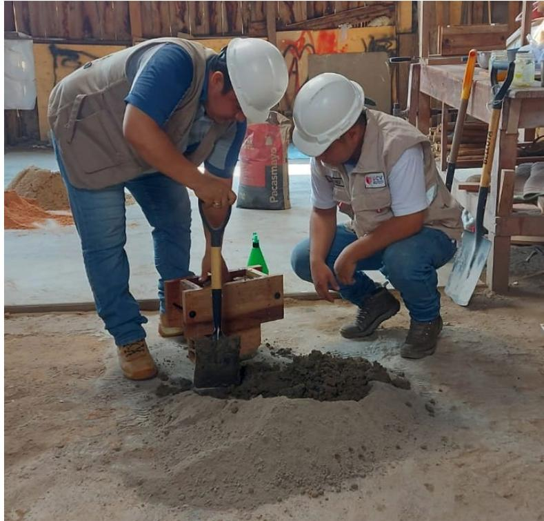
Foto 14. Proceso de prensado de los ladrillos.
