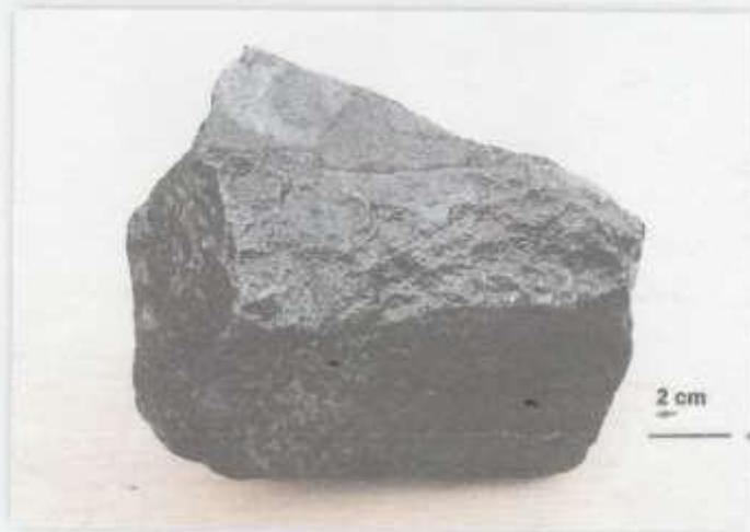
Foto 2.- Vista similar a la anterior, mostrando la textura afanítica de la roca y visible leve oxidación en las fracturas.
