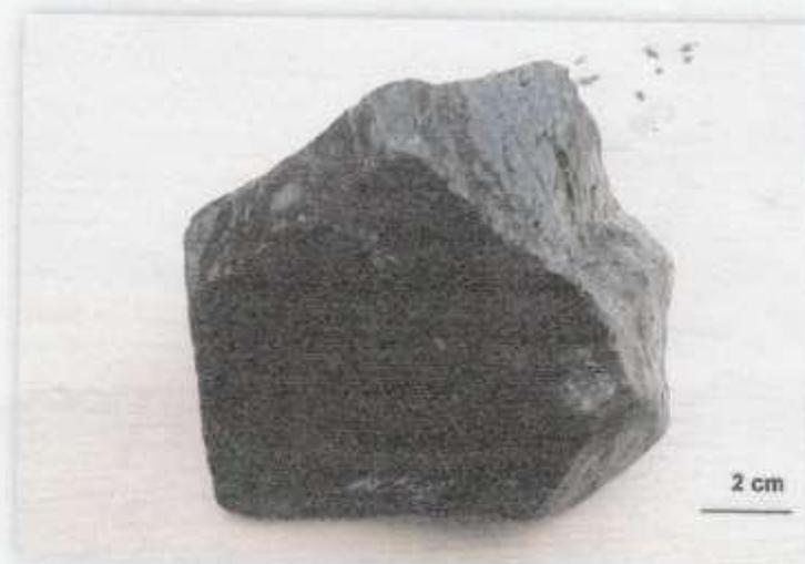
Foto 1.- Vista macroscópica de la muestra rocosa analizada. Se aprecia color oscuro y fracturamiento.
