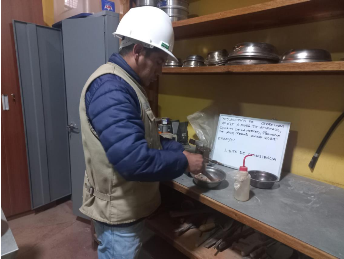
Fotografía 03: Preparación de Muestra para Limite de Consistencia.
