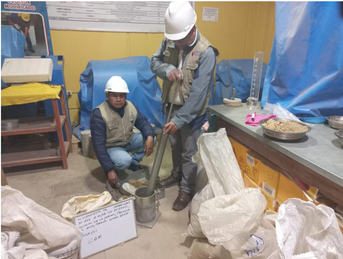
Fotografía 07: Preparación de Muestra para CBR.
