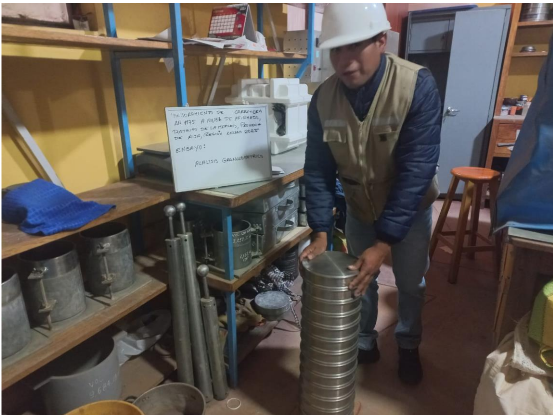
Fotografía 06: Preparación de Muestra para Análisis Granulométrico.
