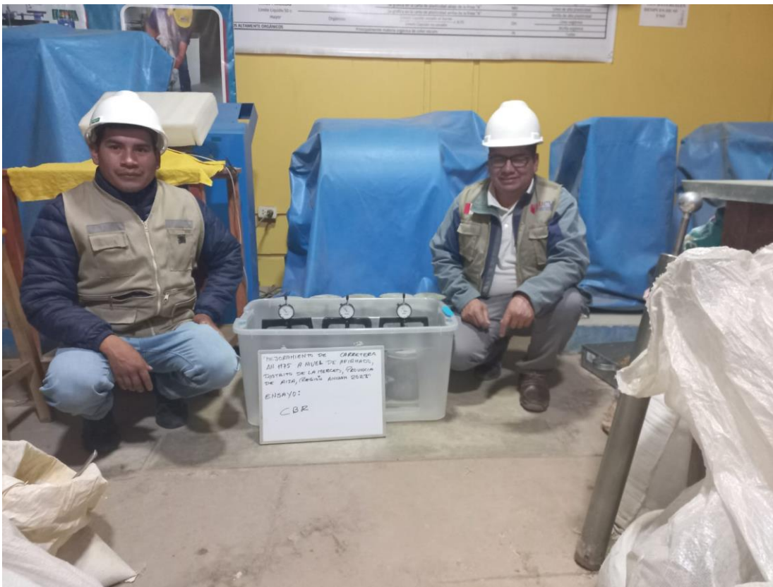
Fotografía 08: Preparación de Muestra para CBR.
