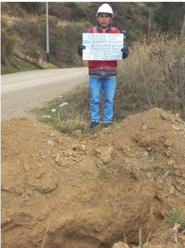
Fotografía 02: Recojo de Muestras de las Calicatas.
