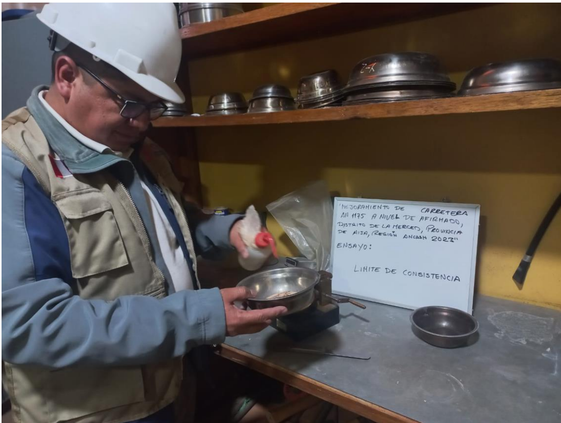
Fotografía 04: Preparación de Muestra para Limite de Consistencia.
