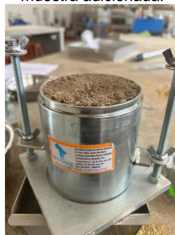
Figura 24. Proctor modificado de muestra adicionada.
