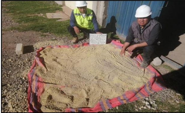
Figura 13. Secado de muestra de la sub rasante suelos finos extraídos de las calicatas
