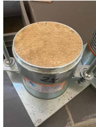
Figura 14. Proctor de 2% de humedad con muestra natural.
