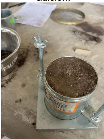
Figura 23. Proctor modificado de la adición.
