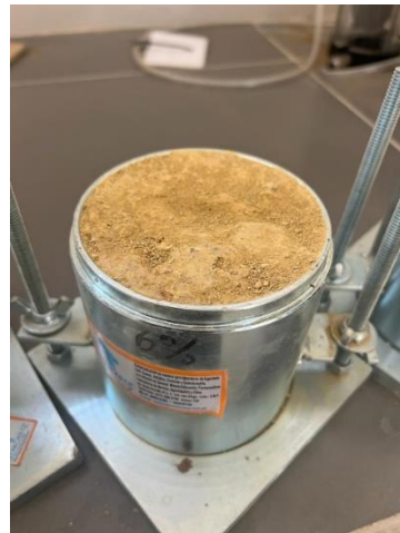
Figura 16. Proctor de 6% de humedad con muestra natural.
