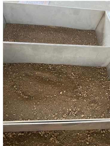
Figura 22. Mezcla homogénea de suelo con roca.
