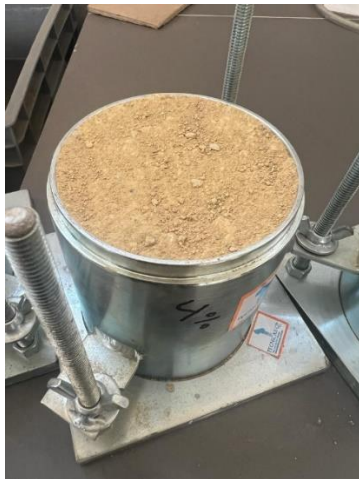
Figura 15. Proctor de 4% de humedad con muestra natural.
