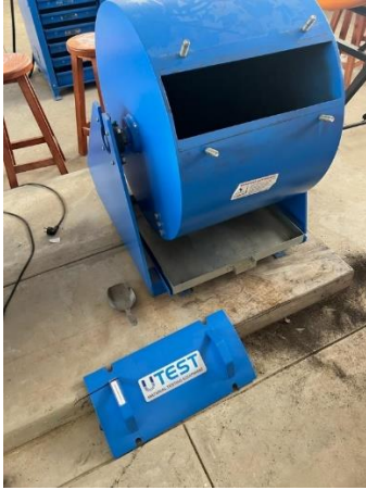
Figura 19. Máquina de abrasión de Los Ángeles.
