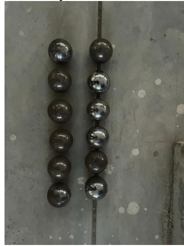
Figura 20. Cargas de acero, para ensayo de abrasión.
