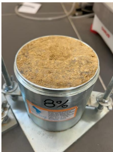
Figura 17. Proctor de 8% de humedad con muestra natural.
