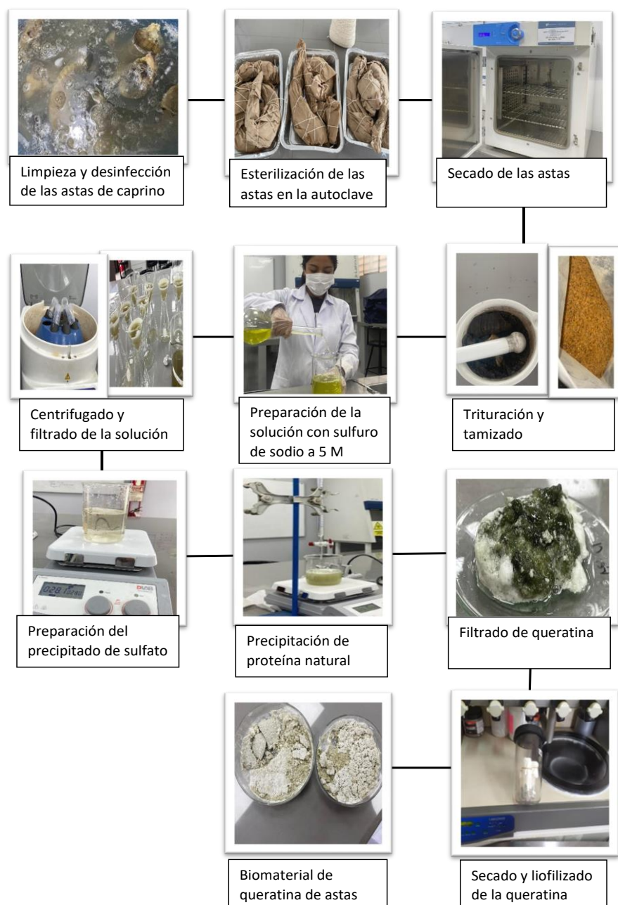
Figura 3. Procedimiento de la elaboración del biomaterial de queratina.
