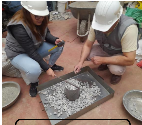
Nivelación para proceder a pesar el agregado grueso
