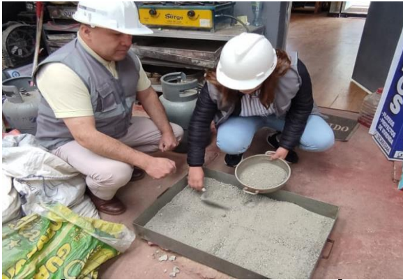
Cuarteo del agregado fino
