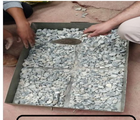
Cuarteo del agregado grueso
