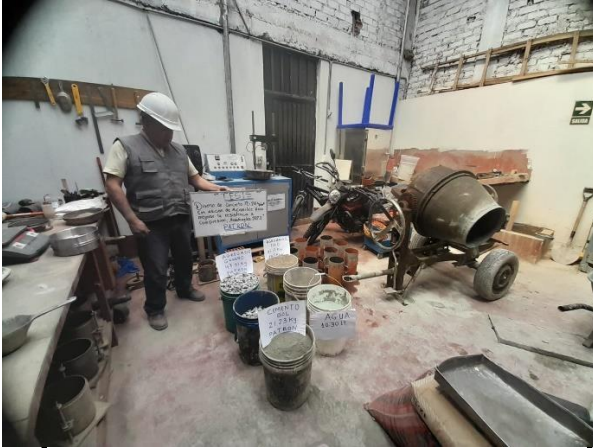
Muestra de los agregados para realizar la mezcla de concreto
