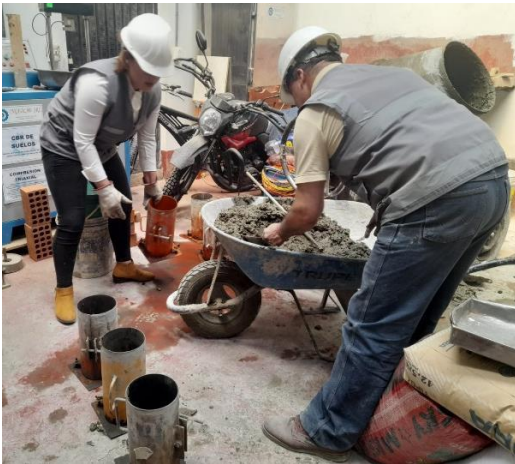
Vaciado a las probetas el concreto
