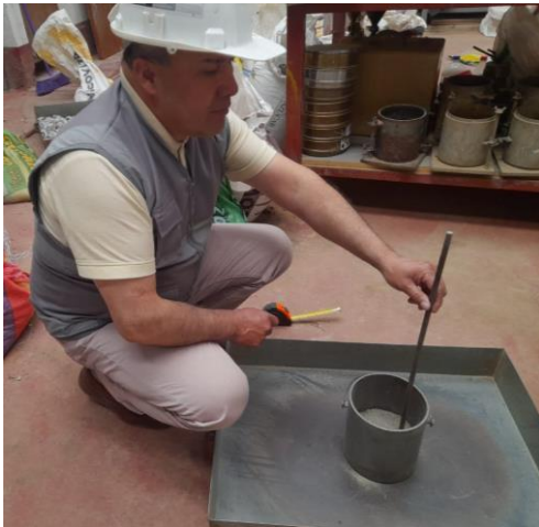
Varillado del agregado fino en tres capas de 25 golpes
