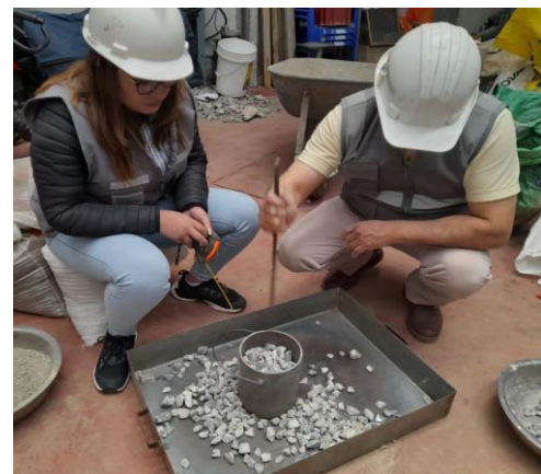
Varillado del agregado grueso en tres capas de 25 golpes
