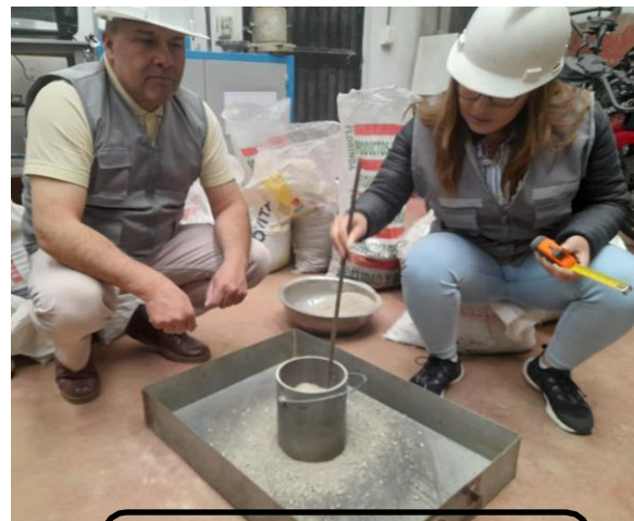
Varillado del agregado fino en tres capas de 25 golpes
