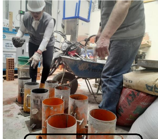
Vaciado a las probetas el concreto
