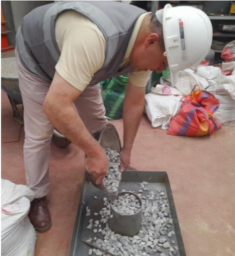
Varillado del agregado grueso en 3 capas de 25 golpes
