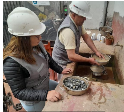
Lavado del material
