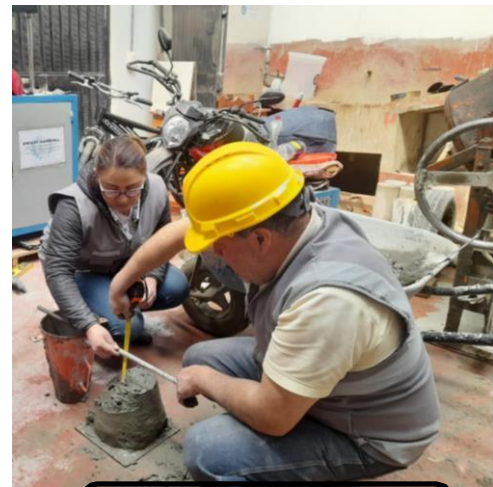
Medición del slump
