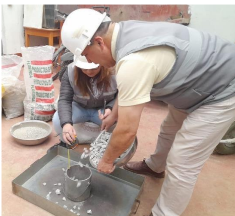
Caída de 15 cm, agregado grueso
