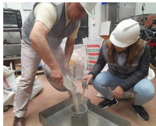
Caída de 15 cm, agregado fino
