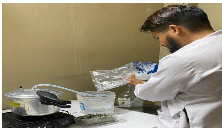
Figura 15. Montaje para extracción de la esencia de matico
