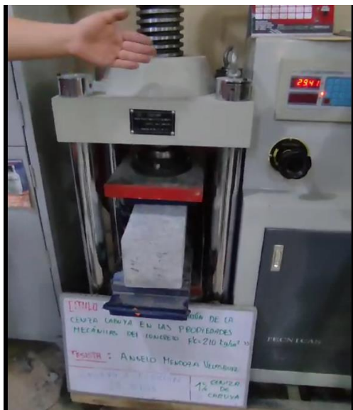
Fotografía 41. Lectura de Máquina en kN ( Ensayo a compresión a 28 días - 1% de ceniza de cabuya)
