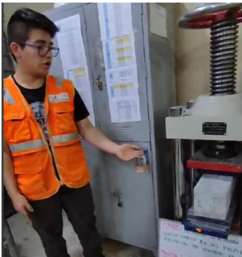
Fotografía 39. Ensayo de resistencia a flexión
