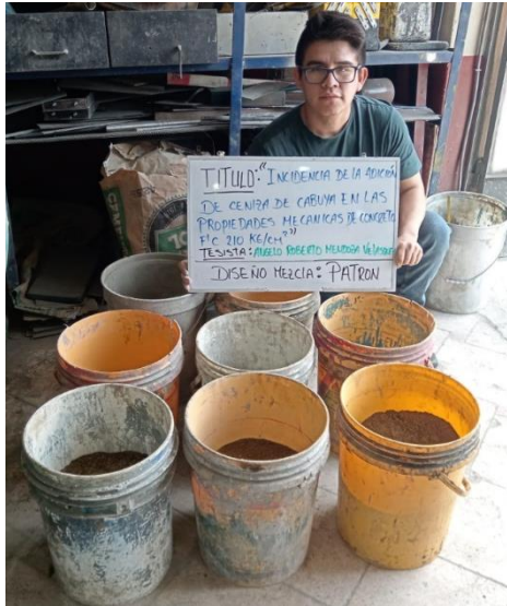
Fotografía 29. Dosificación de mezcla patrón ( 0.060\text{m}^3 )
