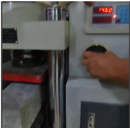
Fotografía 47. Lectura de Máquina en kN ( Ensayo a flexión a 7 días - 3% de ceniza de cabuya)
