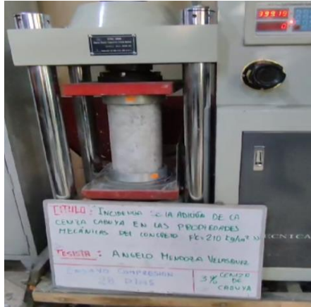
Fotografía 41. Lectura de Máquina en kN ( Ensayo a compresión a 28 días - 1% de ceniza de cabuya)
