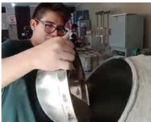
Fotografía 35. Preparación de mezcla con 1% de adición de ceniza de cabuya ( 0.060\text{m}^3 )
