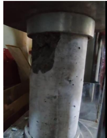
Fotografía 42 ( Ensayo a compresión a 28 días - 1% de ceniza de cabuya)
