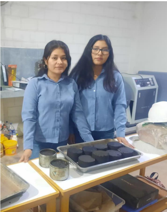
Probetas de Asfalto
