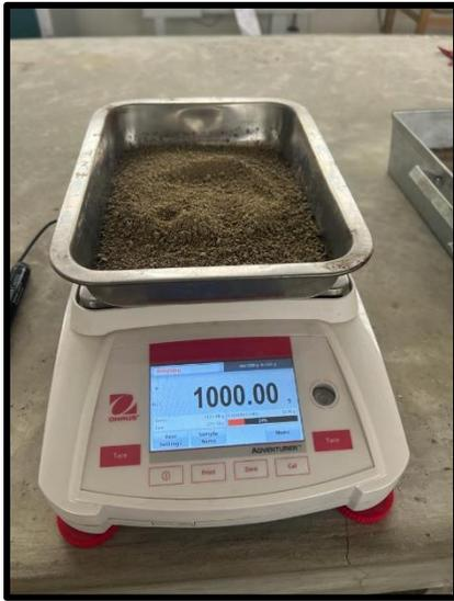
**Figura 22.** Muestra de agregado fino de Barranca para ensayo de % humedad.
