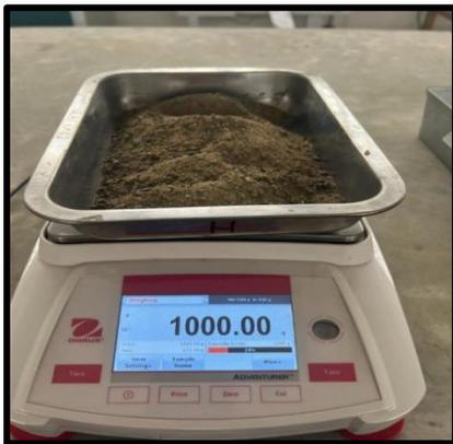
**Figura 23.** Muestra de agregado fino de Chancay para ensayo de % humedad.
