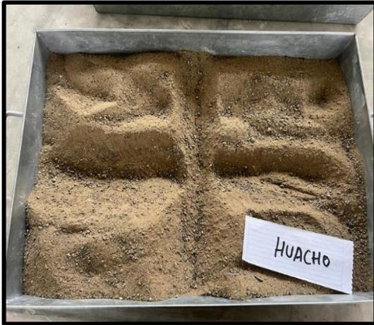
**Figura 10.** Cuarteo de la muestra de agregado fino de Barranca.
