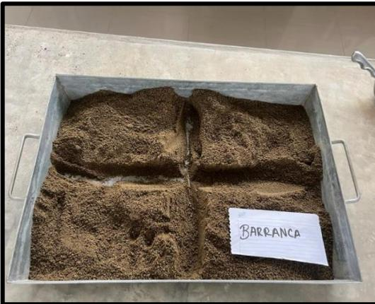
**Figura 11.** Cuarteo de la muestra de agregado fino de Chancay.
