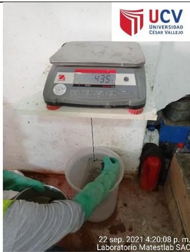
Figura 49. Peso del material saturado.
