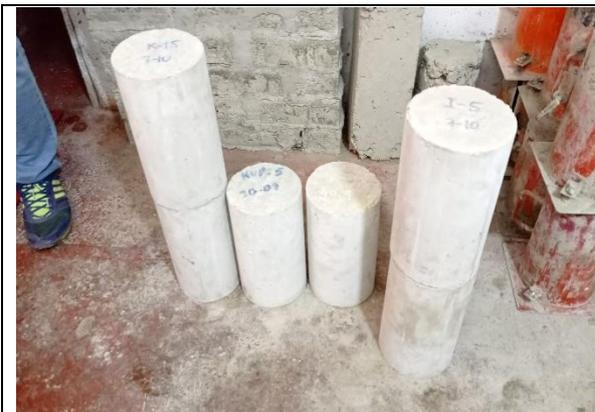
Figura 69. Probetas antes del ensayo.
