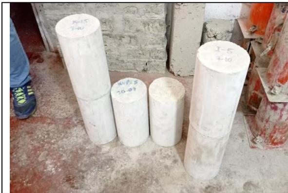
Figura 72. Probetas antes del ensayo.
