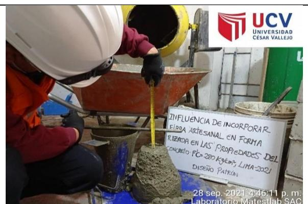
Figura 56. Prueba de Slump muestra.
