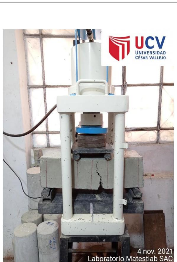
Figura 77. Ensayo a flexión.
