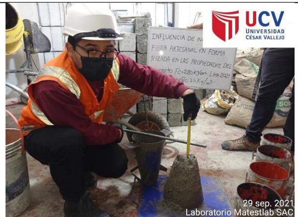
Figura 58. Prueba de Slump muestra M1.
