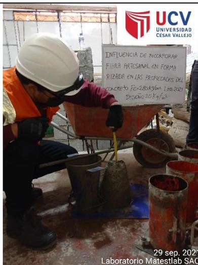
Figura 59. Prueba de Slump muestra M2.
