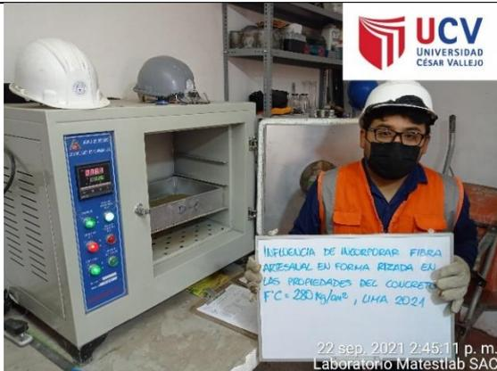
Figura 31. Secado, agregados a C°110.
