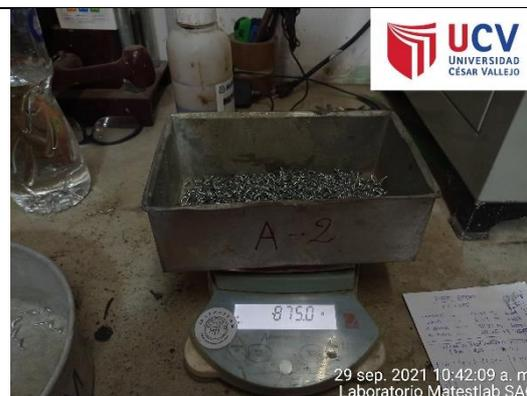
Figura 26. Peso de fibra para 25kg/m<sup>3</sup>.
