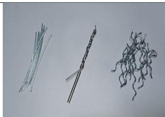
Figura 22. Fabricación de fibra.
