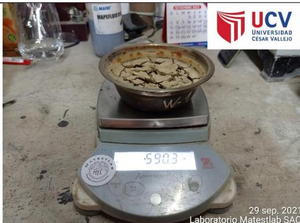
Figura 51. Peso material seco F.
