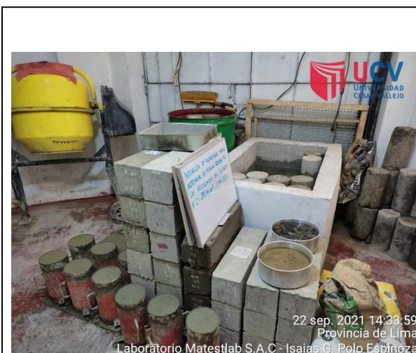
Figura 67. Curado de Probetas.
