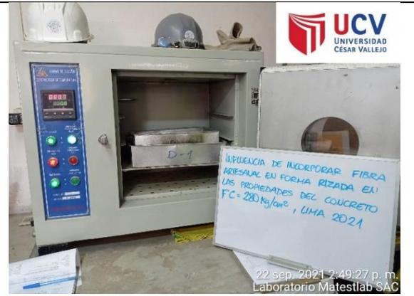
Figura 32. Secado de agregados.
