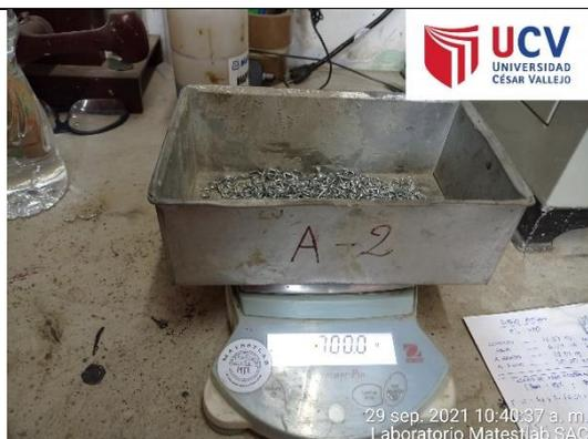
Figura 25. Peso de fibra para 20kg/m<sup>3</sup>.
