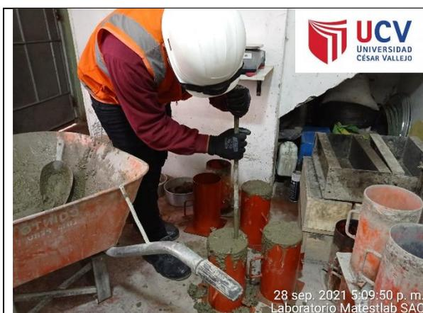
*Figura 63. Moldeo de las probetas Mo.*
