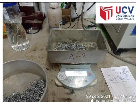
Figura 24. Peso de fibra para 15kg/m<sup>3</sup>.
