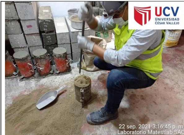
Figura 39. Apisonar los agregados.
