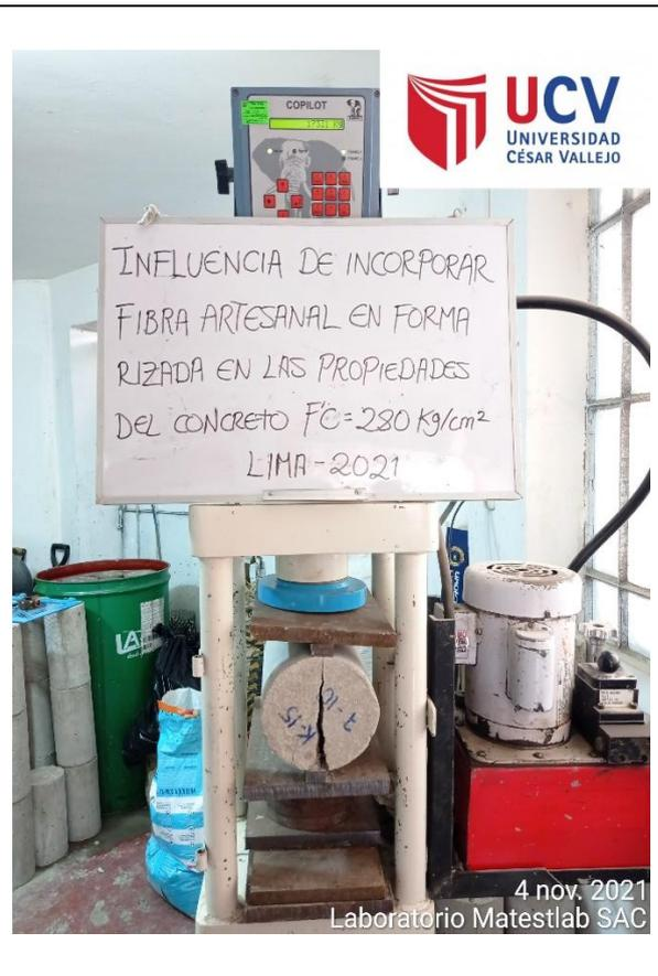
Figura 74. Ensayo a tracción.
