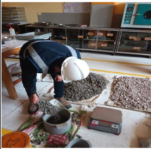
alstando para el peso seco suelto
