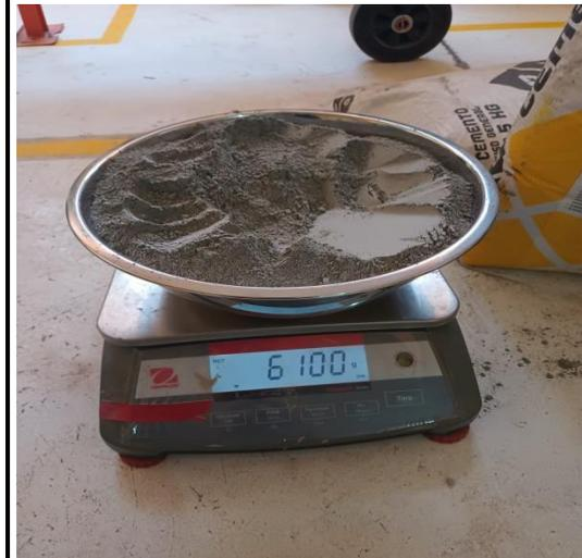
peso del cemento para diseño de mezcla
