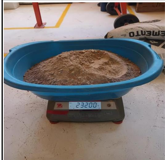
peso de la arena para diseño de mezcla
