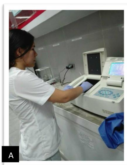
Figura 14. Lecturas de las absorbancias en el espectrofotómetro
