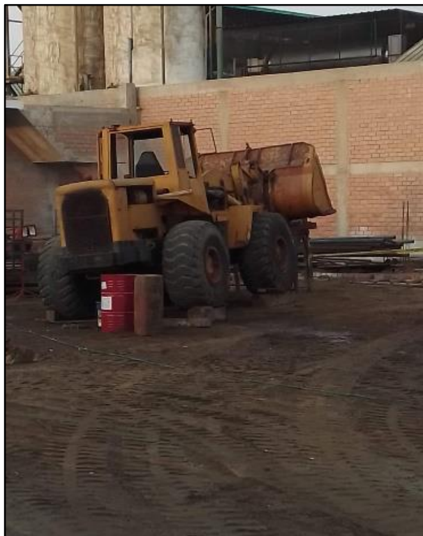
Cargador frontal inoperativo por pines averiados
