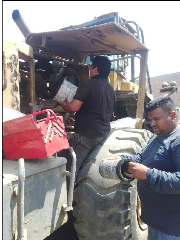
Mantenimiento autónomo de los operadores del cargador frontal
