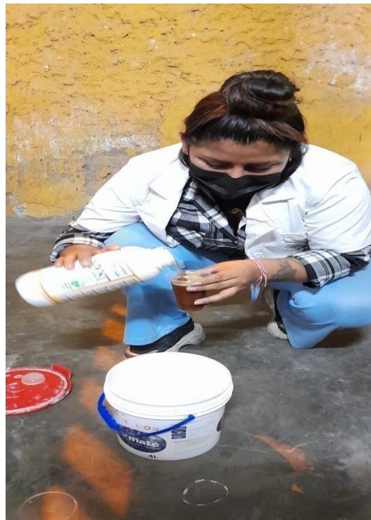
Fotografía 4: Preparación de la mezcla - Paso 4: Adición de la leche.
