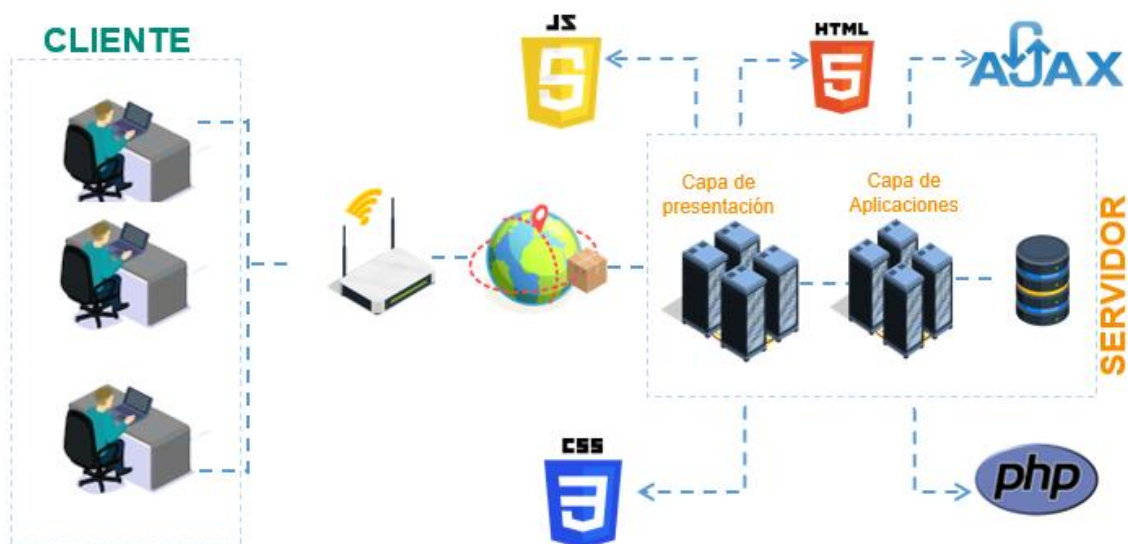
Figura 17: Arquitectura de sistema
