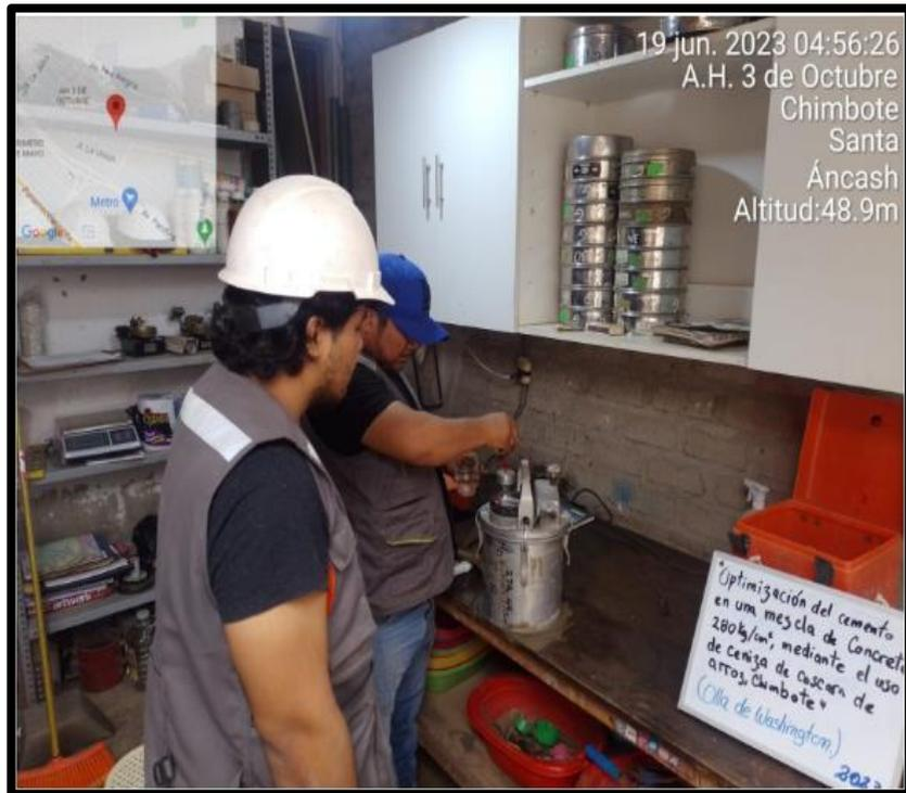
**Figura 35:** Nuestras llaves deben estar abiertas para introducir el agua, y pueda salir por la válvula.
