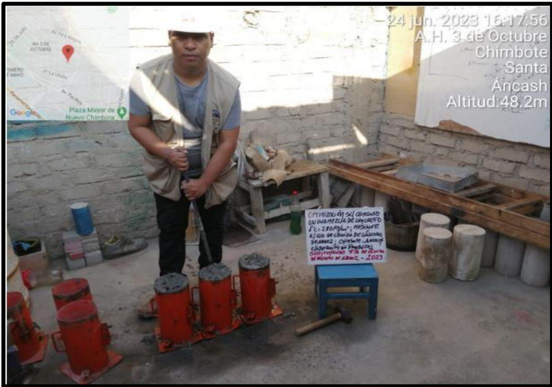
Figura 45: Chuseado de muestra patrón y muestras experimentales
