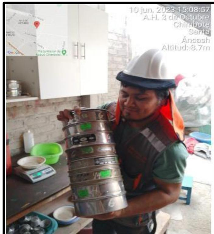
**Figura 18:** Pasando la muestra de agregados finos y grueso por las mallas
