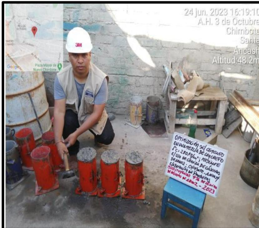
Imagen 41: Uso del martillo de goma para una mejor compactación de la probeta de diseño
