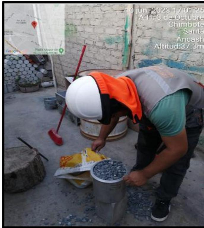
**Figura 30:** Enrasado del material excedente compactado de los áridos gruesos
