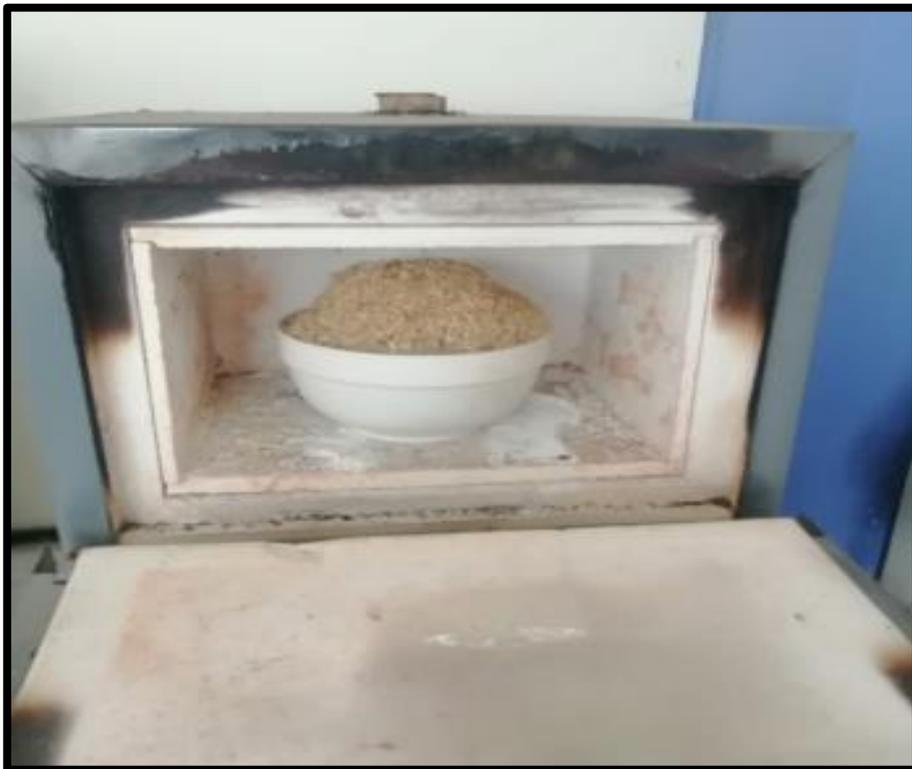
**Figura 9:** Muestra molida en la mufla
