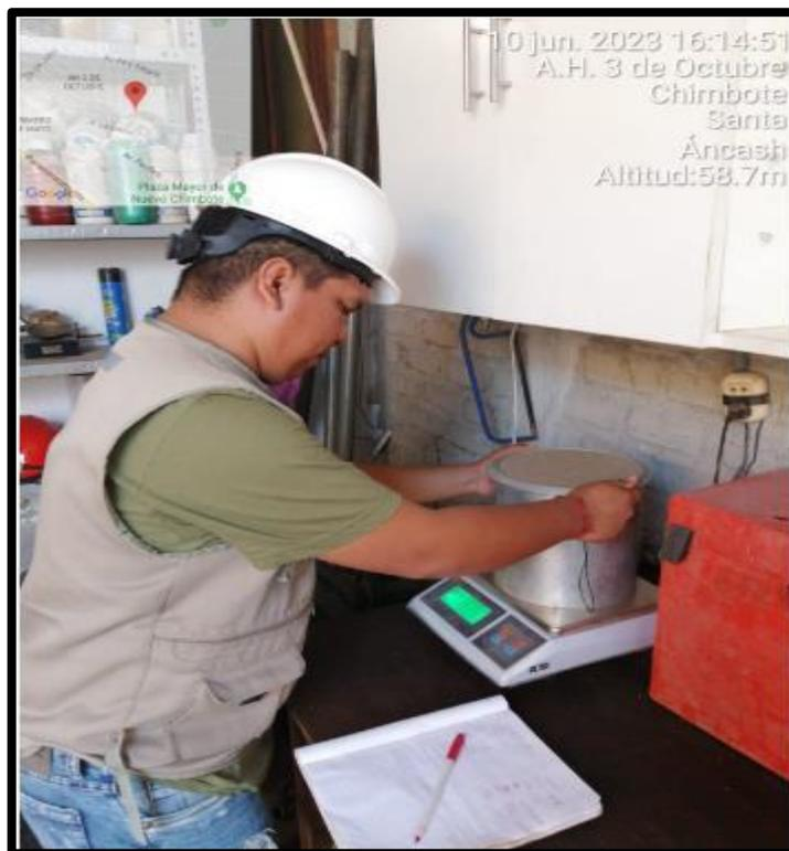
**Figura 25:** Peso obtenido del agregado fino compactado
