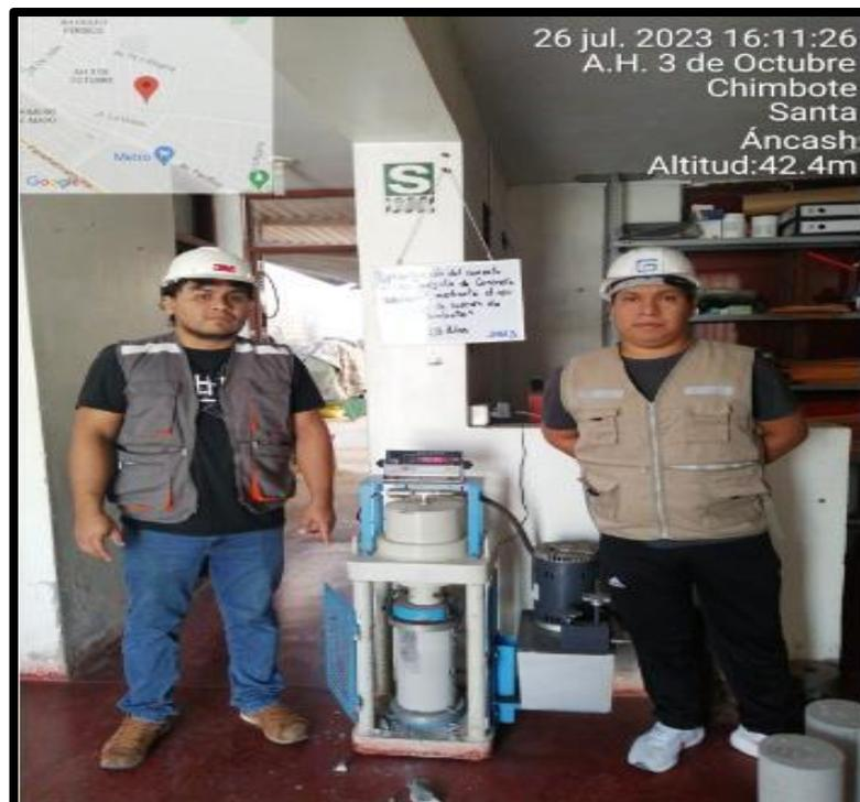
Imagen 44: Rotura de briquetas patrón y experimentales a los 28 días
