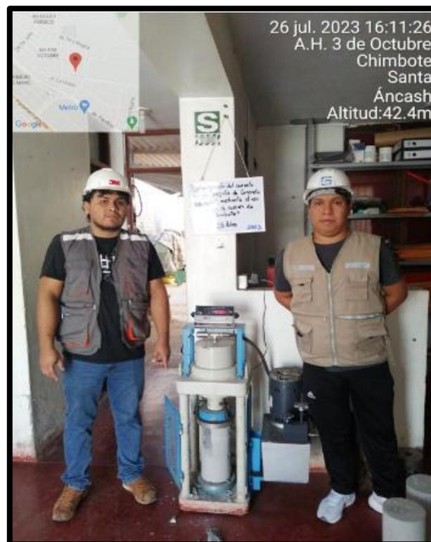
**Figura 54:** Ensayo de Resistencia a la Compresión con la incorporación de Ceniza de Cáscara de Arroz
