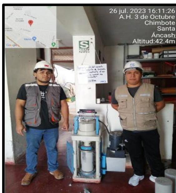
Figura 48: Rotura de briquetas patrón y experimentales a los 14 días
