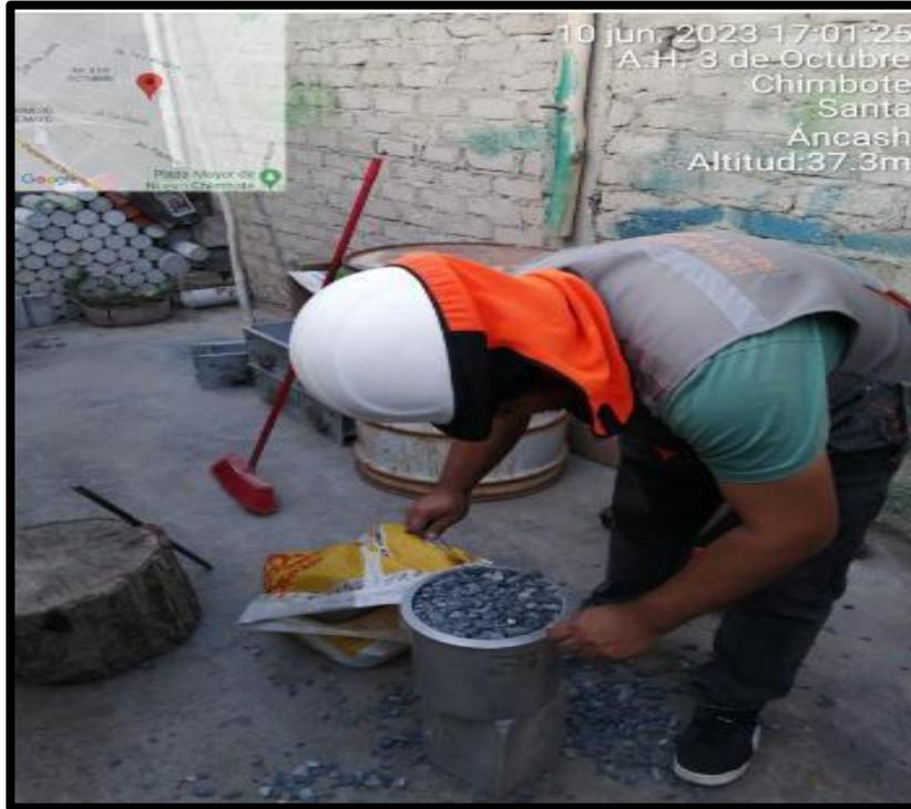
**Imagen 25:** Enrasado del material excedente compactado de la grava
