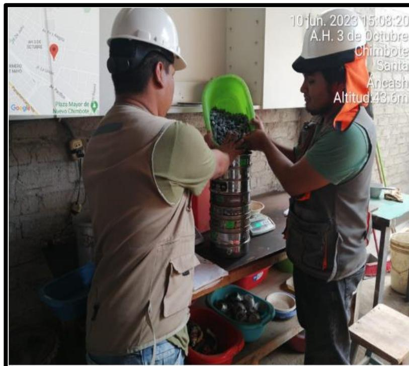
**Imagen 12:** Bachilleres De Paz Huaman Jerson Y. y Paredes Zelaya Percy W. pasando los agregados por los tamices.
