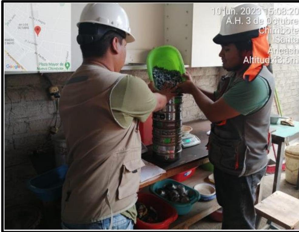
**Figura 17:** Colocación de los agregados por los tamices.
