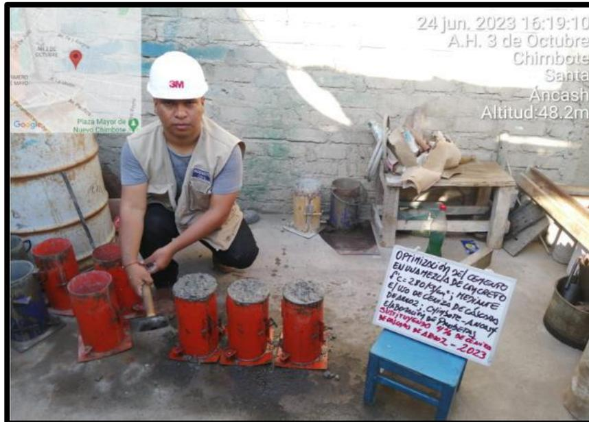
**Figura 53:** Probetas con incorporación (2%, 4%,6%) de Ceniza de Cáscara de Arroz
