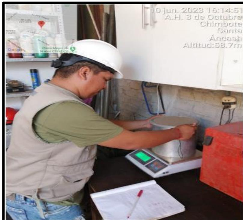
**Imagen 20:** Peso Volumétrico Compactado de la Muestra
