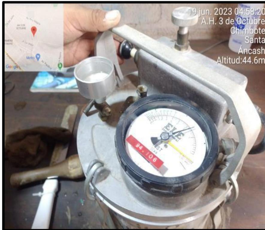
**Figura 37:** Verificación del contenido de aire
