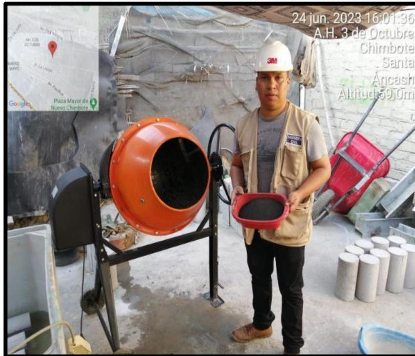
**Imagen 39:** Fabricación de mezcla con CENIZA DE CÁSCARA DE ARROZ al (2%,4% y 6%)
