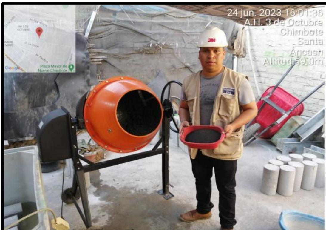
**Figura 44:** Fabricación de las mezclas experimentales al (2%,4% y 6%)
