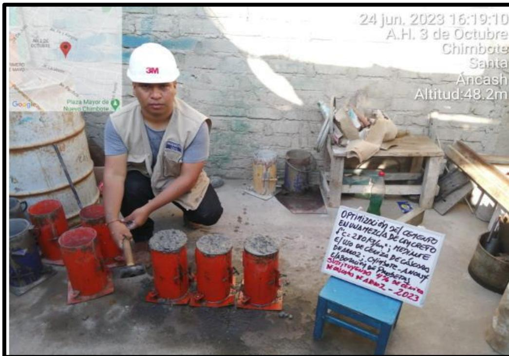
Figura 46: Uso del martillo de goma para una mejor compactación de la probeta de diseño
