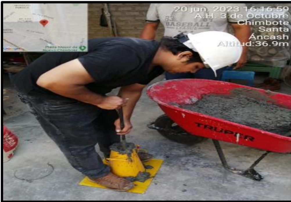
Figura 59: Cono de Abrams para realizar el Slump con la integración de 2%, 4% y 6% de Ceniza de Cáscara de Arroz
