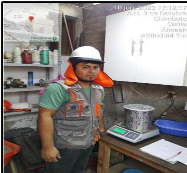
**Imagen 26:** Peso Volumétrico Compactado de la Grava
