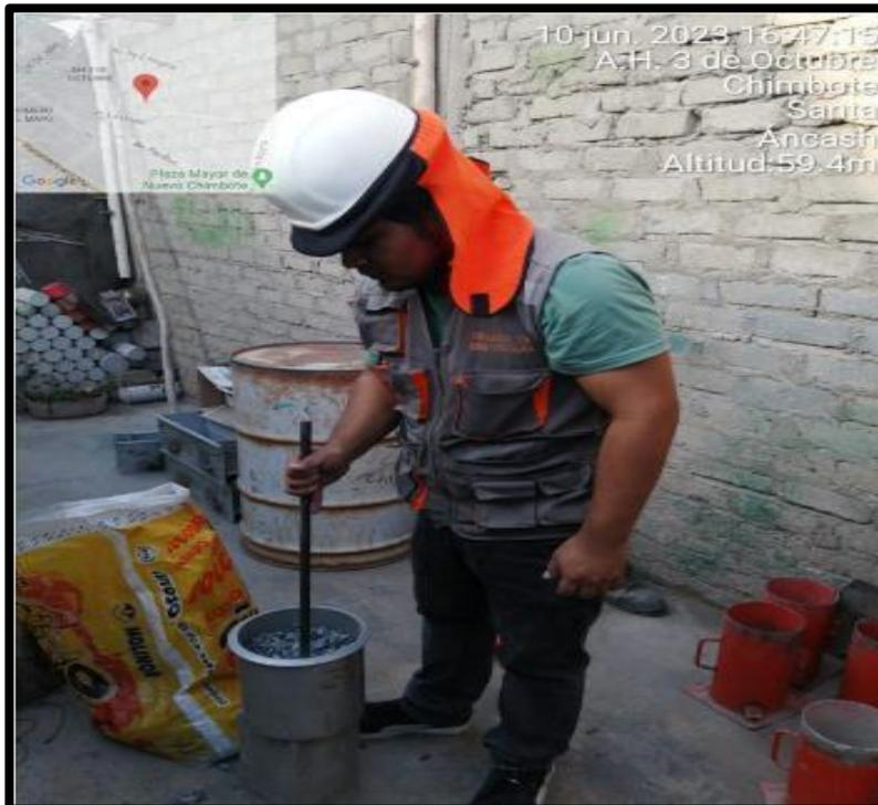
**Imagen 24:** Con la varilla se procede a realizar los 25 golpes por capa
