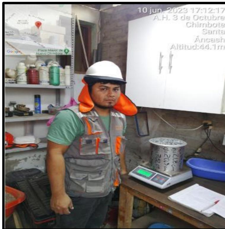
**Figura 31:** Peso Volumétrico Compactado de loa áridos gruesos
