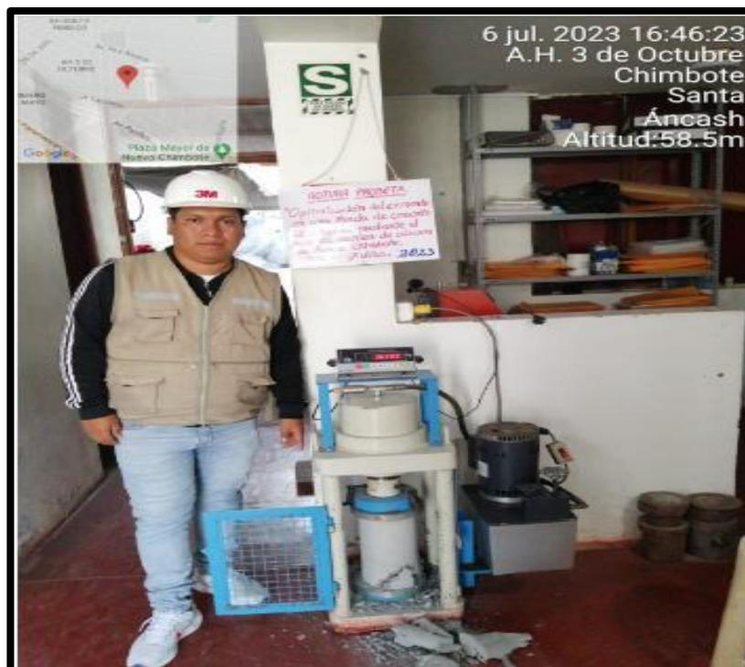
Imagen 42: Rotura de probetas patrón y experimentales a los 7 días
