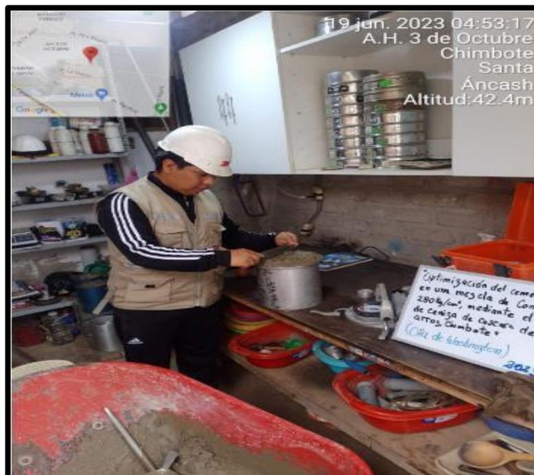
**Figura 56:** Ensayo ASTM C231 para encontrar la capacidad de aire de la mezcla patrón y experimentales con Ceniza de Cáscara de Arroz
