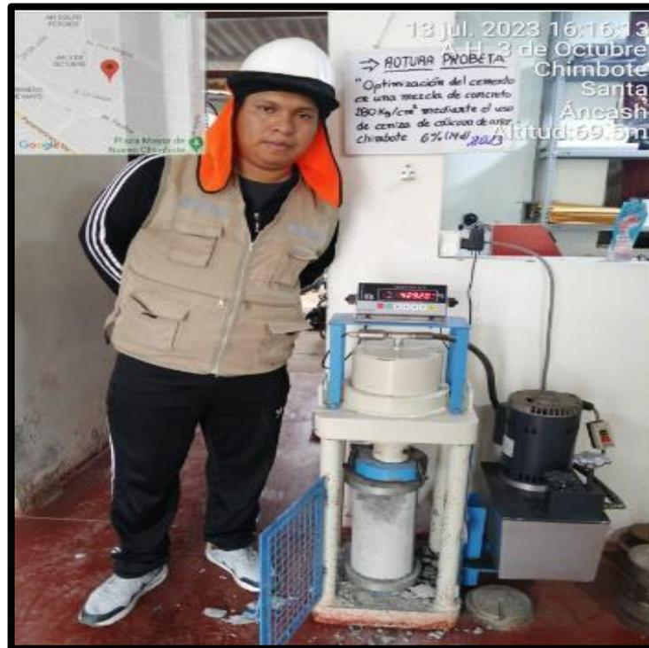
Imagen 43: Rotura de briquetas patrón y experimentales a los 14 días
