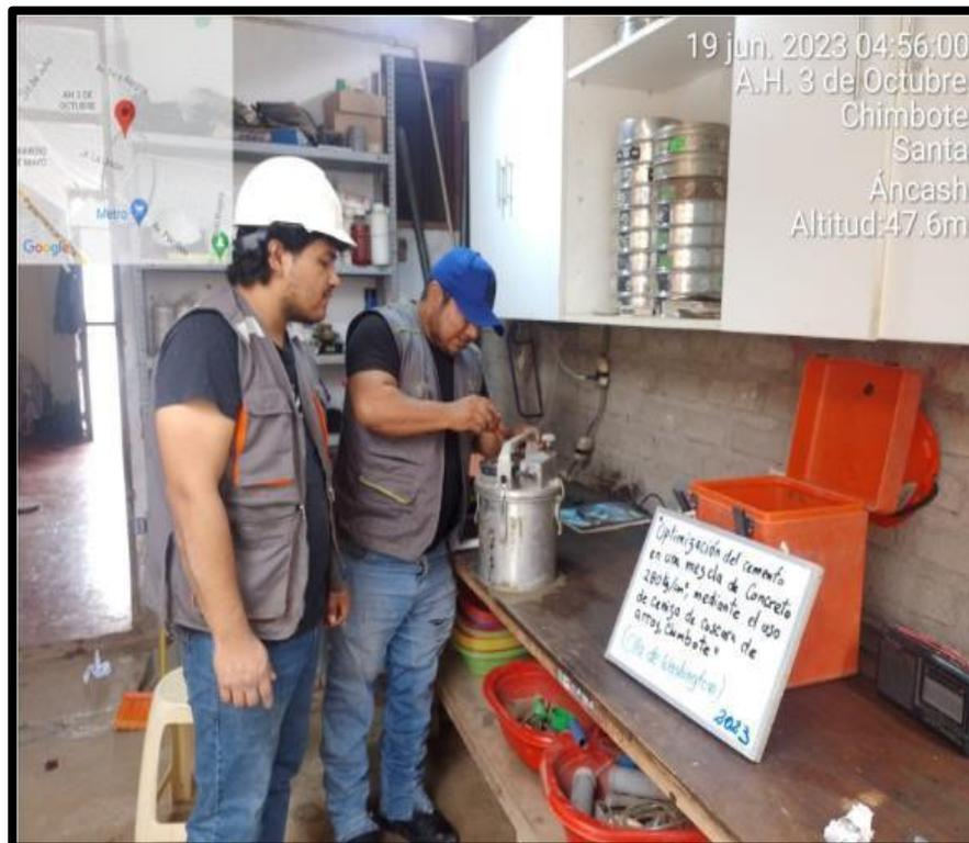
Figura 34: Colocación de cubierta en la olla
