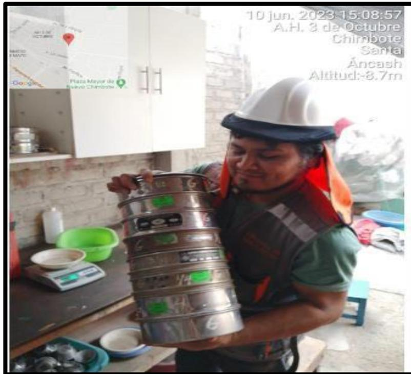
**Imagen 13:** Bachiller De Paz Huaman Jerson Y. pasando la muestra de agregados finos y grueso por las mallas
