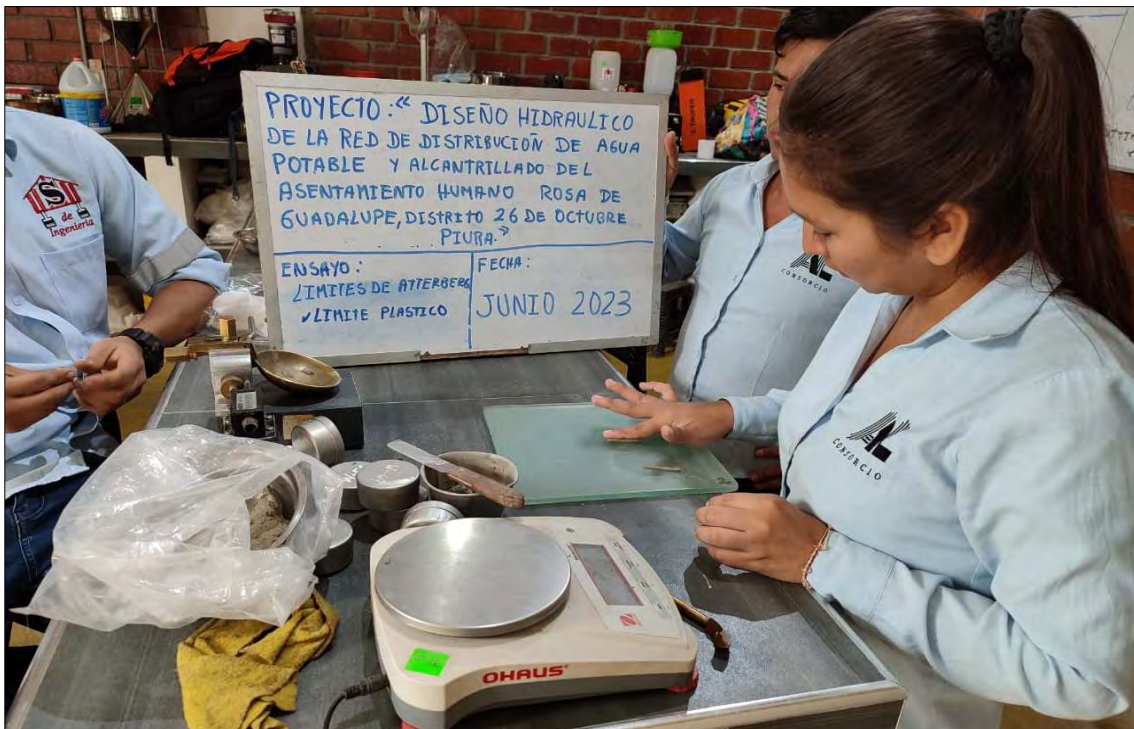
Figura 31. Proceso de ensayo de límite líquido
