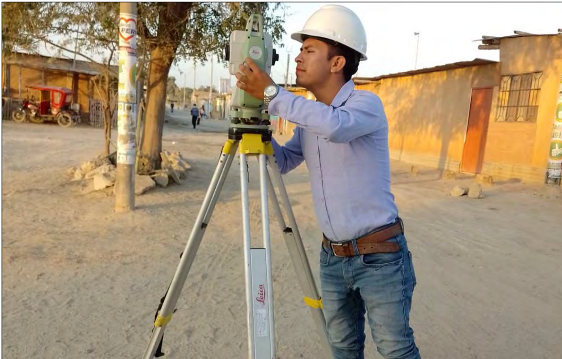
Figura 18. Proceso de visación de puntos registrados en la estación total
