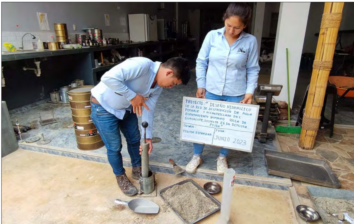
Figura 33. Realización de ensayo de proctor estándar
