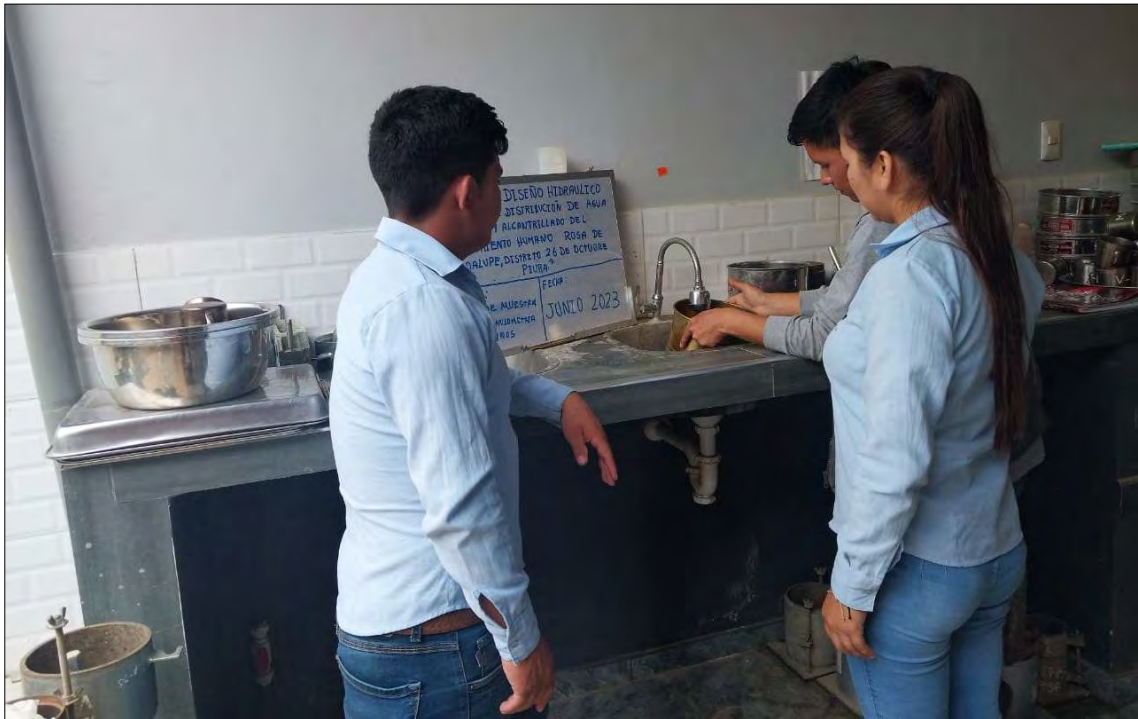
Figura 28. Proceso de lavado de las muestras de suelo
