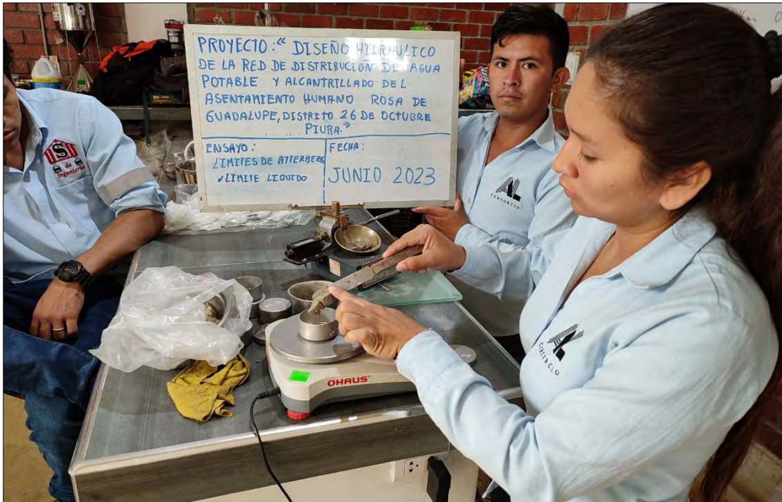
Figura 30. Realización del ensayo de límite líquido
