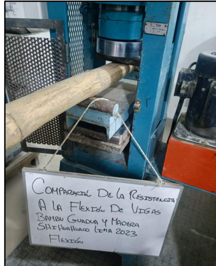
Figura N°11: Ensayo de flexión estática para bambú Guadua
