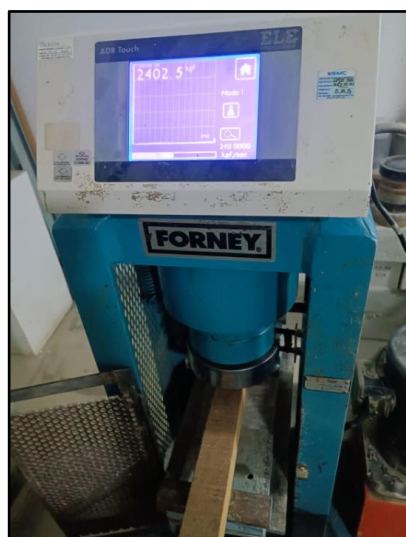
Figura N°09: Ensayo de flexión estática para madera Shihuahuaco
