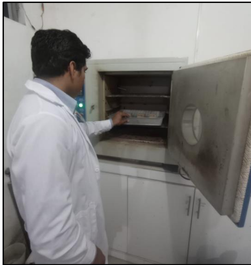
Figura N°05: Colocación de muestras de Shihuahuaco en el horno de secado para CH
