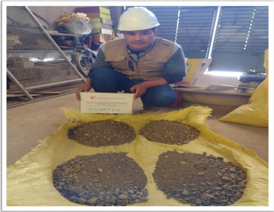
Fotografía 2. Cuarteo para sus análisis en laboratorio.
