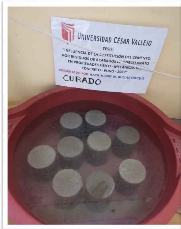
Fotografía 13. Curado de las probetas cilíndricas y ensayo de flexión
