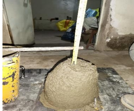
Figura 4. Composición de la mezcla y slump (asentamiento) del hormigón.
