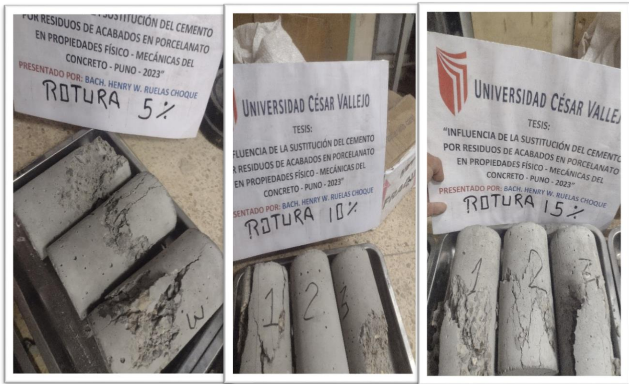
Fotografía 17. Proceso de rotura ensayo a compresión a los 7 días
