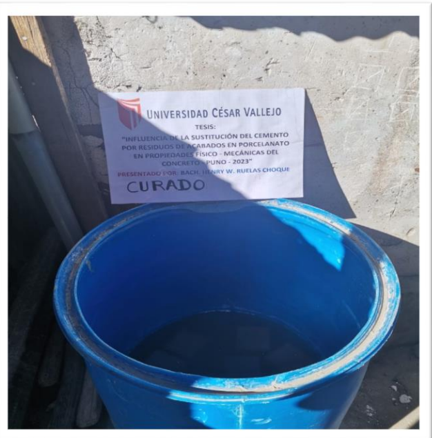
Fotografía 14. Proceso de curado 7,14,28 días de probetas cilíndricas y vigas.
