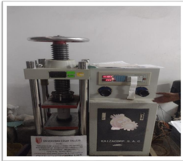
Fotografía 16. Proceso de rotura ensayo a compresión
