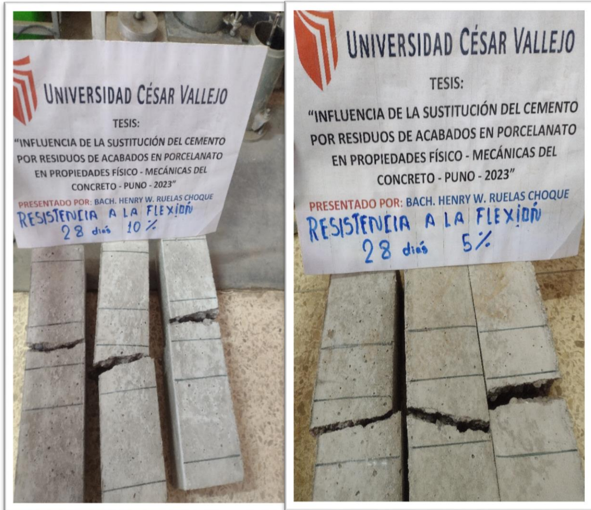
Fotografía 26 - 27. Resultados de la rotura del 10%, 5% en ensayo de flexión a los 28 días
