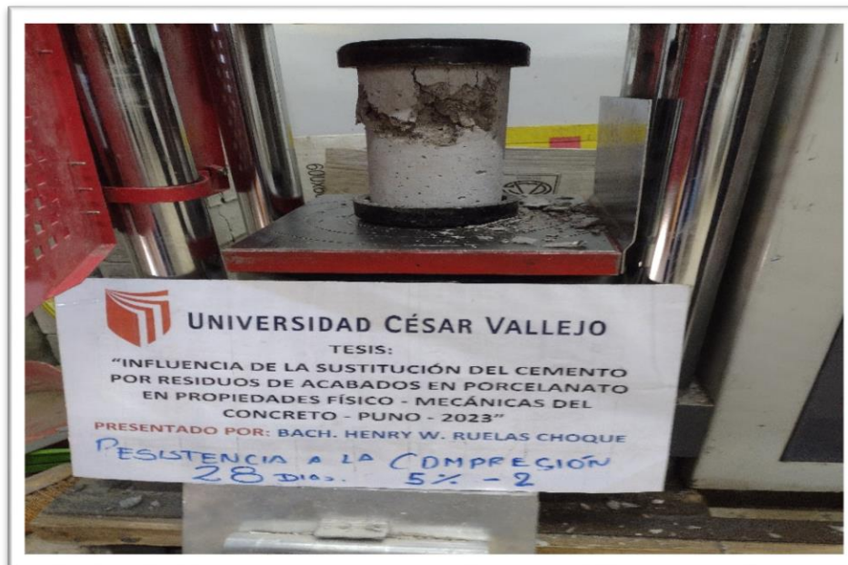
Fotografía 23. Proceso de rotura ensayo de compresión a los 28 días
