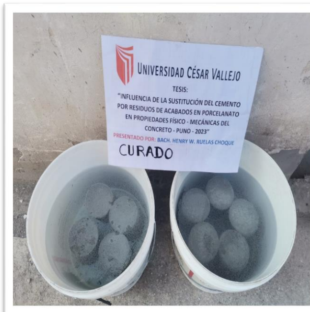
Fotografía 13. Curado de las probetas cilíndricas y ensayo de flexión
