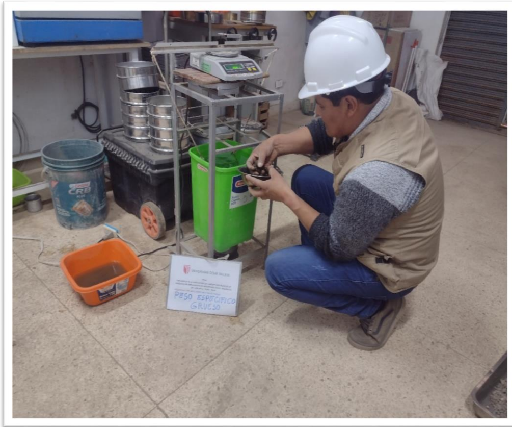
Fotografía 7. Peso específico del agregado grueso
