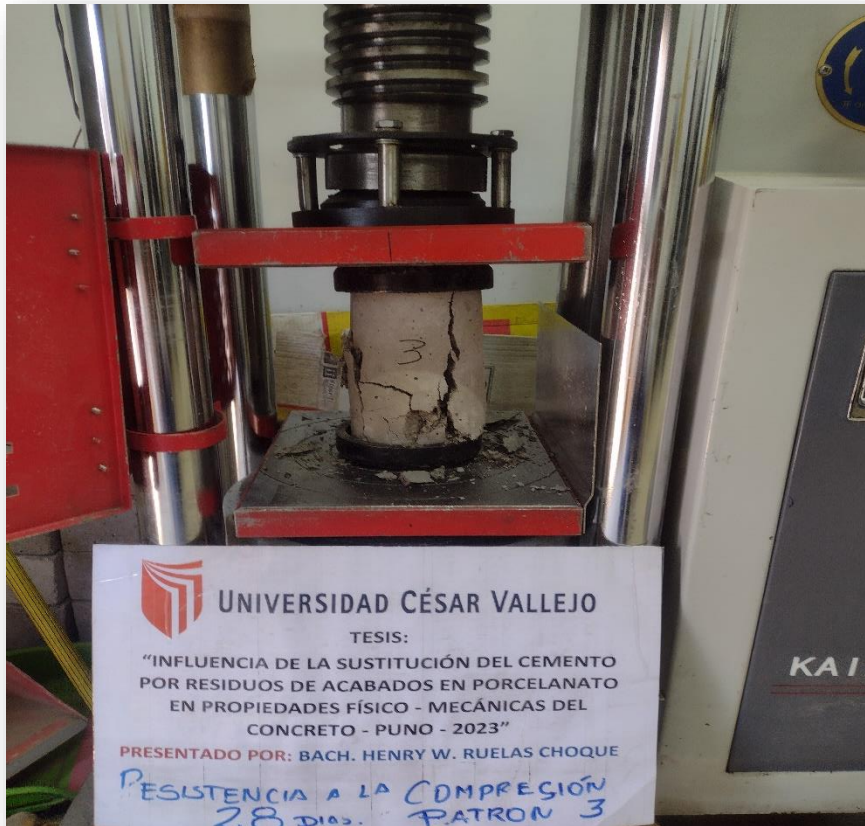
Fotografía 22. Proceso de rotura ensayo de compresión a los 28 días
