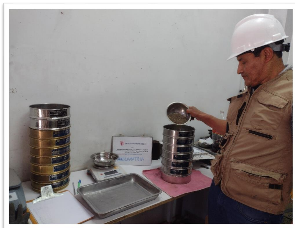
Fotografía 6. Tamizado del agregado fino.
