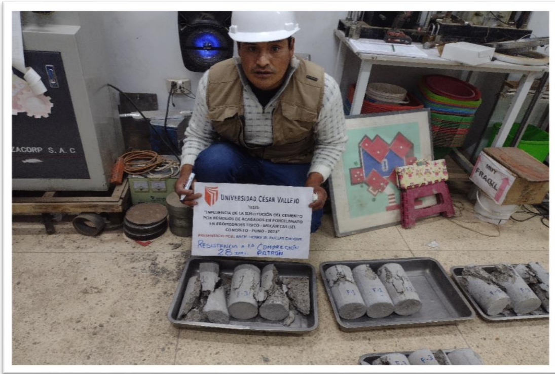
Fotografía 24. Resultados de la rotura del Patrón en ensayo de compresión falla 3 a los 28 días
