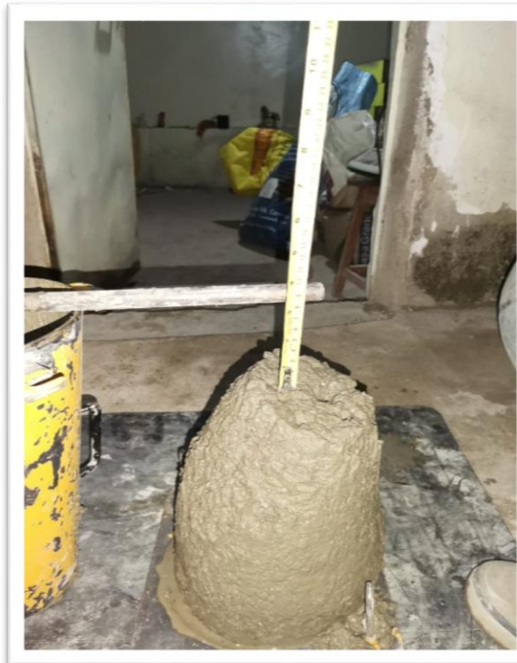
Fotografía 11. Ensayo de sentamiento con el cono de Abrams
