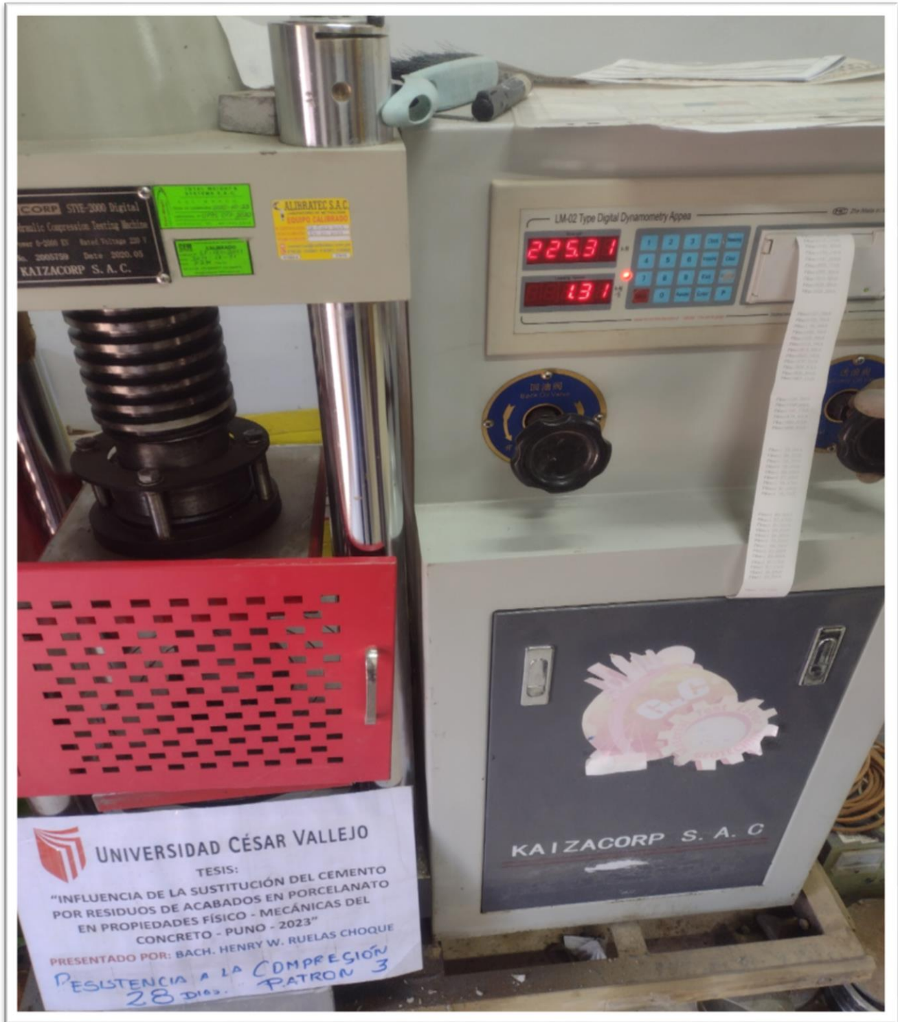
Fotografía 28. Resultados de la rotura de un valor 225,31 Kn, ensayo de compresión de patrón a los 28 días.
