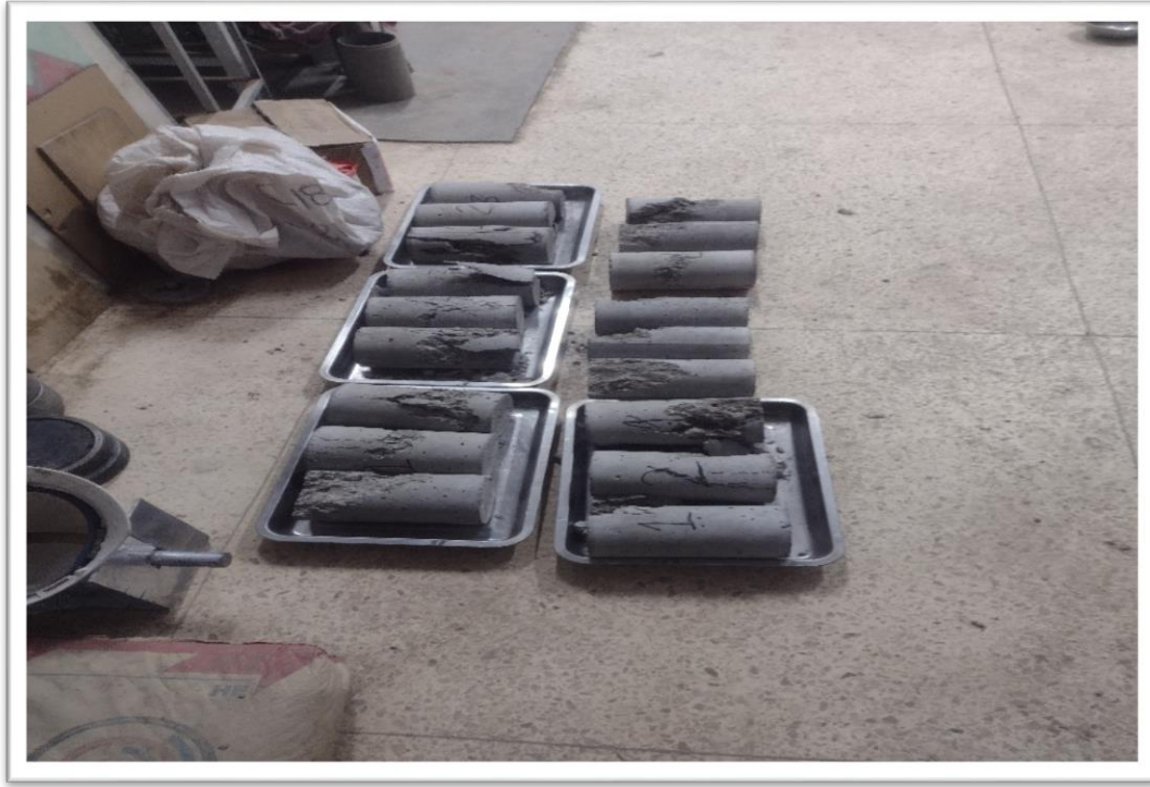
Fotografía 17. Proceso de rotura ensayo a compresión a los 7 días
