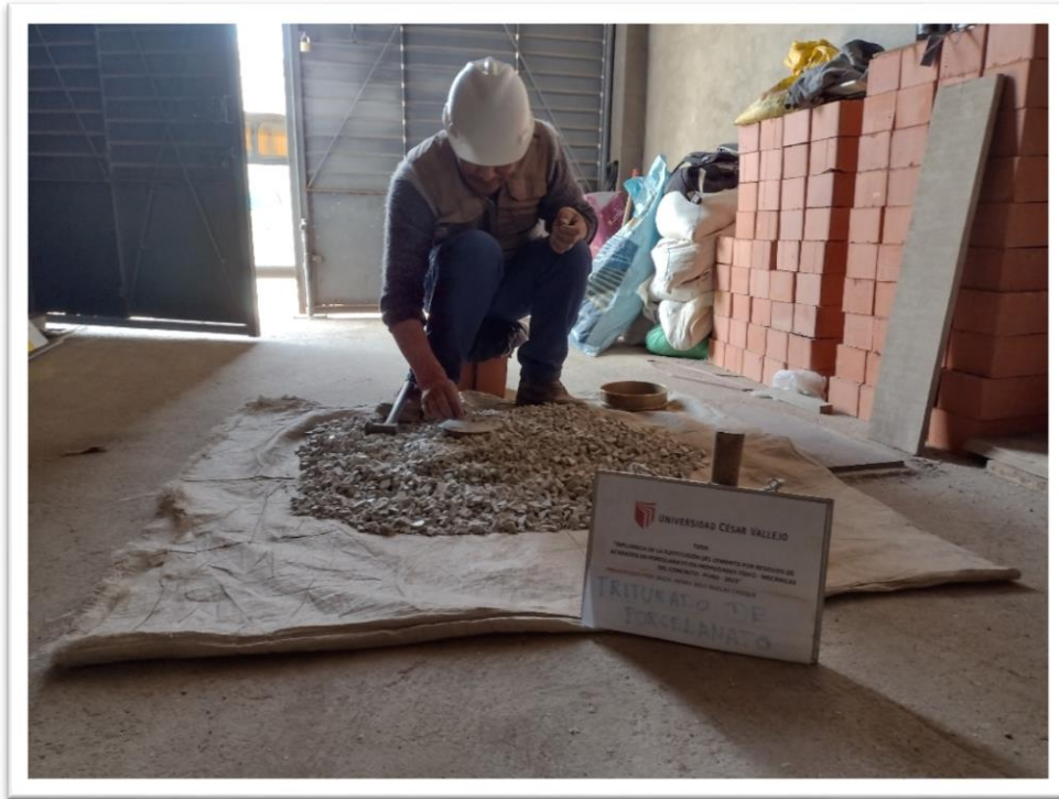
Fotografía 3. Triturado de porcelanato y después molido en laboratorio
