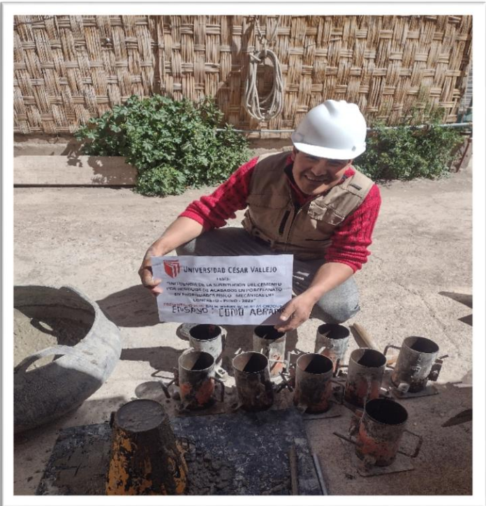
Fotografía 11. Ensayo de sentamiento con el cono de Abrams
