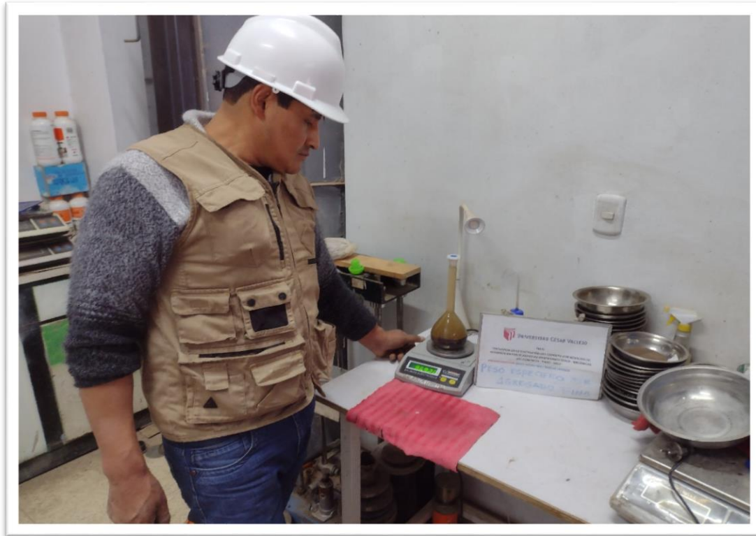
Fotografía 9. Peso específico del agregado fino
