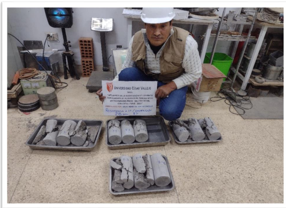
Fotografía 25. Resultados de la rotura del 5% en ensayo de compresión falla 1 a los 28 días
