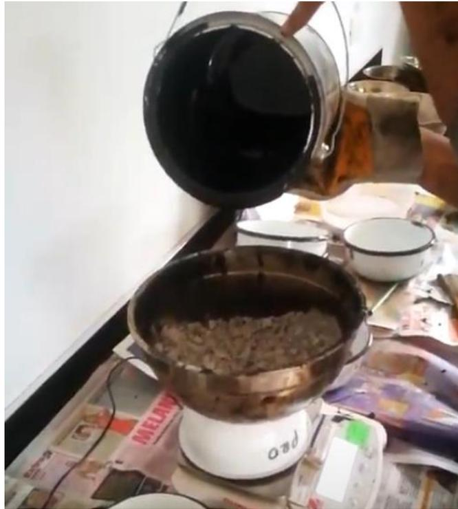
**Figura 78:** Vertido de cemento asfáltico según su peso
