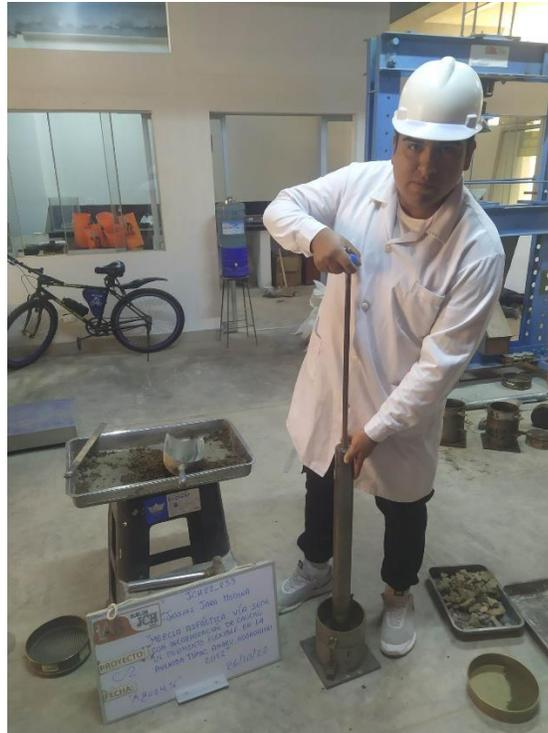
**Figura 36:** Compactado en el molde para el Proctor en 5 capas de 56 golpes
