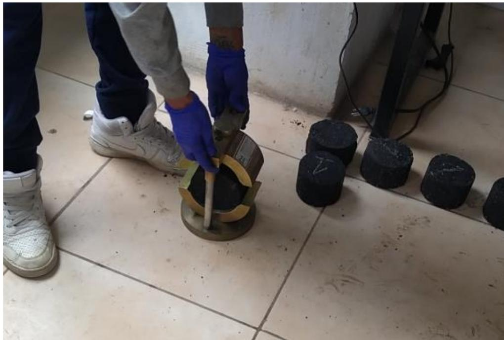
**Figura 89:** Colocado de la briqueta en los collarines
