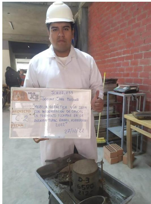
**Figura 37:** Muestra compactada en el molde para el Proctor
