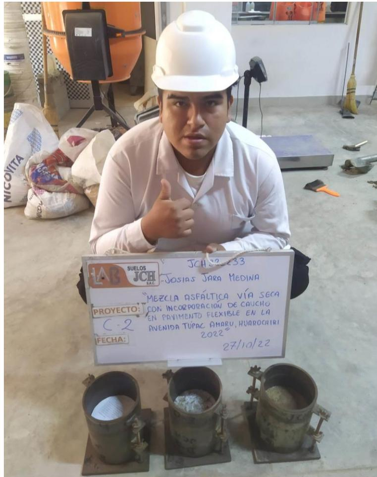
**Figura 45:** Moldes CBR compactado con 56, 25 y 10 golpes
