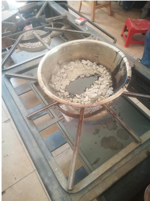
**Figura 68:** *Colocado de los agregados en la cocina para el mezclado*
