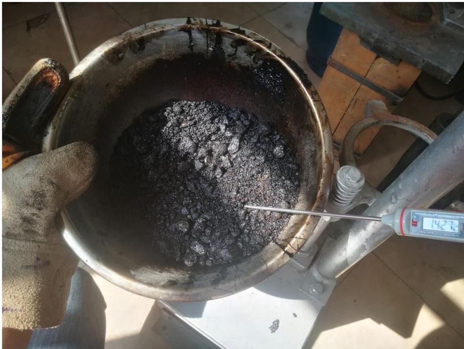
**Figura 70:** Mezclado uniforme de los agregados
