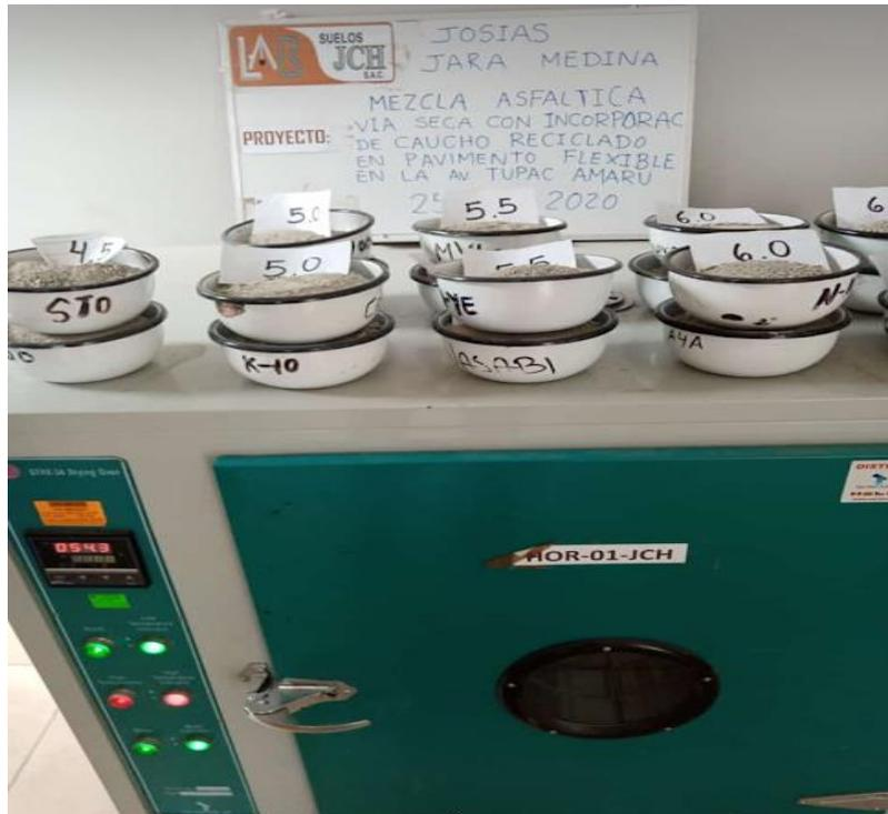
**Figura 65:** Colocación de los agregados al horno
