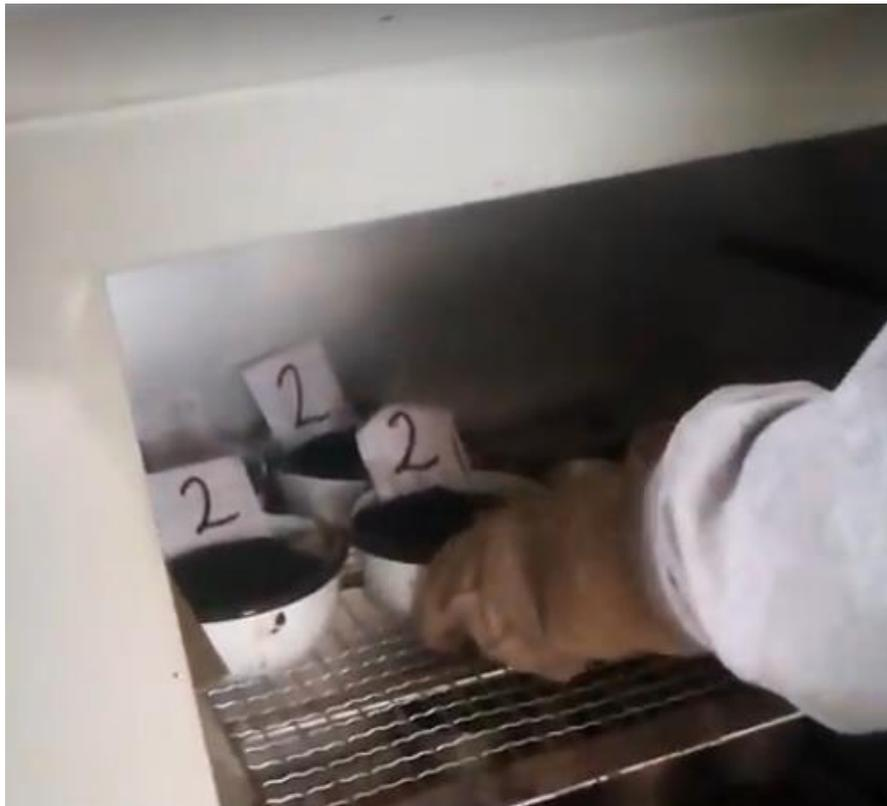
**Figura 77:** Sacado de agregados con 1% y 2% de caucho
