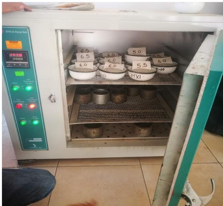
**Figura 66:** Sacado de agregados del horno
