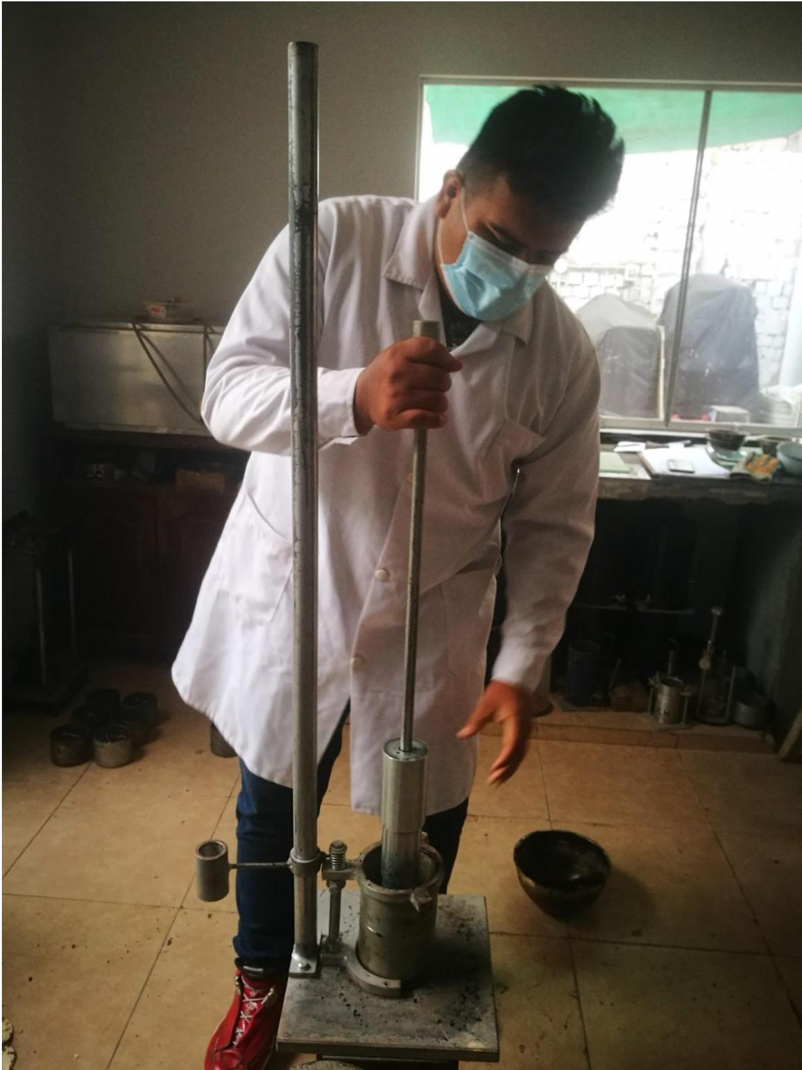
**Figura 80:** Compactado de la mezcla asfáltica con caucho
