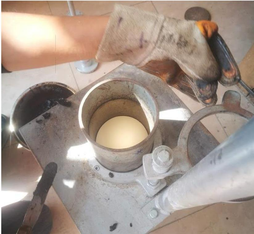
**Figura 71:** Molde de las briquetas donde se ara el compactado de la mezcla asfáltica
