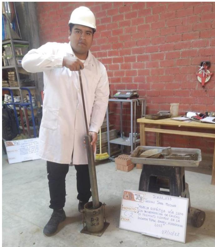
**Figura 43:** Compactado para el ensayo CBR en 5 capas
