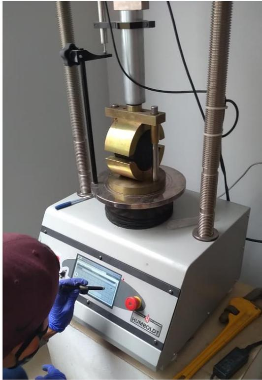
**Figura 90:** Colocación en la prensa Marshall
