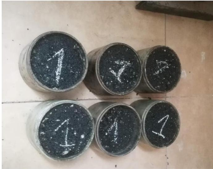
**Figura 81:** Mezcla compactada con 1% de caucho
