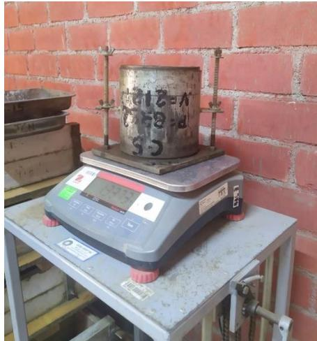
**Figura 44:** Pesado con la muestra compactada
