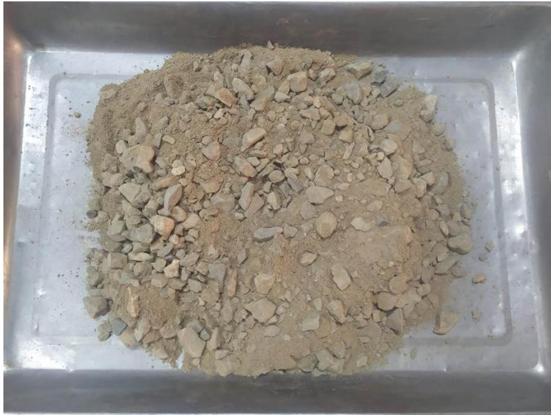
**Figura 32:** Muestra de calicata para realización del Proctor
