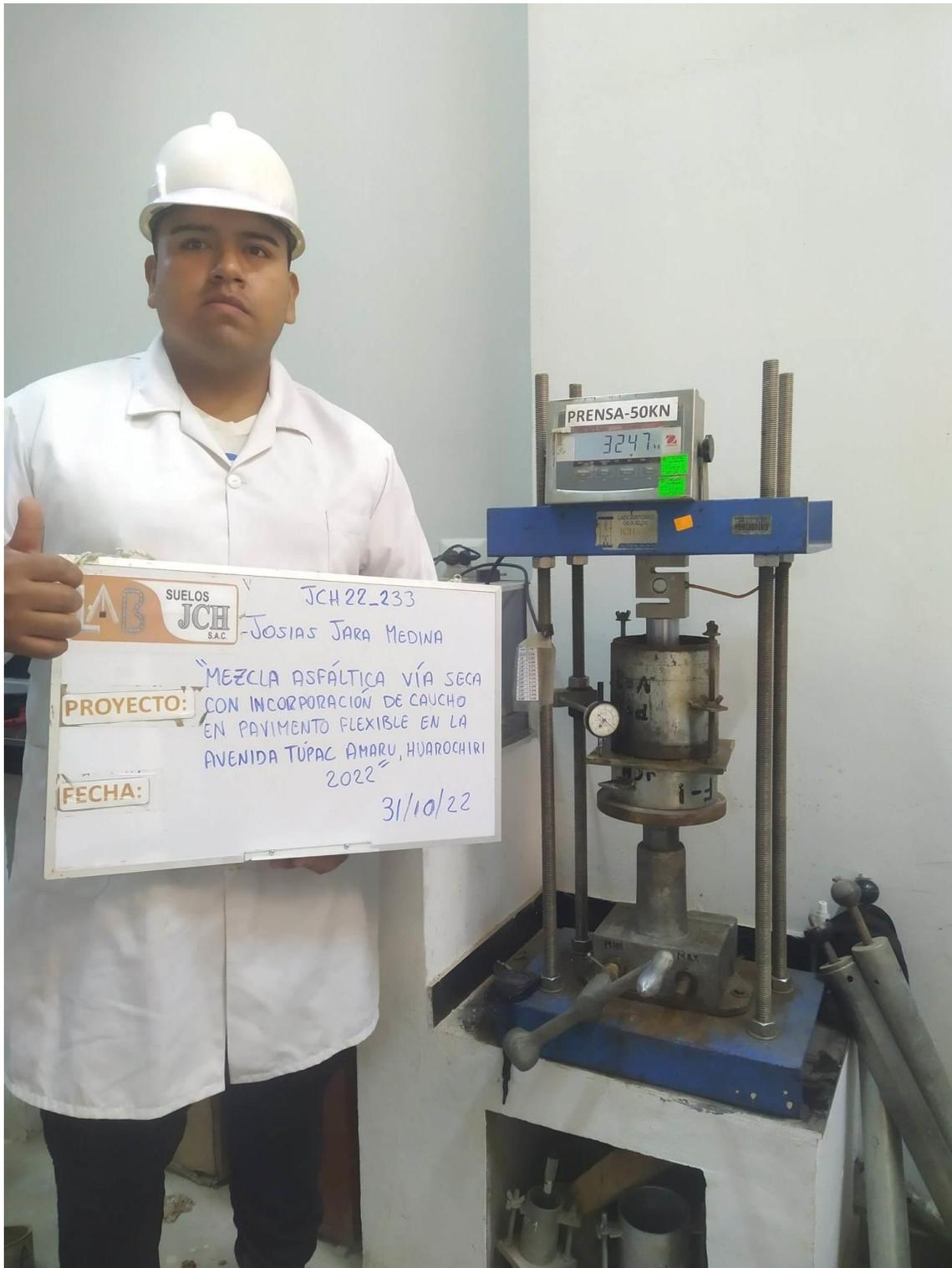
**Figura 48:** Rotura del CBR
