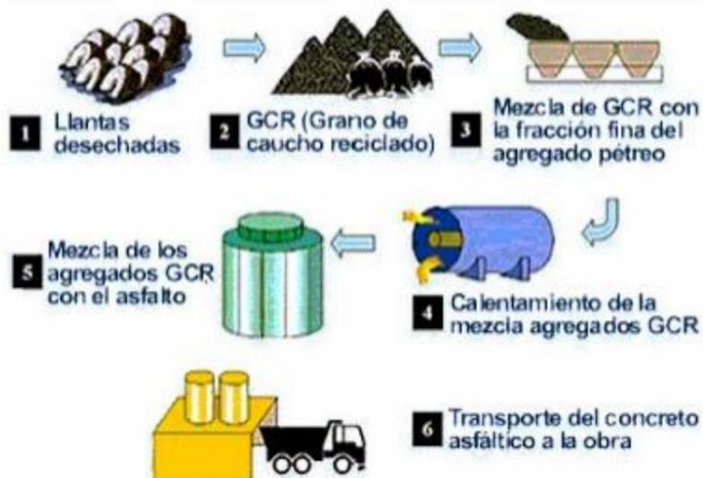
**Figura 7:** Proceso del caucho reciclado
