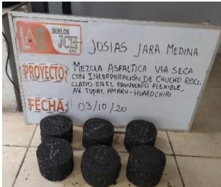
**Figura 93:** Briquetas con 1% de caucho después de la falla
