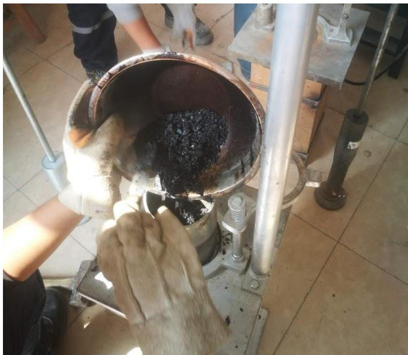
**Figura 72:** Vertido de la mezcla asfáltica en el molde
