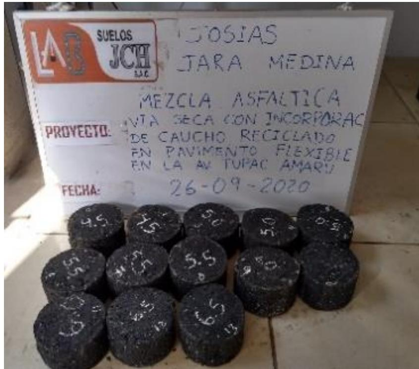
**Figura 92:** Briquetas con 0% de caucho después de la falla
