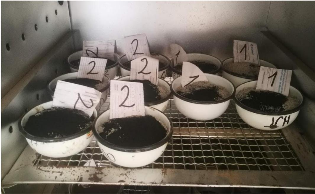
**Figura 76:** Agregados con 1% y 2% de caucho puesto en el horno
