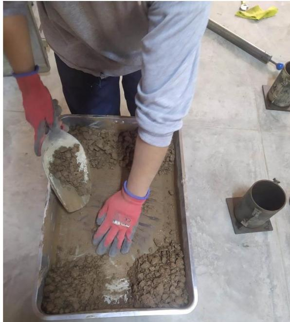
**Figura 42:** Muestra mezclado homogéneamente y distribuido en 5 partes
