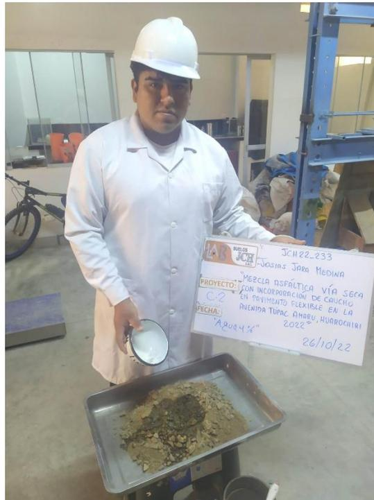
**Figura 35:** Proctor mezclado y compactado con 4% de contenido de humedad
