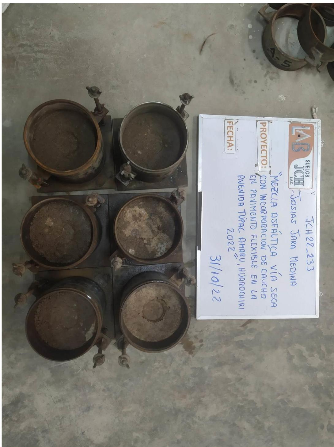
**Figura 50:** Moldes del CBR pasado por la prensa de la C-01 y C-02
