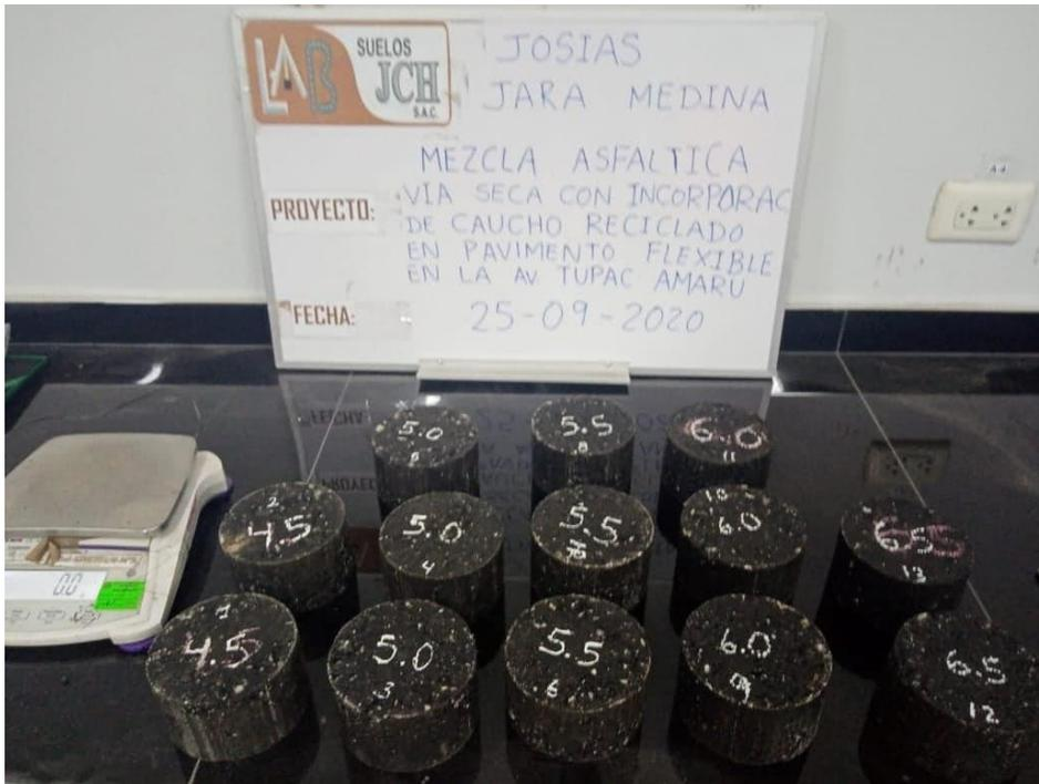
**Figura 74:** Briquetas con 0% de caucho
