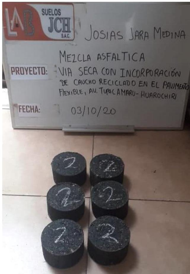
**Figura 82:** Briquetas con 2% de caucho
