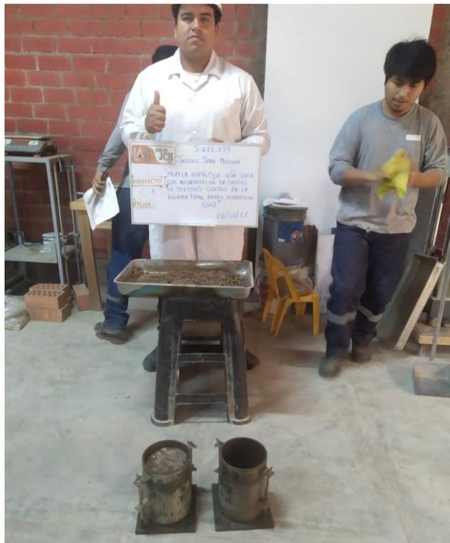
**Figura 41:** Muestra mezclada con el O.C.H. para C-2 fue de 6.70%
