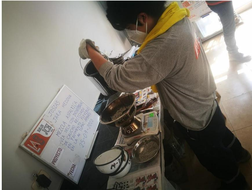
**Figura 67:** *Pesado de cemento asfáltico según su %*
