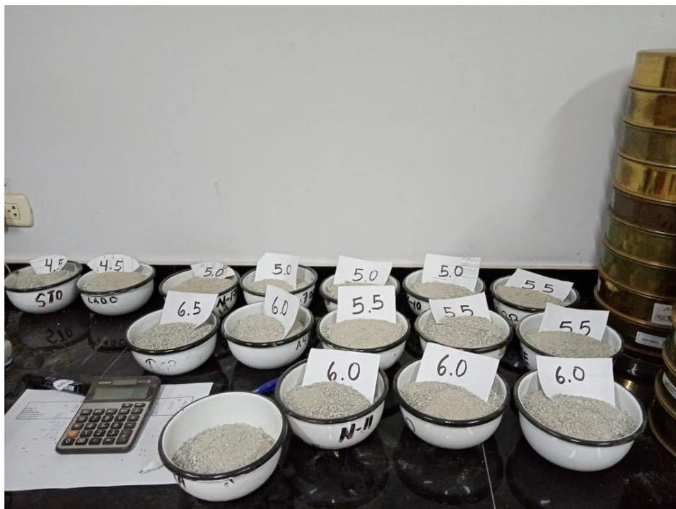
**Figura 64:** Pesado de los agregados
