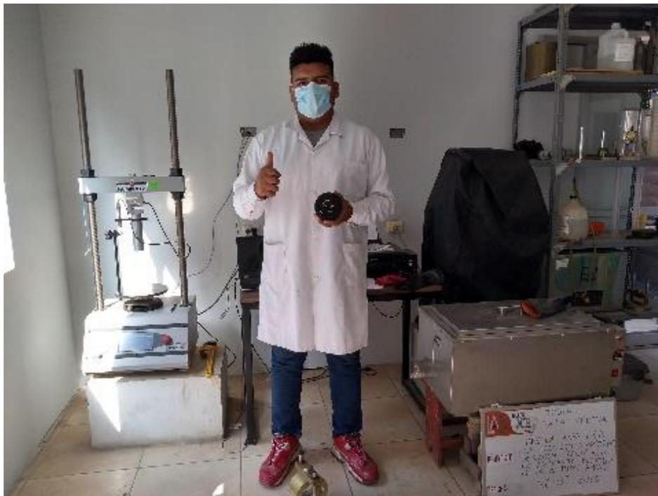
**Figura 95:** Terminando de hacer las pruebas Marshall
