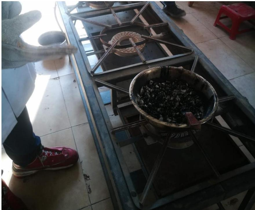
**Figura 79:** Mezclado de los agregados, caucho y cemento asfáltico
