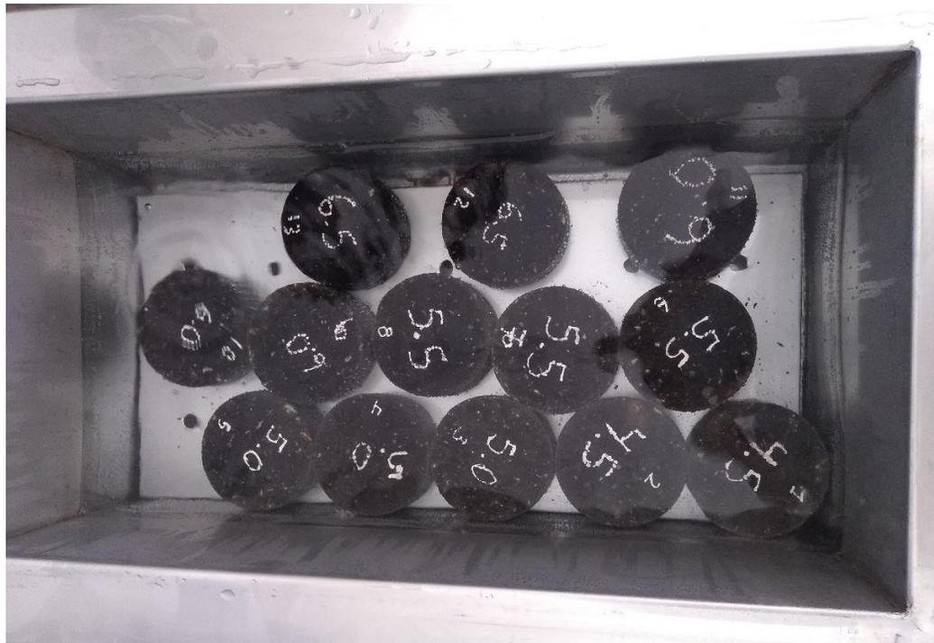
**Figura 84:** Briquetas sumergidas en agua a 60° Centígrados
