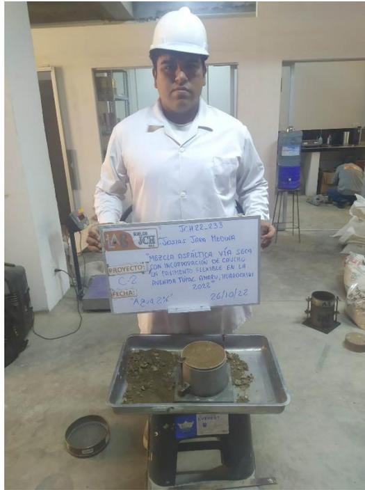
**Figura 34:** Proctor mezclado y compactado con 2% de contenido de humedad
