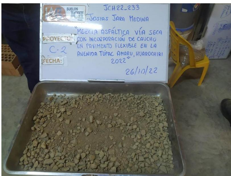
**Figura 39:** Muestra para el ensayo de CBR
