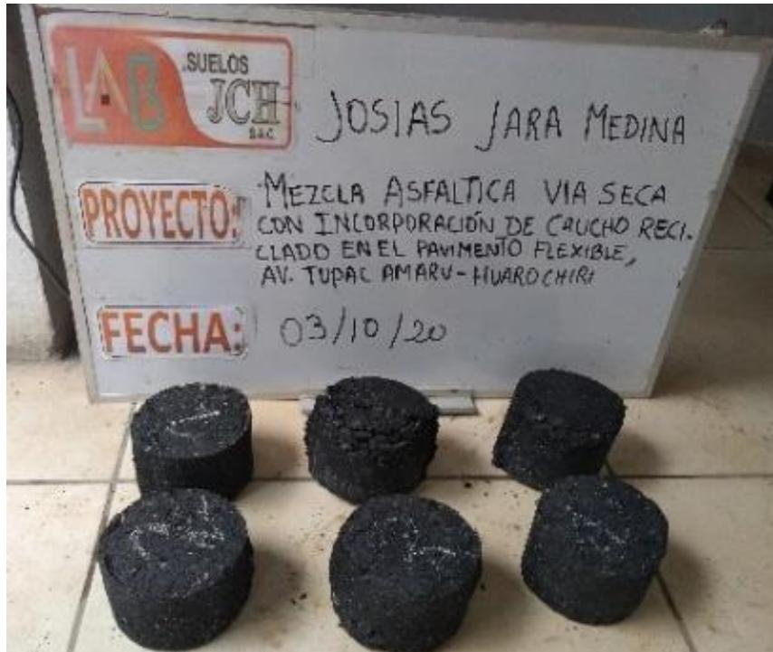
**Figura 94:** Briquetas con 2% de caucho después de la falla
