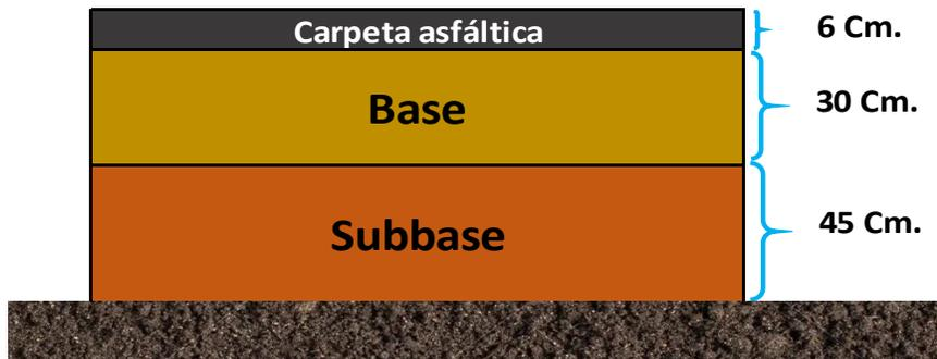
**Figura 133:** Gráfico resultado de pavimento flexible
