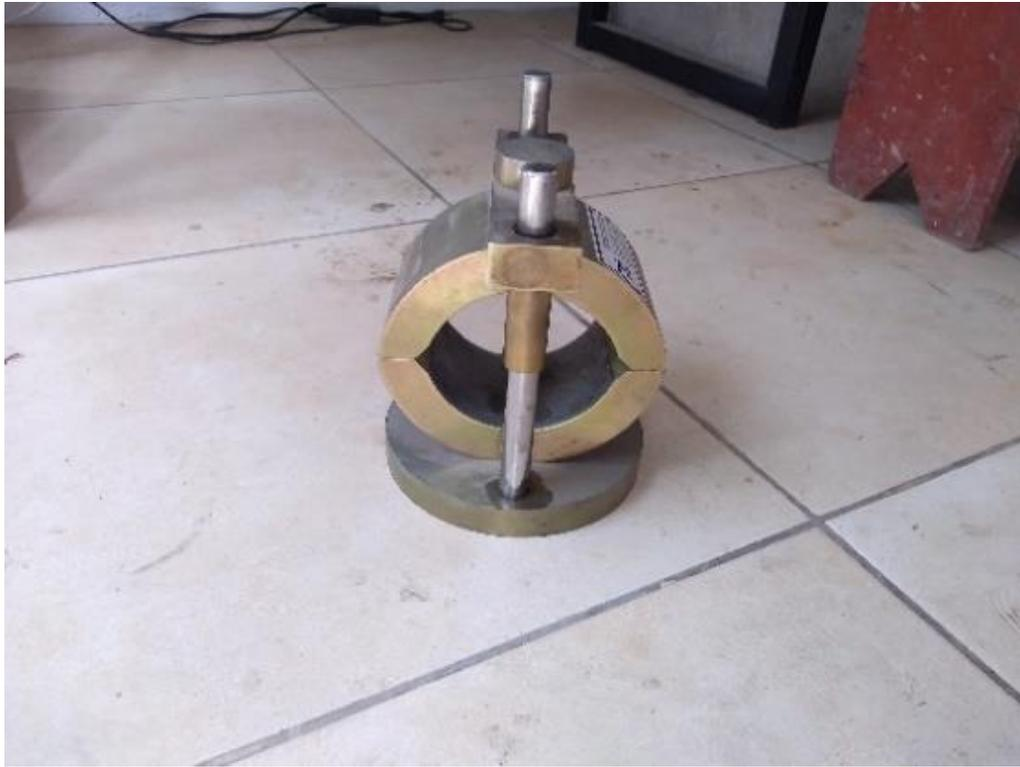
**Figura 88:** Collarines para sujetar a las briquetas
