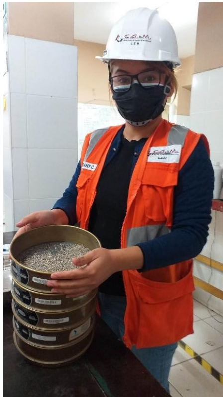
Figura 10. Granulometría realizada a los agregados.
