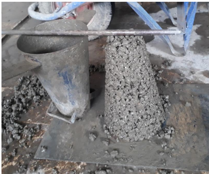
Figura 13. Ensayo de trabajabilidad realizado al concreto permeable fresco
