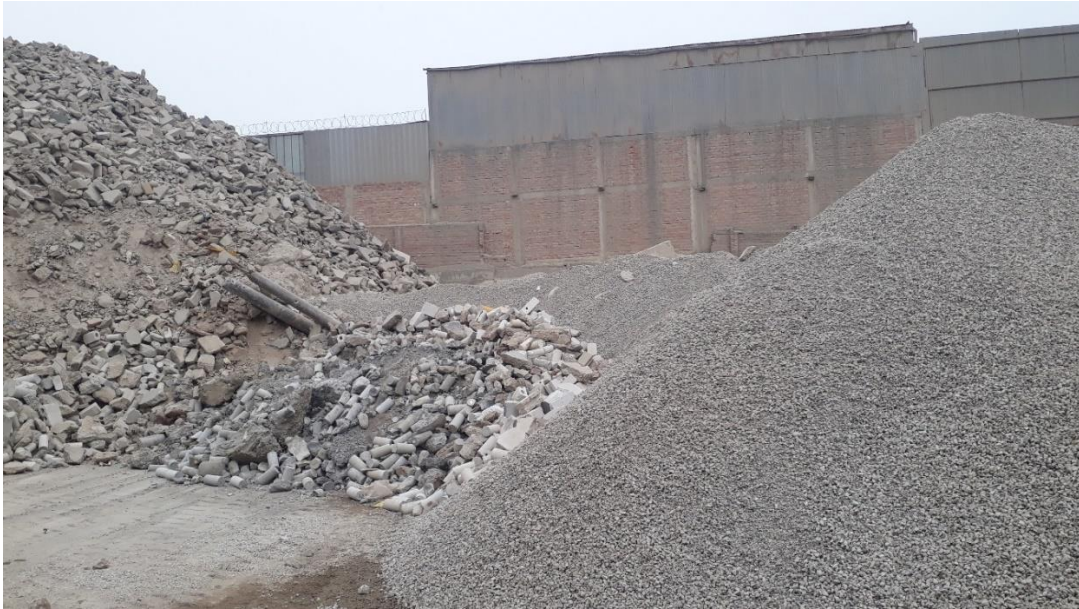
Figura 8. Acopio de residuos de concreto ya limpios y triturados.
