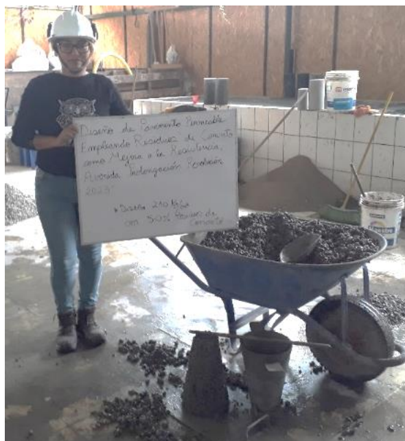
Figura 15. Diseño de mezcla con 50% de residuos de concreto.
