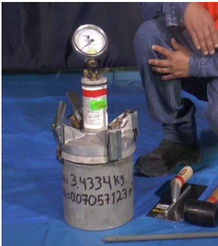
Figura 7: Contenidos de Vacíos (NTP 400-017-2011)
