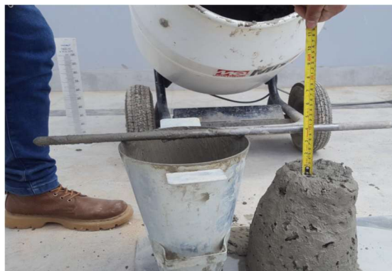
Figura 3: Ensayo de asentamiento
