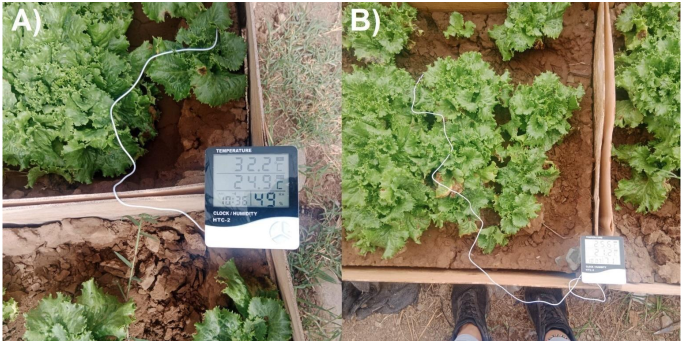
Equipo termohigrómetro con sonda de temperatura (A), Medición de temperatura (B).
