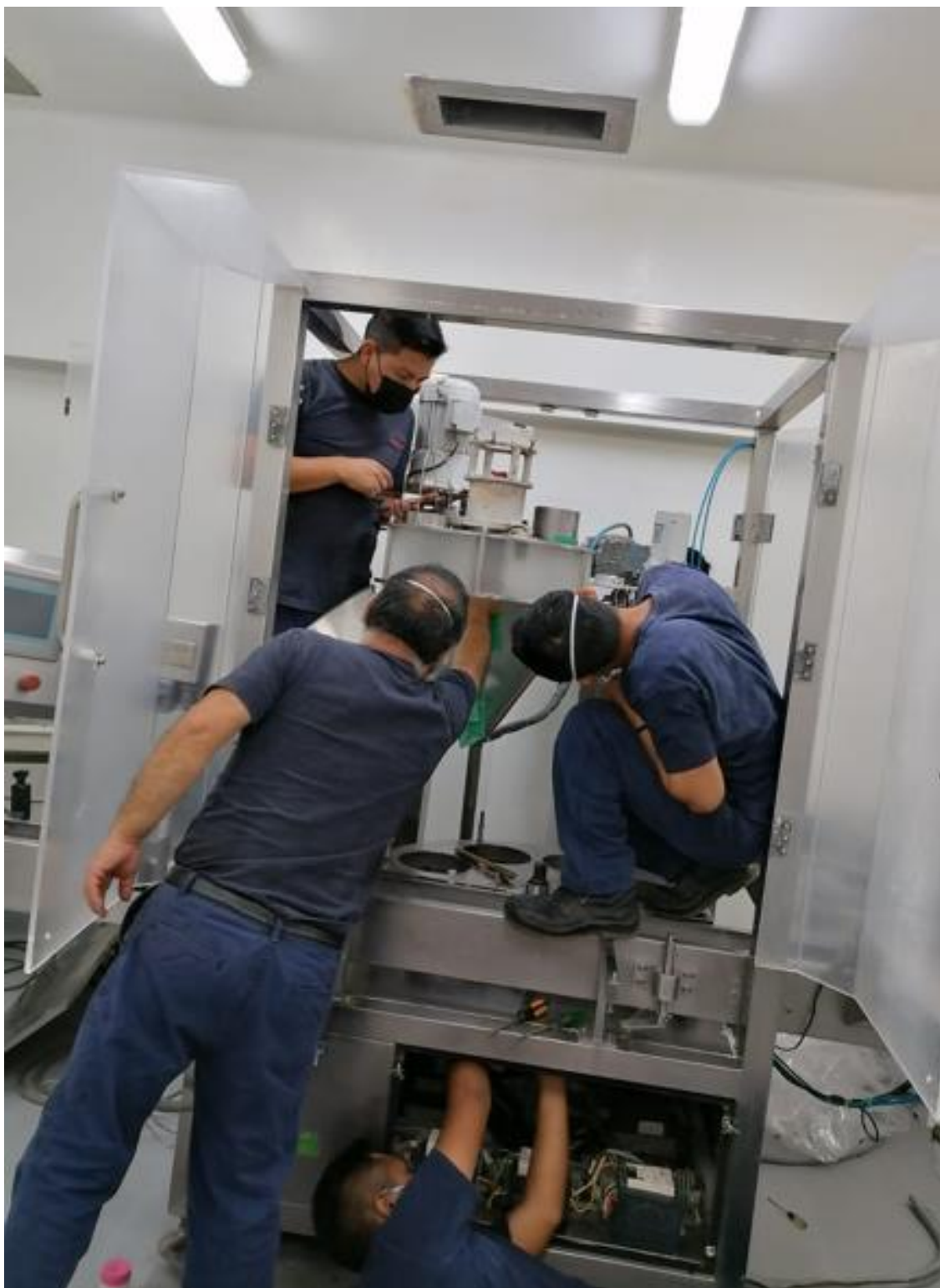
Figura 34. Mantenimiento de llenadora de frascos
