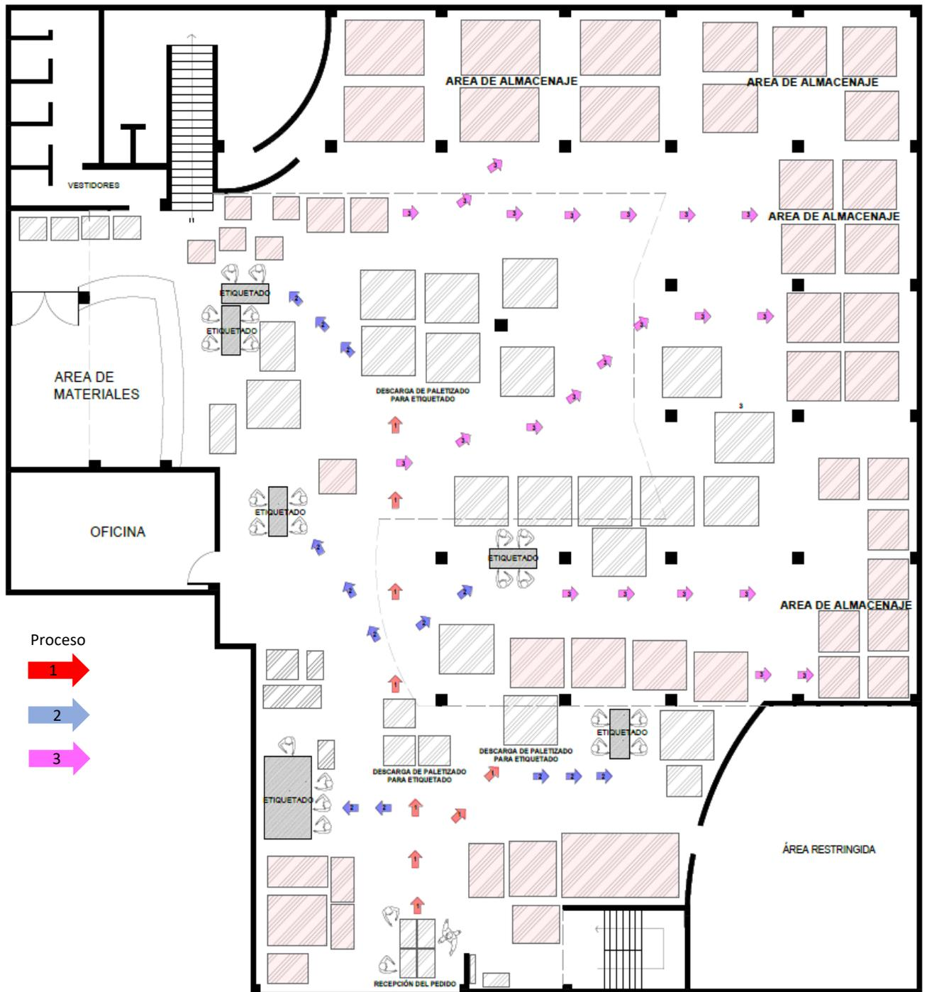
**Figura 1.** Diagrama de recorrido del proceso de almacenaje de conservas
