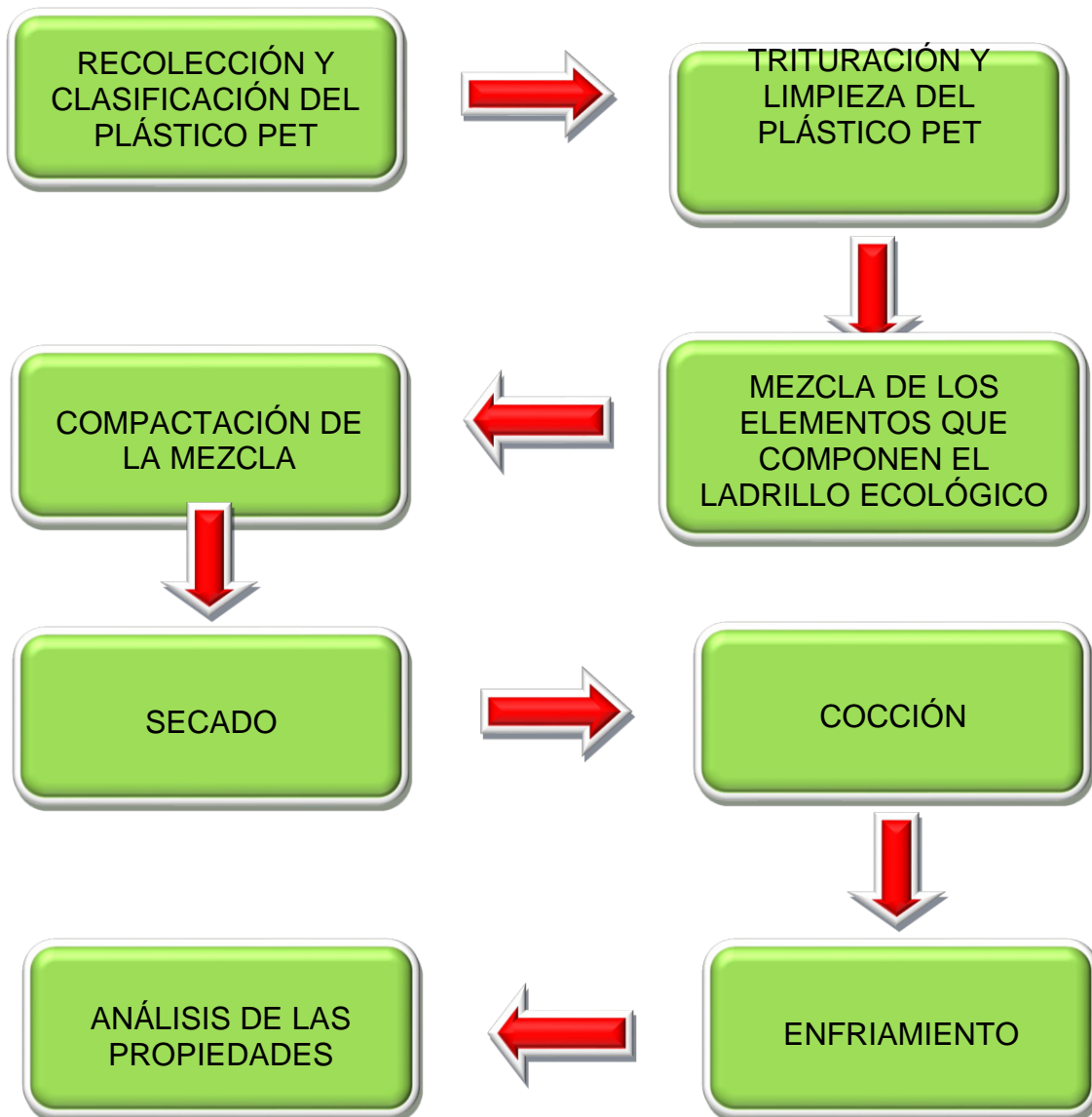
Figura 2. Procedimiento de la elaboración del ladrillo ecológico
