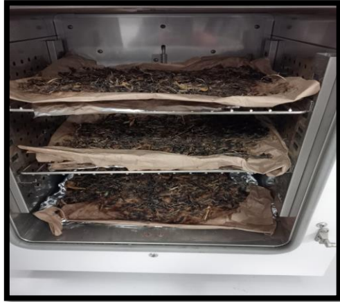
Avance extracción de humedad al 100% (96 HORAS DESPUÉS)
