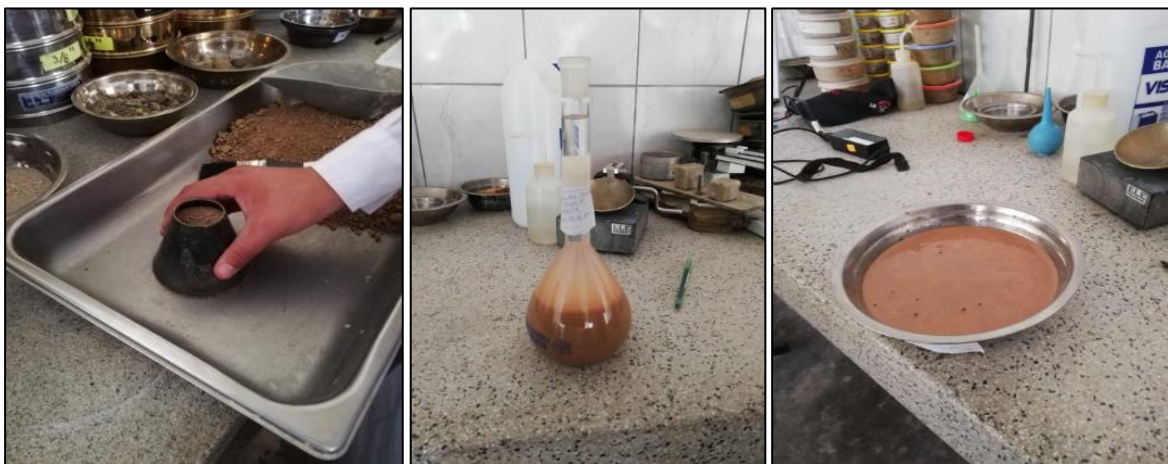
Figura 33. Ensayo del Peso Específico del agregado fino
