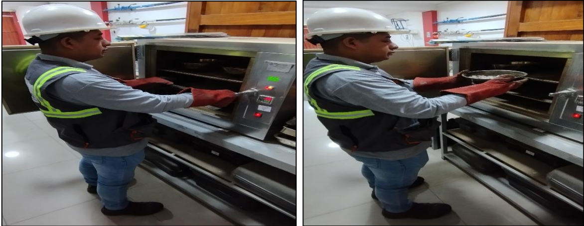
Figura 30. Ensayo de Contenido de Humedad de los agregados
