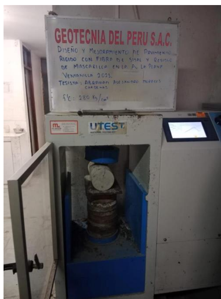
Figura 56. Ensayo de resistencia a flexión
