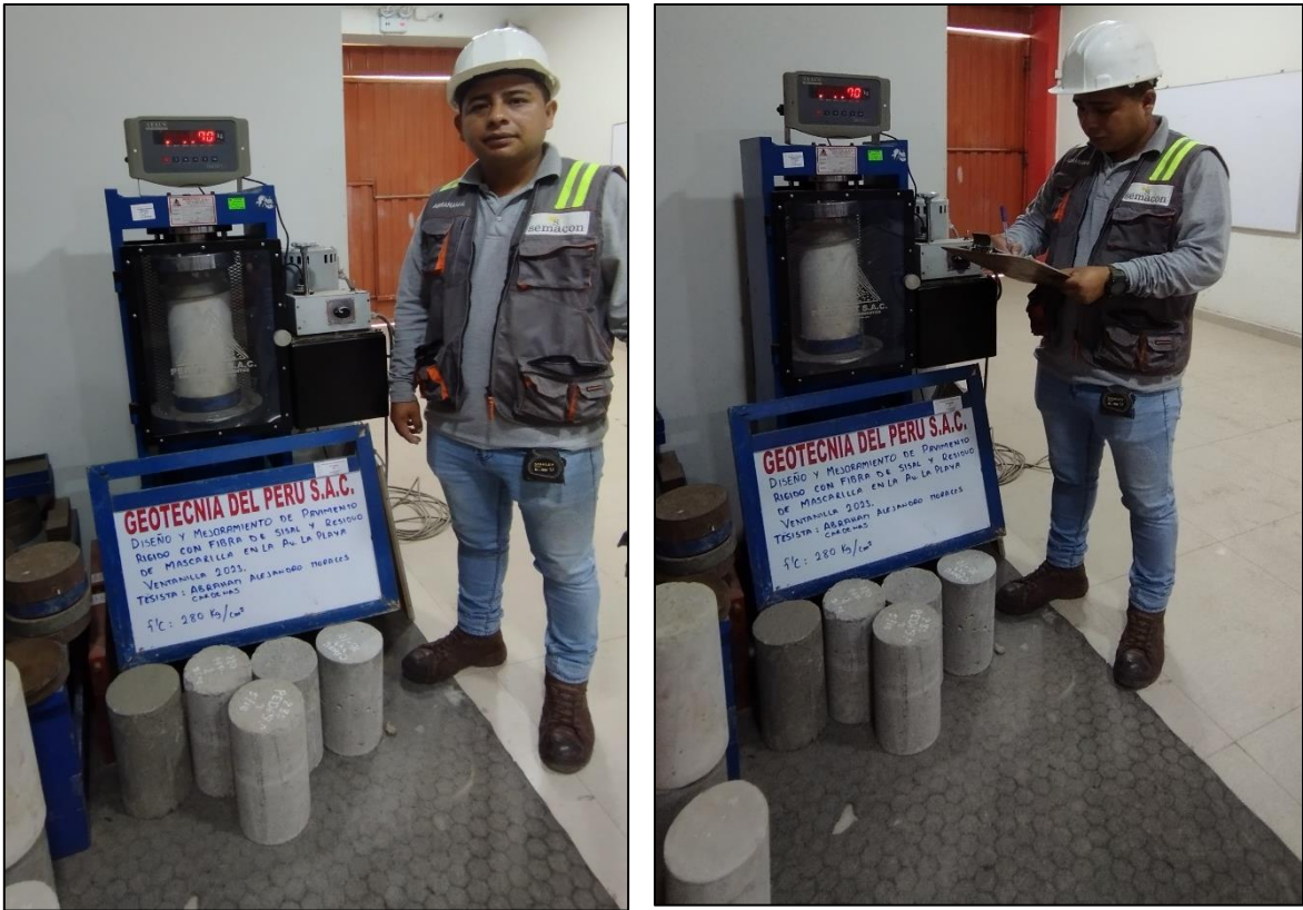
Figura 46. Ensayos a Resistencia a Compresión
