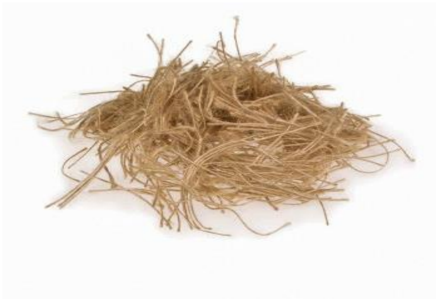
Figura 36. Corte de la Fibra Sisal
