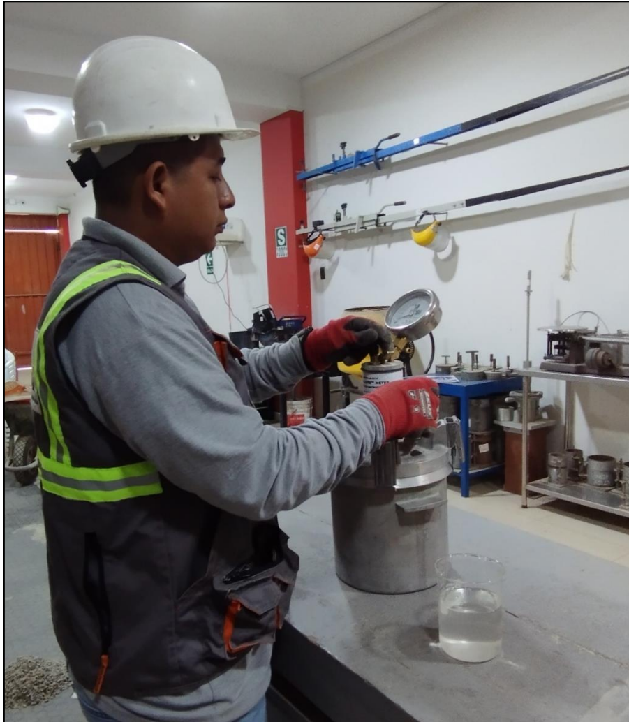
Figura 45. Medición del contenido de aire en el concreto
