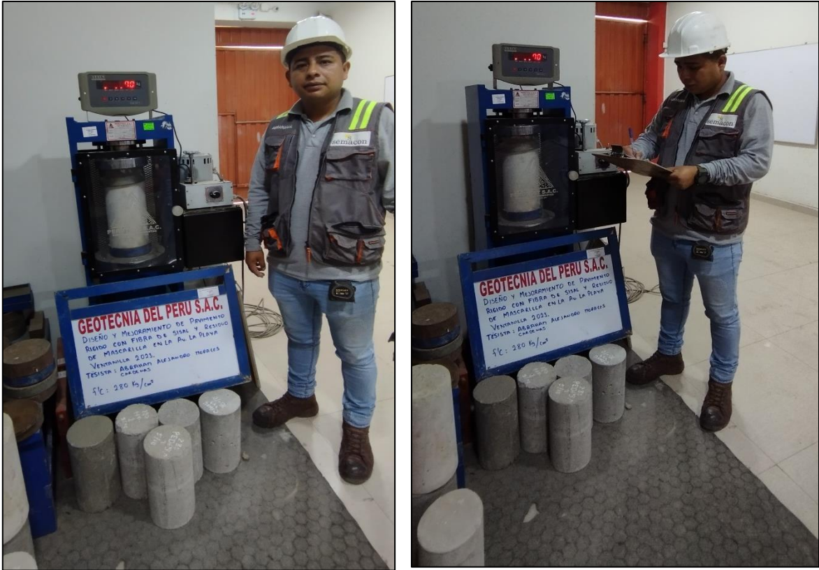
Figura 46. Ensayos a Resistencia a Compresión
