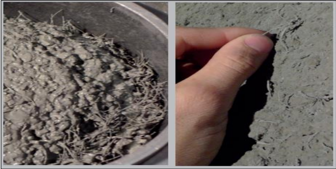
Figura 5. Empleo de fibras de polipropileno en el concreto
