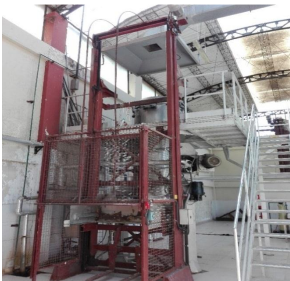
Foto 2: Autoclave marca Ecodas, modelo T-1000
