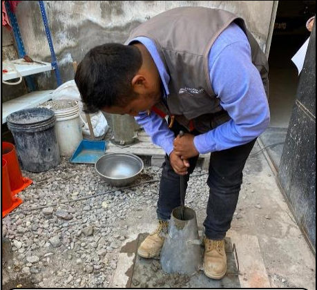
PROCESO DEL ENSAYO DEL CONO DE ABRAMS - VARILLADO
