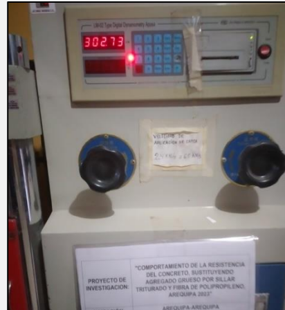
RESULTADO DE ROTURA A LOS 28 DÍAS CE-081522 = 302.73 KN
