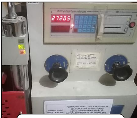
RESULTA DE ROTURA A LOS 14 DÍAS CE-041522 = 272.05 KN
