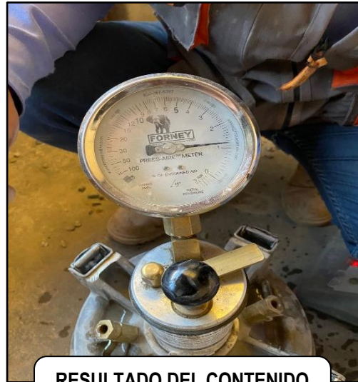
RESULTADO DEL CONTENIDO DE AIRE = 1.2%
