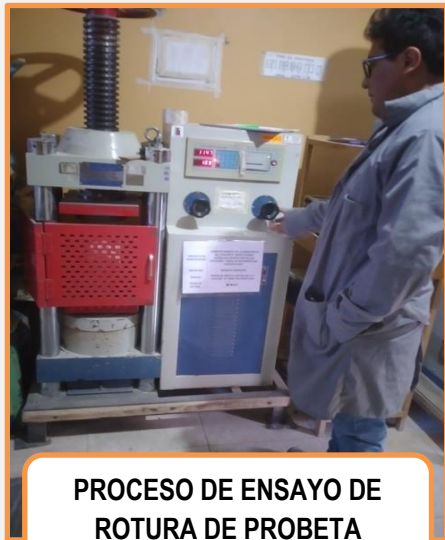
MUESTRA A ENSAYAR A LOS 28 DÍAS DE CURADO- CONCRETO EXPERIMENTAL 1% SILLAR Y 5KG FIBRA
