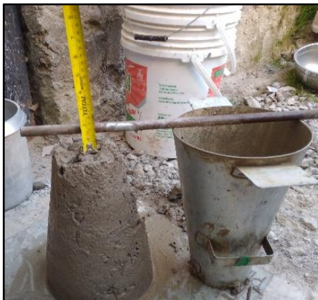
MEDICIÓN DE LA CONSISTENCIA (SLUMP) = 1 1/2"
