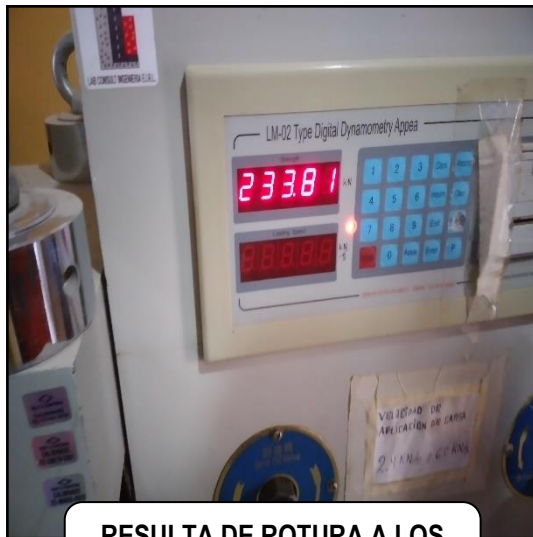
RESULTA DE ROTURA A LOS 7DIAS CP-01 = 216.57 KN
