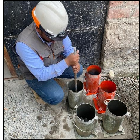
COMPACTACIÓN DE CAPAS MEDIANTE 25 INSERIONES (CHUSEADAS)
