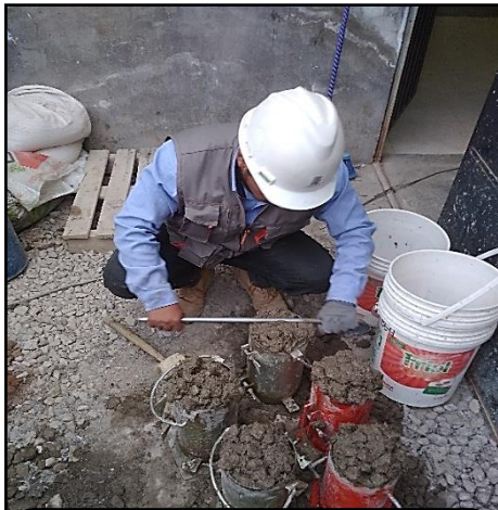
ENRASADO EXCESO DE MEZCLA CON LA VARILLA LISA (PROBETAS)
