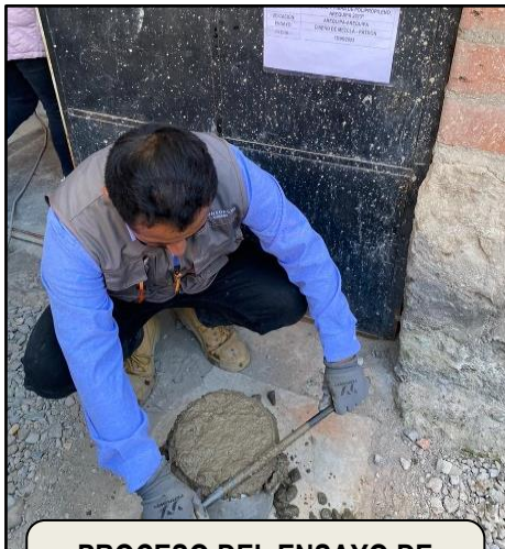
PROCESO DEL ENSAYO DE PESO UNITARIO - ENRASADO
