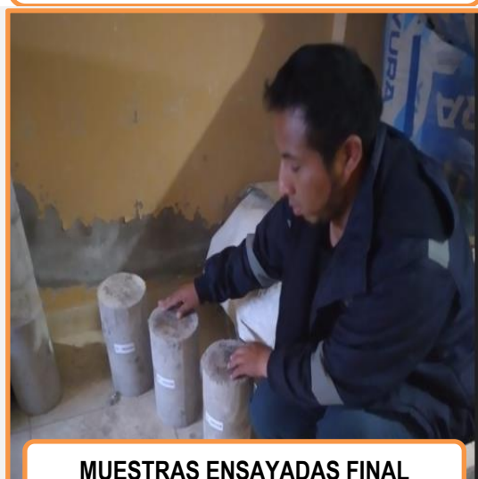
RESULTA DE ROTURA A LOS 14 DÍAS CE-065529 = 252.78 KN
