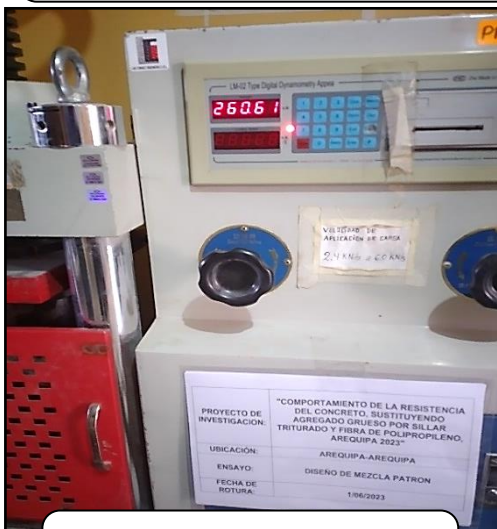
RESULTA DE ROTURA A LOS 14 DÍAS CP-05 = 260.61 KN
