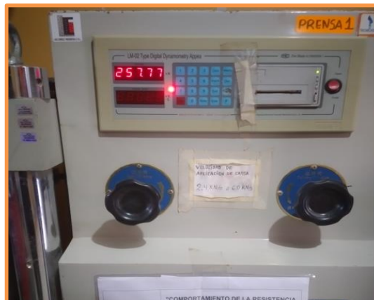
RESULTA DE ROTURA A LOS 14 DÍAS CE-055326 = 257.77 KN
