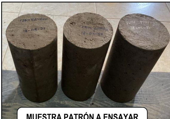
MUESTRA PATRÓN A ENSAYAR A LOS 7 DÍAS DE CURADO
