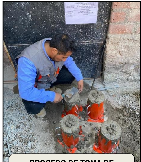
PROCESO DE TOMA DE MUESTRA (ENRASADO)
