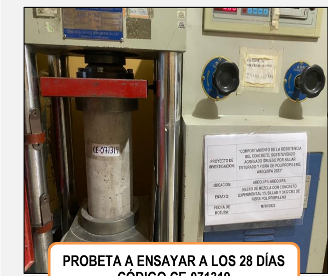
MUESTRA A ENSAYA A LOS 28 DÍAS DE CURADO- CONCRETO EXPERIMENTAL 1% SILLAR Y 3KG FIBRA PILPROPILENO
