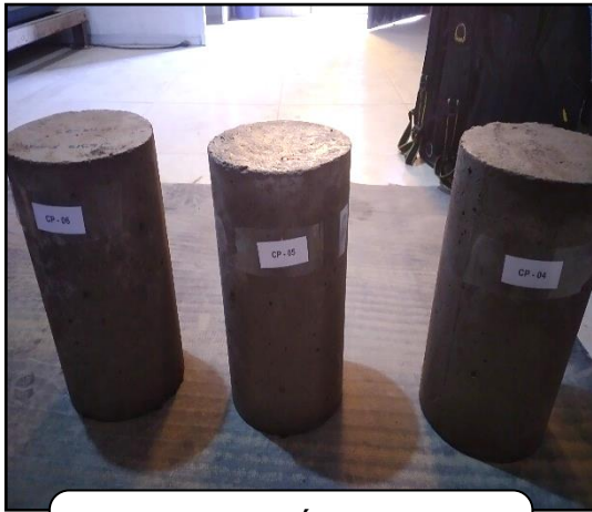
MUESTRA PATRÓN A ENSAYAR A LOS 14 DÍAS DE CURADO
