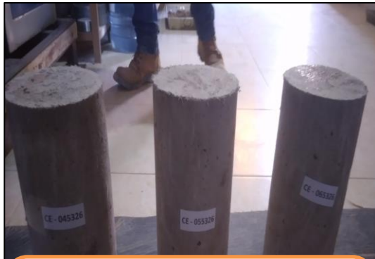
MUESTRA A ENSAYA A LOS 14 DÍAS DE CURADO- CONCRETO EXPERIMENTAL 5% SILLAR Y 3KG FIBRA PILPROPILENO
