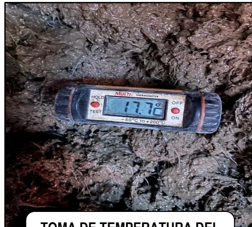
TOMA DE TEMPERATURA DEL CONCRETO = 17.7°C
