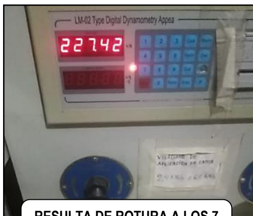
RESULTA DE ROTURA A LOS 7 DÍAS = 227.42 KN
