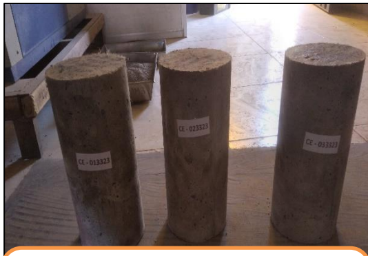
MUESTRA A ENSAYAR A LOS 07DÍAS DE CURADO- CONCRETO EXPERIMENTAL 3% SILLAR Y 5KG FIBRA POLIPROPILENO
