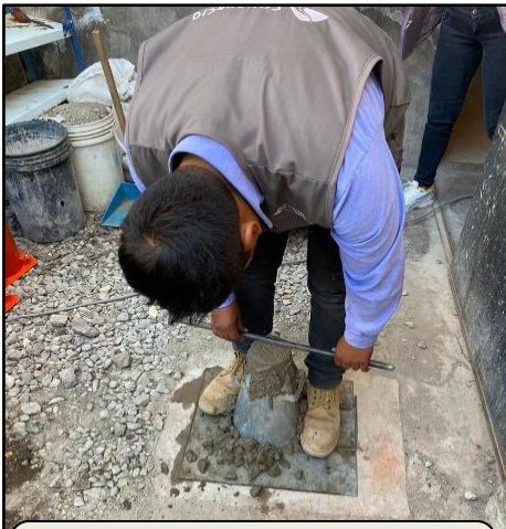
PROCESO DEL ENSAYO DEL CONO DE ABRAMS - ENRASADO
