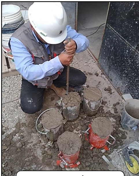
ELABORACIÓN DE TESTIGOS (PROBETAS)
