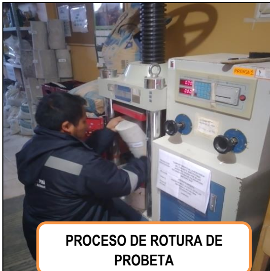
RESULTA DE ROTURA A LOS 28 DÍAS CE-083323 = 311.18 KN
