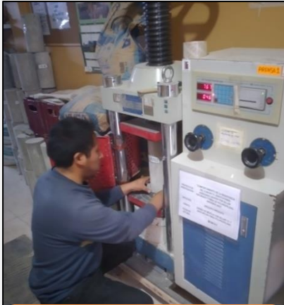
COLOCACIÓN DE PROBETA A LA PRENSA
