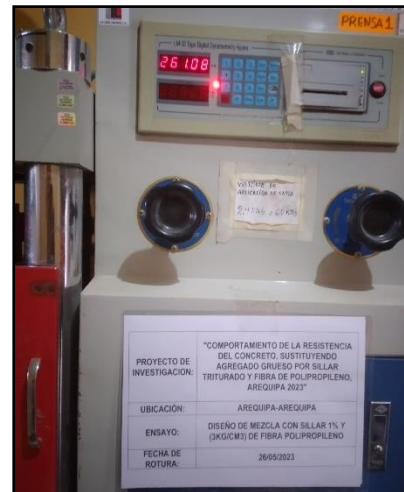
RESULTA DE ROTURA A LOS 7 DÍAS CE-031319 = 261.08 KN
