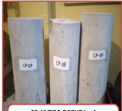
CP-07 TIPO ROTURA = 3 CP-08 TIPO ROTURA = 3 CP-09 TIPO ROTURA = 3
