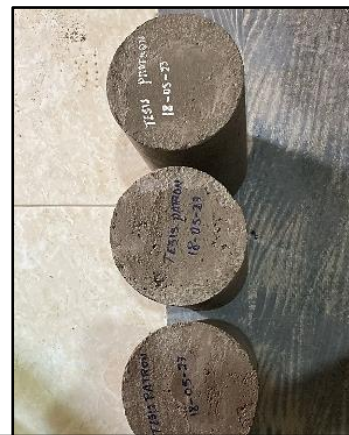
TOMA DE DATOS DE DIÁMETRO DE LAS PROBETAS ANTES DE LA ROTURA
