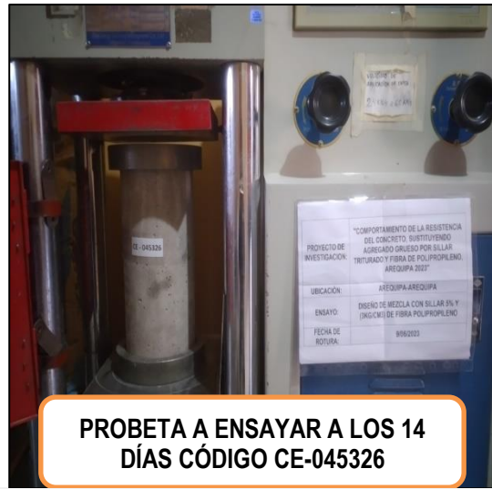
MUESTRA A ENSAYA A LOS 14 DÍAS DE CURADO- CONCRETO EXPERIMENTAL 5% SILLAR Y 3KG FIBRA PILPROPILENO
