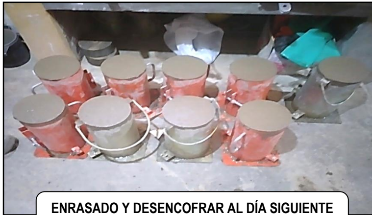
ELABORACIÓN DE TESTIGOS (PROBETAS)
