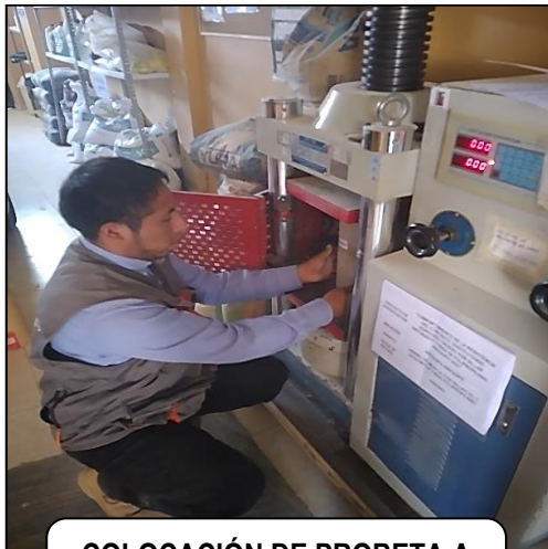
COLOCACIÓN DE PROBETA A LA MAQUINA DE COMPRESIÓN
