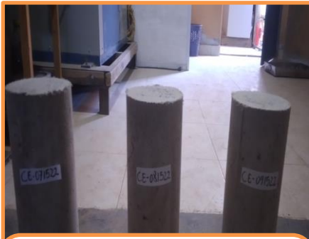
MUESTRA A ENSAYAR A LOS 28 DÍAS DE CURADO- CONCRETO EXPERIMENTAL 1% SILLAR Y 5KG FIBRA
