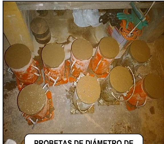
PROBETAS DE DIÁMETRO DE 150mm ALTURA 300mm
