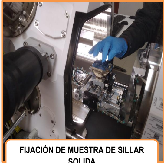
FIJACIÓN DE LA MUESTRA DE SILLAR MOLIDA
