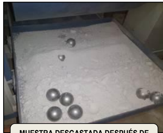
MUESTRA DESGASTADA DESPUÉS DE 500 REVOLUCIONES
