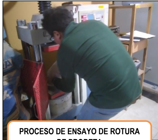
MUESTRA A ENSAYA A LOS 28 DÍAS DE CURADO- CONCRETO EXPERIMENTAL 5% SILLAR Y 3KG FIBRA POLIPROPILENO
