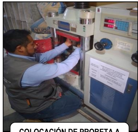
COLOCACIÓN DE PROBETA A LA MAQUINA DE COMPRESIÓN
