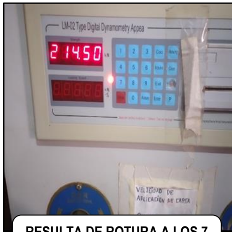
RESULTA DE ROTURA A LOS 7 DÍAS CE-011522 = 214.50 KN
