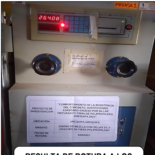
RESULTA DE ROTURA A LOS 14 DÍAS CE-043323 = 264.08 KN
