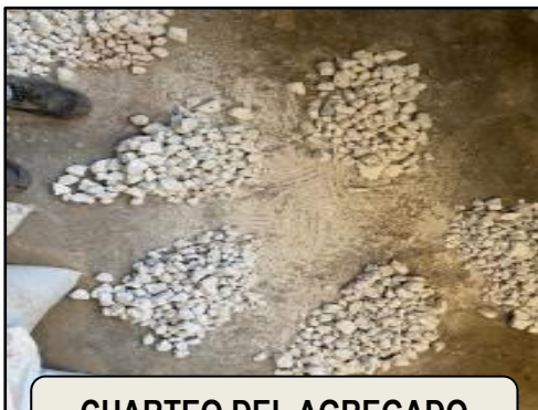
CUARTEO DEL AGREGADO
