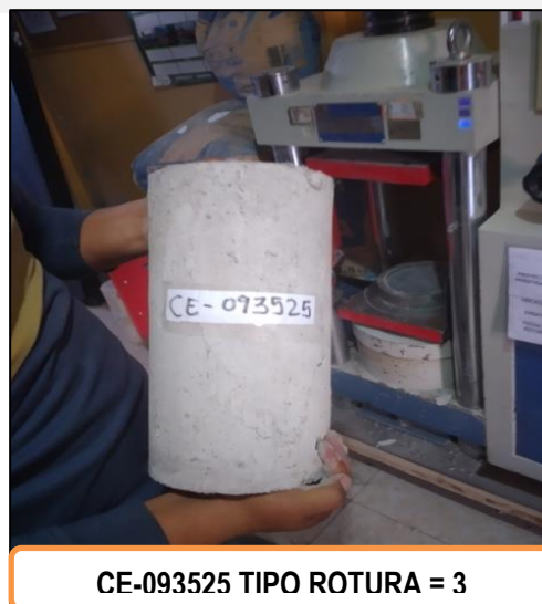
RESULTA DE ROTURA A LOS 28 DÍAS CE-093525 = 288.82 KN
