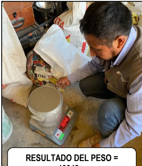
PROCESO DEL ENSAYO DE PESO UNITARIO - VARILLADO
