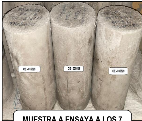
MUESTRA A ENSAYA A LOS 7 DÍAS DE CURADO
