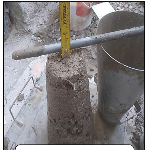
ASENTAMIENTO DEL CONCRETO (SLUMP) = 1/2"
