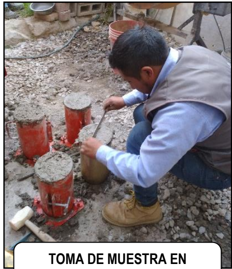
TOMA DE MUESTRA EN MOLDES (VARILLADO)
