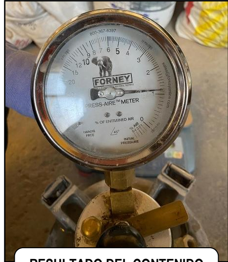
RESULTADO DEL CONTENIDO DE AIRE = 1.1%
