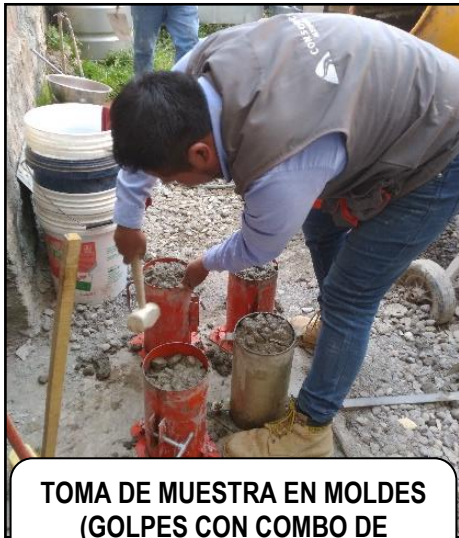
TOMA DE MUESTRA EN MOLDES
