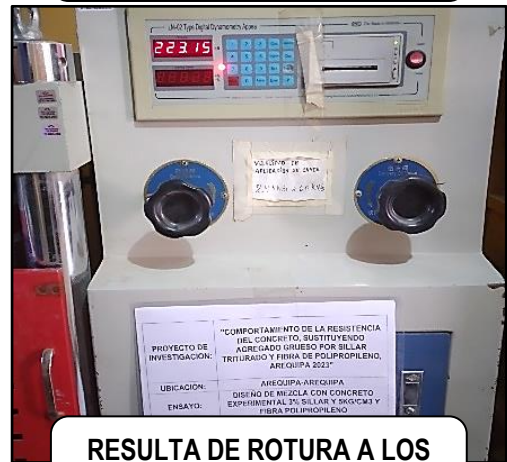
RESULTA DE ROTURA A LOS 7DIAS CE-023525 = 220.14 KN
