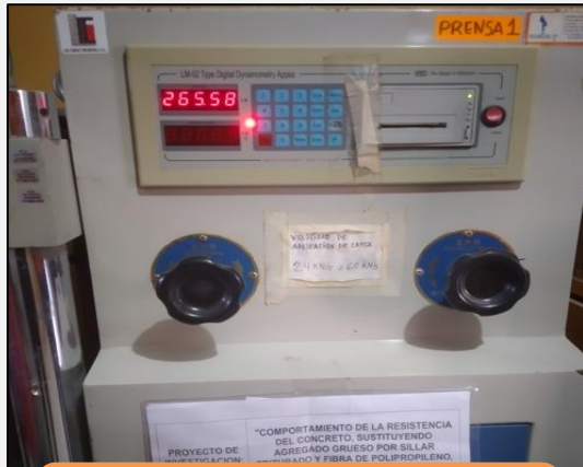
RESULTA DE ROTURA A LOS 14 DÍAS CE-045326 = 265.58 KN
