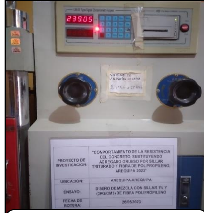
RESULTA DE ROTURA A LOS 7 DÍAS CE-011319 = 239.05 KN
