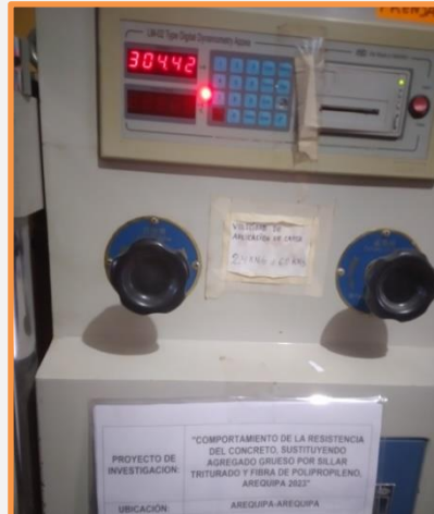
RESULTADO DE ROTURA A LOS 28 DIAS CE-071522 = 304.42 KN
