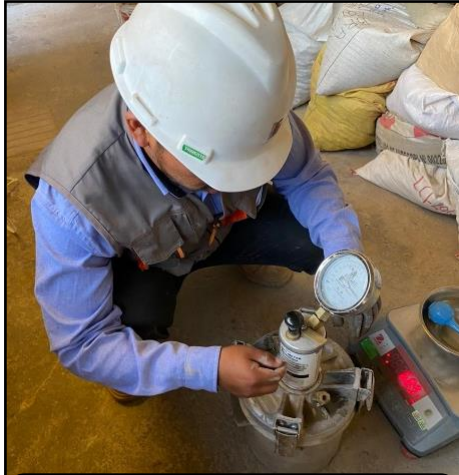
AJUSTE DE MANÓMETRO EN LA LÍNEA DE PRECISIÓN INICIAL
