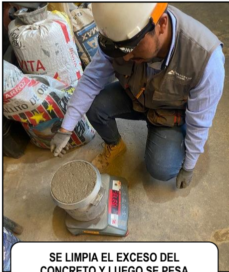
ENSAYO DE PESO UNITARIO Y CONTENIDO DE VACÍOS DEL CONCRETO
