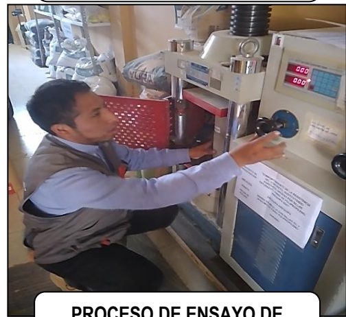
PROCESO DE ENSAYO DE COMPRESIÓN DE PROBETA
