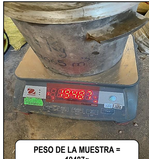
ENSAYO DE PESO UNITARIO - 3 CAPAS, 25 VARILLAS Y GOLPEADO 15 VECES ALREDEDOR DE LA OLLA
