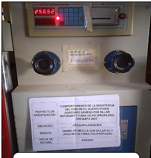
RESULTA DE ROTURA A LOS 14 DÍAS CE-063323 = 256.52 KN
