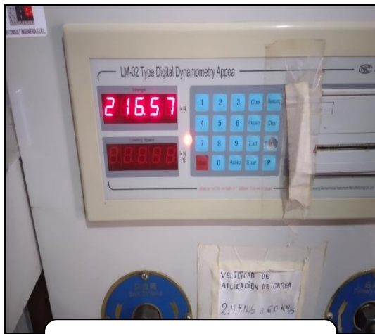
RESULTA DE ROTURA A LOS 7DIAS CP-01 = 216.57 KN
