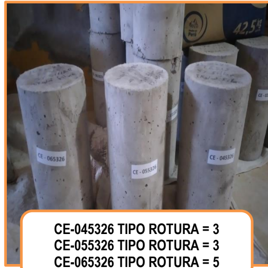
RESULTA DE ROTURA A LOS 14 DÍAS CE-065326 = 252.91 KN
