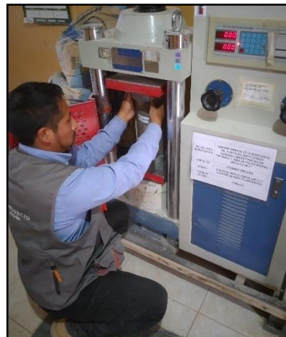
COLOCACIÓN DE PROBETA A LA MAQUINA DE COMPRESIÓN
