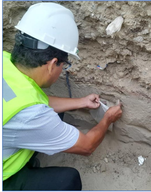
Fotografía # 05. Se recogieron muestras de suelo, para determinar el nivel de vulnerabilidad sísmica de la zona de estudio.
