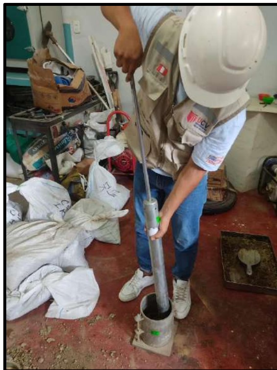
Figura 8. Ensayos de laboratorio, utilizando equipo para hallar Proctor Modificado.
