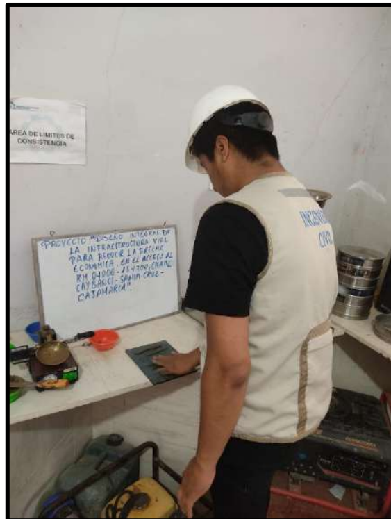
Figura 6. Ensayos de laboratorio para hallar limite plástico.
