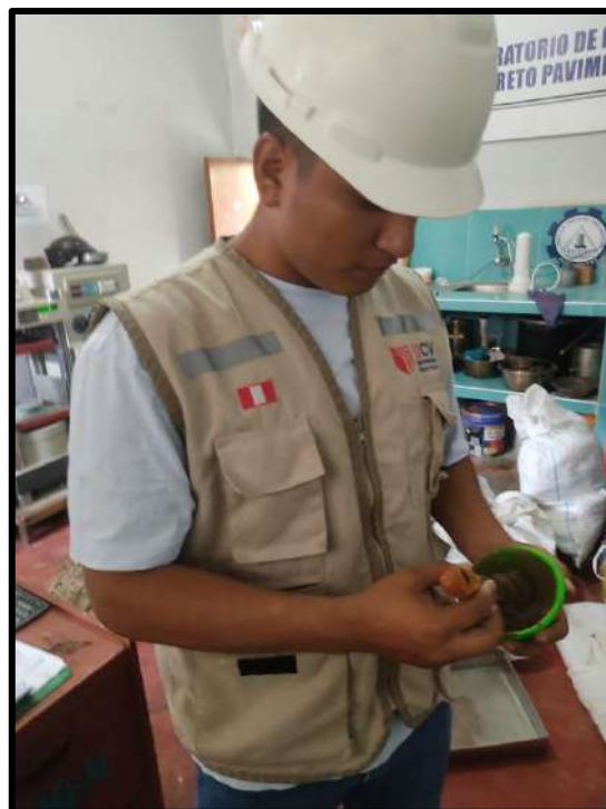
Figura 4. Ensayos de laboratorio utilizando Casagrande para hallar limite líquido.
