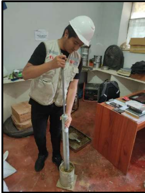
Figura 9. Ensayos de laboratorio, utilizando equipo para hallar Proctor Modificado.
