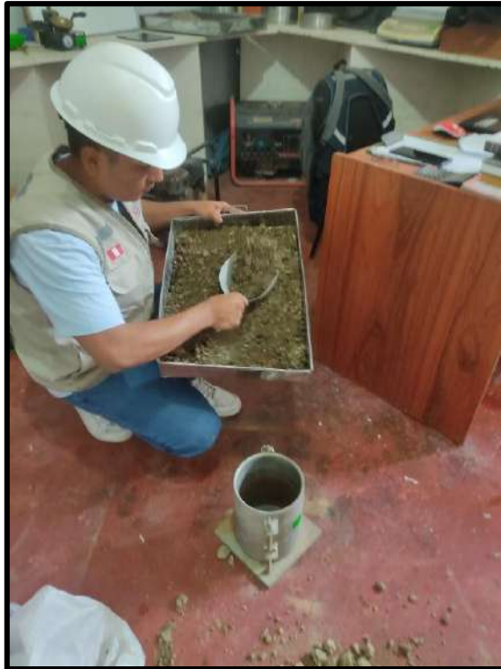
Figura 7. Ensayos de laboratorio, utilizando equipo para hallar Proctor Modificado.
