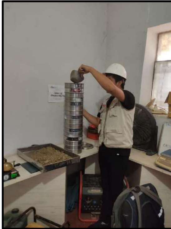
Figura 3. Ensayos de laboratorio utilizando el tamiz para la clasificación de suelos.
