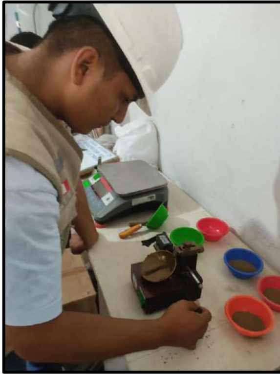
Figura 5. Ensayos de laboratorio utilizando Casagrande para hallar limite líquido.
