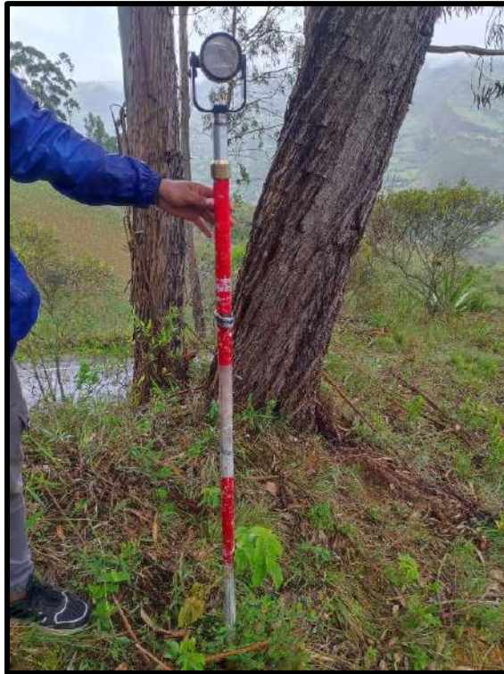
Figura 3. Ubicación de prisma para posicionar estación.
