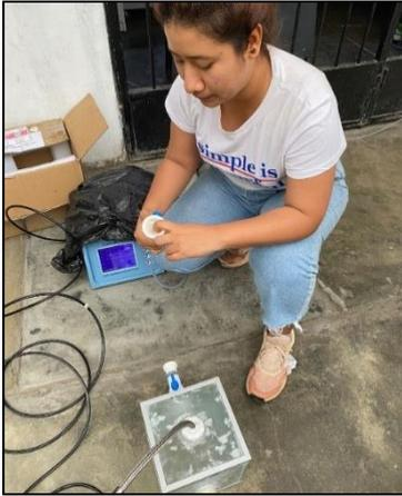
Figura 30. Cambio de membranas
