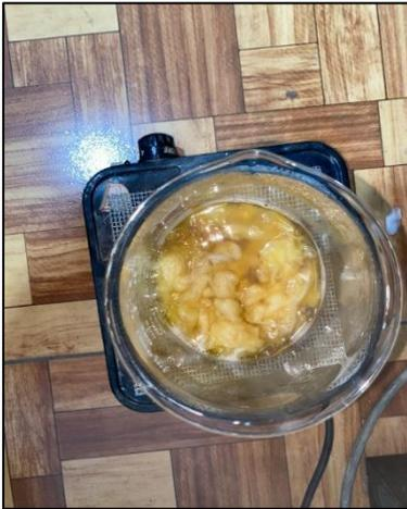
Figura 10. Deslignificación
