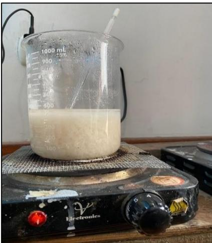
Figura 13. Formación de nanocelulosa
