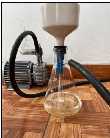
Figura 14. Filtrado al vacío
