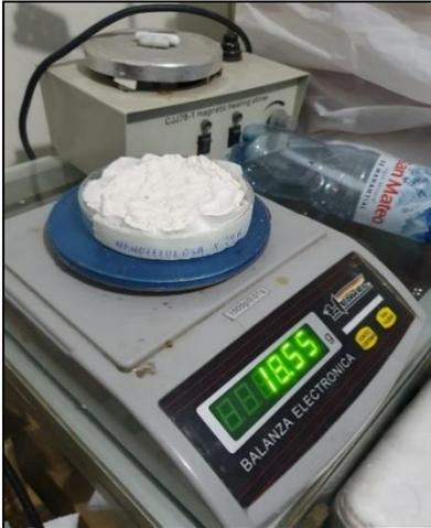
Figura 20. Pesaje de nanocelulosa
