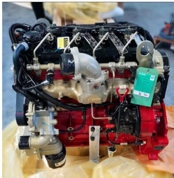
Figura 1. Motor Cummins aplicable para minibús Fotón (Cummins, 2023)
