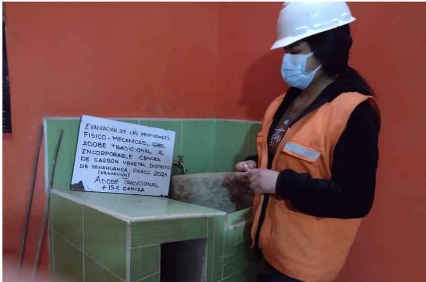
Muestra para el ensayo de absorción del adobe tradicional con adición del 15% de ceniza de carbón vegetal
