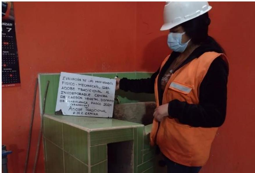
Muestra para el ensayo de absorción del adobe tradicional con adición del 10% de ceniza de carbón vegetal
