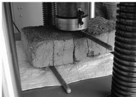
**Figura N° 12:** Ensayo de flexión
