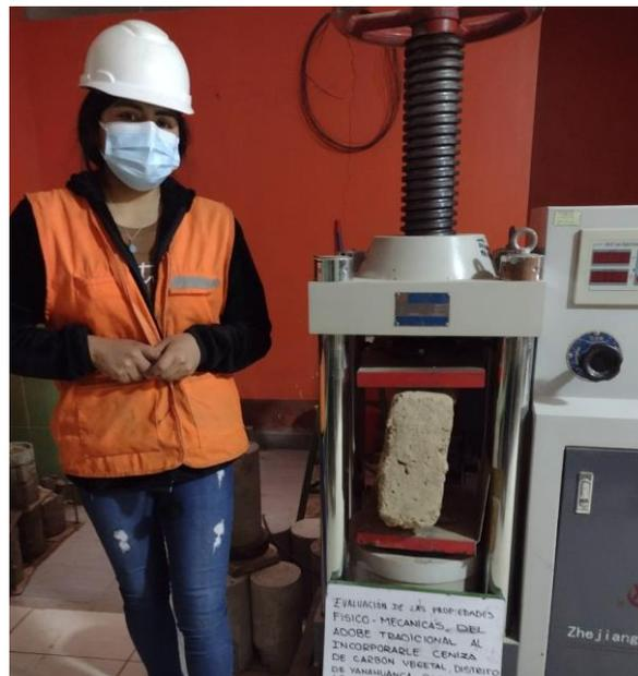
Muestra para el ensayo de resistencia a la flexión
