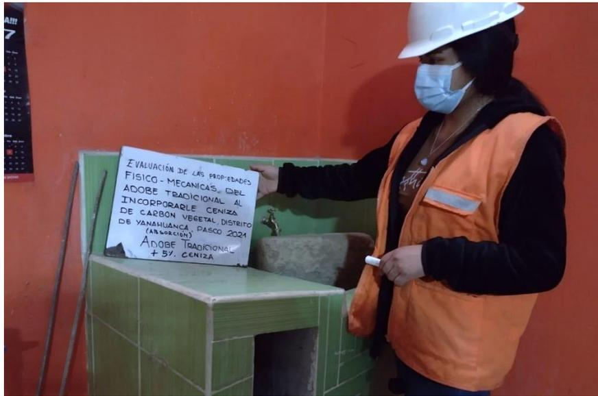
Muestra para el ensayo de absorción del adobe tradicional con adición del 5% de ceniza de carbón vegetal
