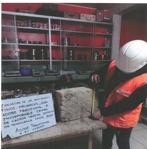
**Figura N° 11:** Medición de la muestra para La posterior rotura
