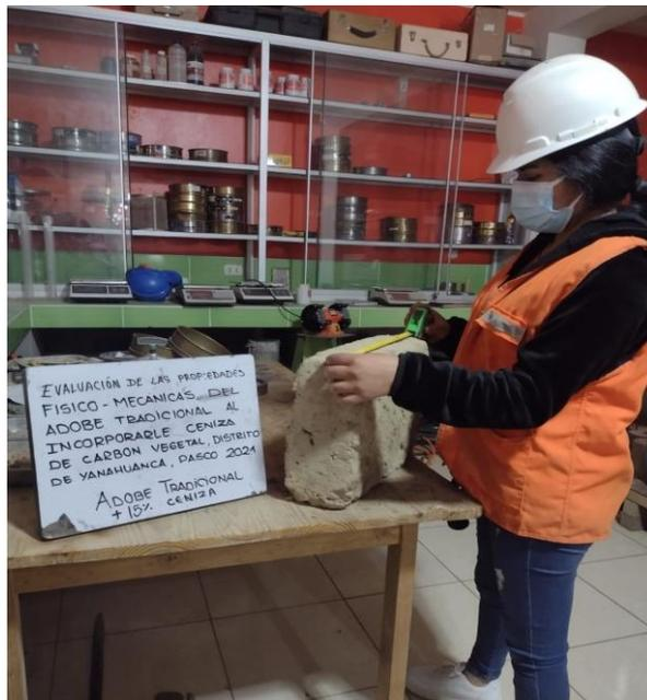
Corroborando las medidas para la posterior rotura
