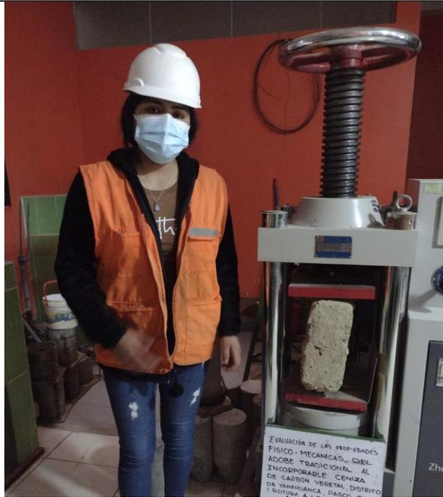
Muestra para el ensayo de resistencia a la compresión
