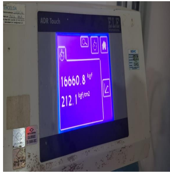
Resultado de prueba rotura
