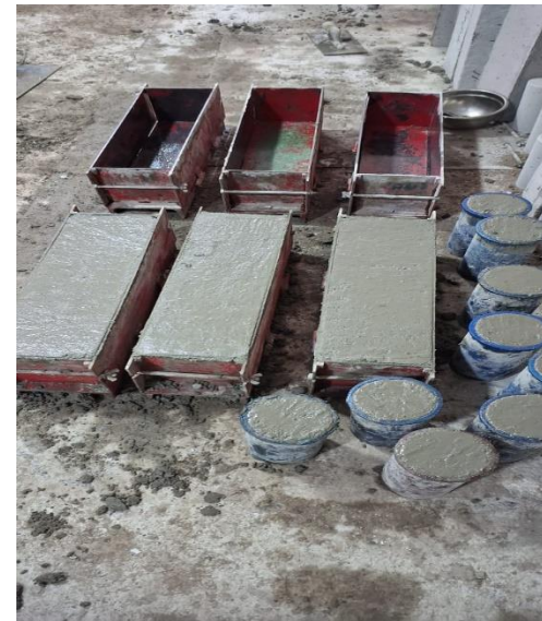
Vaciado de probetas y vigas
