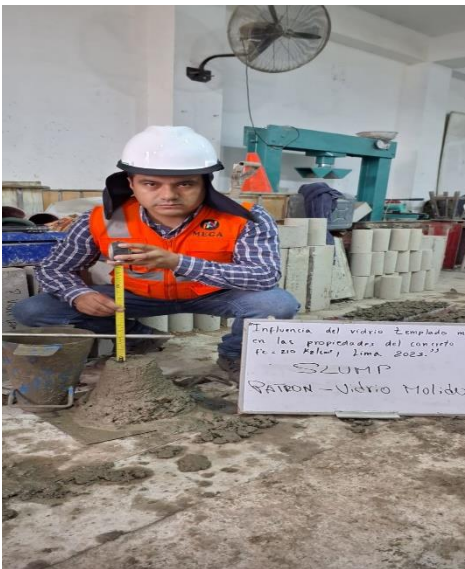
Prueba del slump
