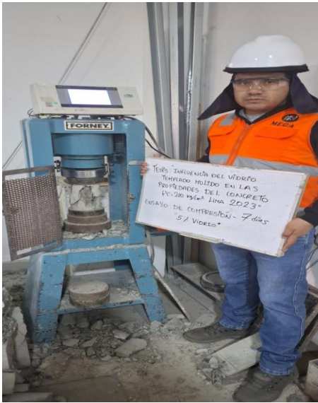
Figura 10: Prueba de rotura 7 días 5% Fuente: Desarrollo propio.
